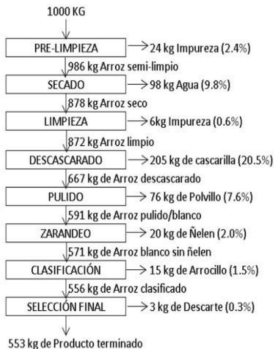
Figura 25: Balance de materia para la producción de arroz pilado (Elaboracion propia)
