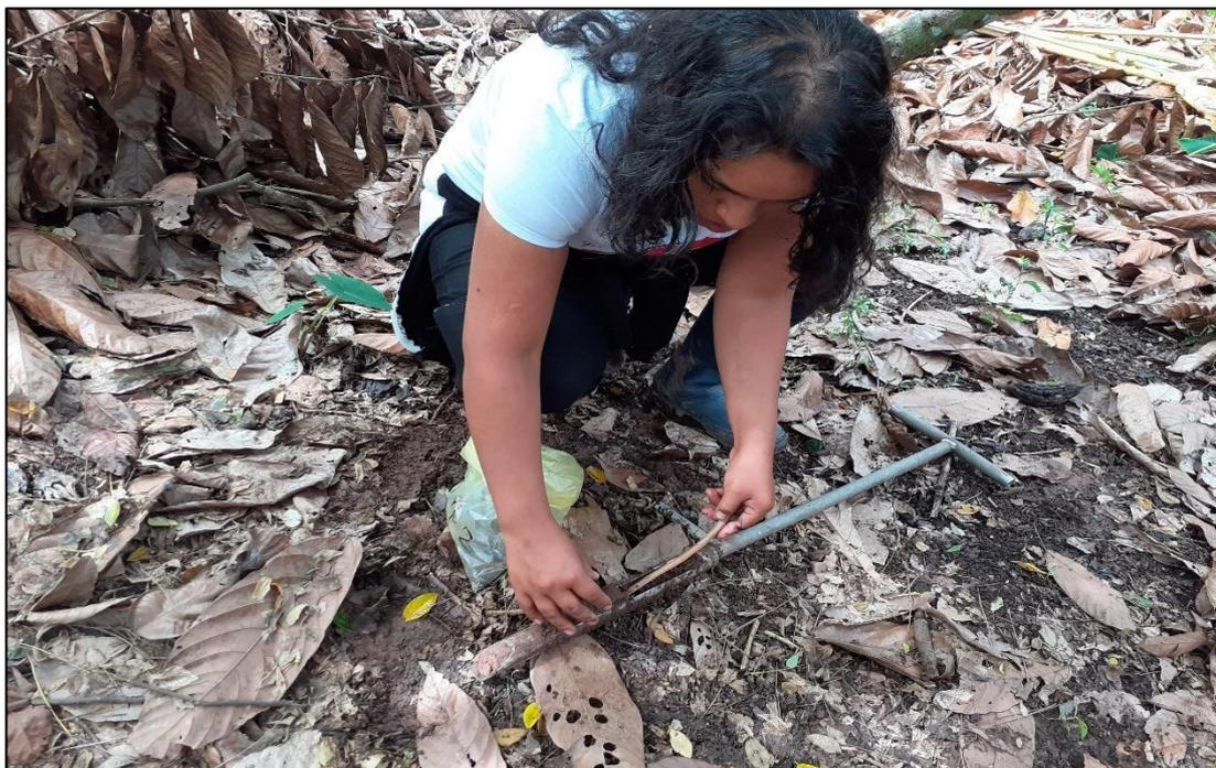
**Figura 10.** Muestreo de suelo con barreno y recojo de la muestra de suelo.
