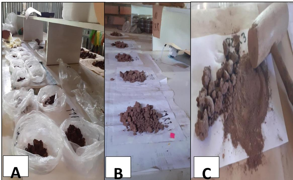
**Figura 12.** Muestras de suelo (a), secado del suelo (b), triturado del suelo (c).
