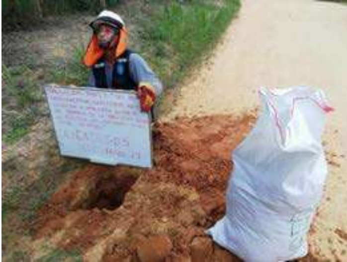
Fotografía 4. – extracción de material en sacos con su respectivo código para cada calicata y progresiva (punto de exploración).
