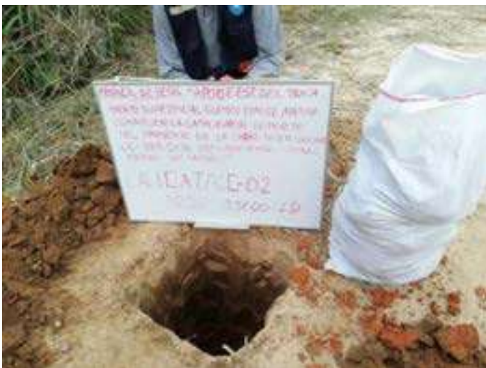
Fotografía 6. – extracción de material en sacos con su respectivo código para cada calicata y progresiva (punto de exploración).
