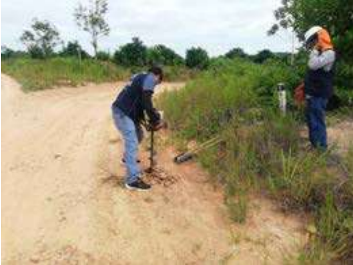
Fotografía 1. – perforación de la calicata en el hito Final de la vía al lado derecho.
