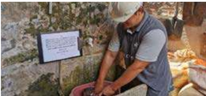
Fotografía 11. – Se puede apreciar el lavado del material para su posterior secado en el horno.
