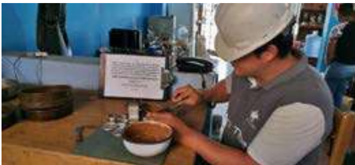
Fotografía 15. – se puede observar la incorporación del agua al suelo tamizado y la elaboración de la mezcla homogénea.
