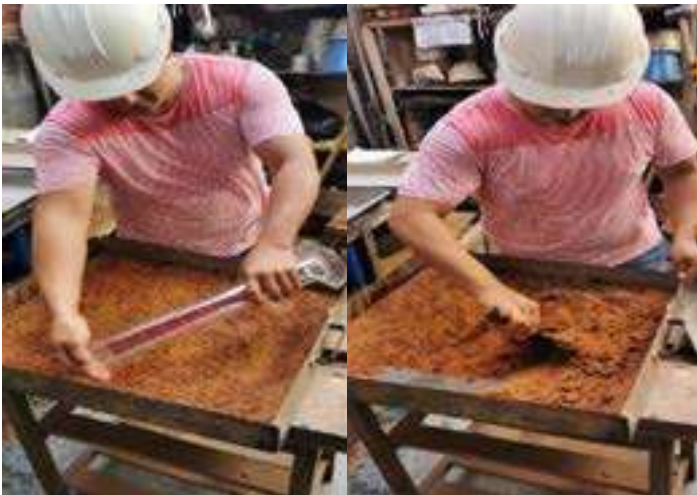
Fotografía 22. – incorporación del agua para calcular el contenido de humedad óptimo en el ensayo .
