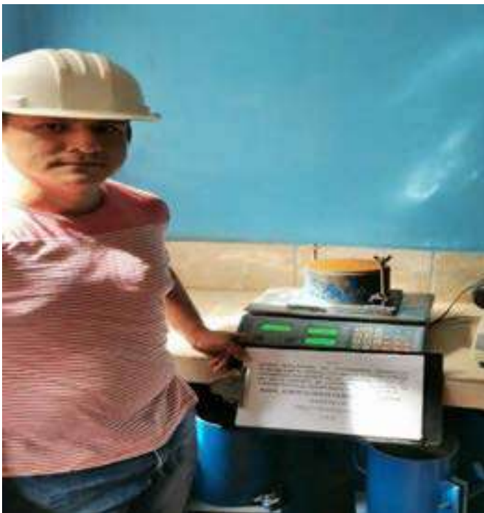
Fotografía 25. – pesado del molde con material compactado.
