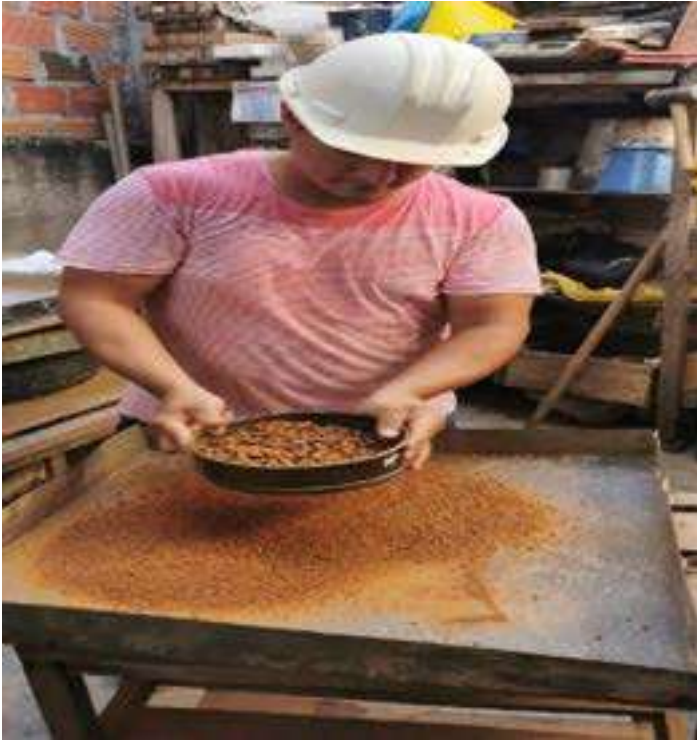
Fotografía 21. – tamizado del material para el ensayo de Proctor modificado.
