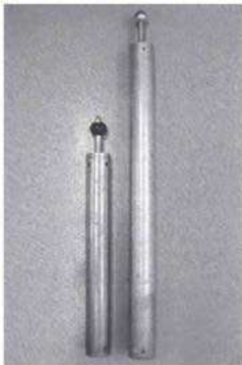
Figura 16: Comparación de los martillos para las pruebas proctor estándar hacia la izquierda y proctor modificado hacia la derecha
