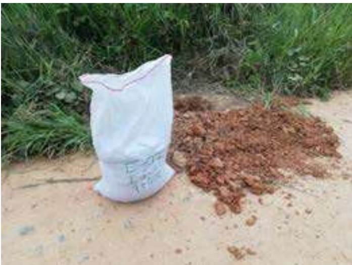
Fotografía 3. – extracción de material en sacos con su respectivo código para cada calicata y progresiva (punto de exploración).
