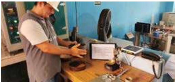
Fotografía 14. – en la siguiente imagen puede apreciar el tamizado en las respectivas mallas para el ensayo de límite líquido.
