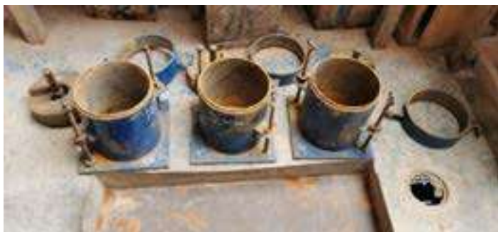
Fotografía 26. – limpieza de moldes para el desarrollo del ensayo de California Bearing Ratio (CBR).
