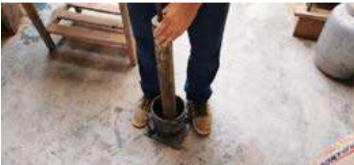
Fotografía 23. – instrumento de compactación para el ensayo de Proctor modificado.
