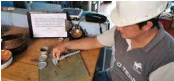
Fotografía 18. – medición de los bastones fracturados.
