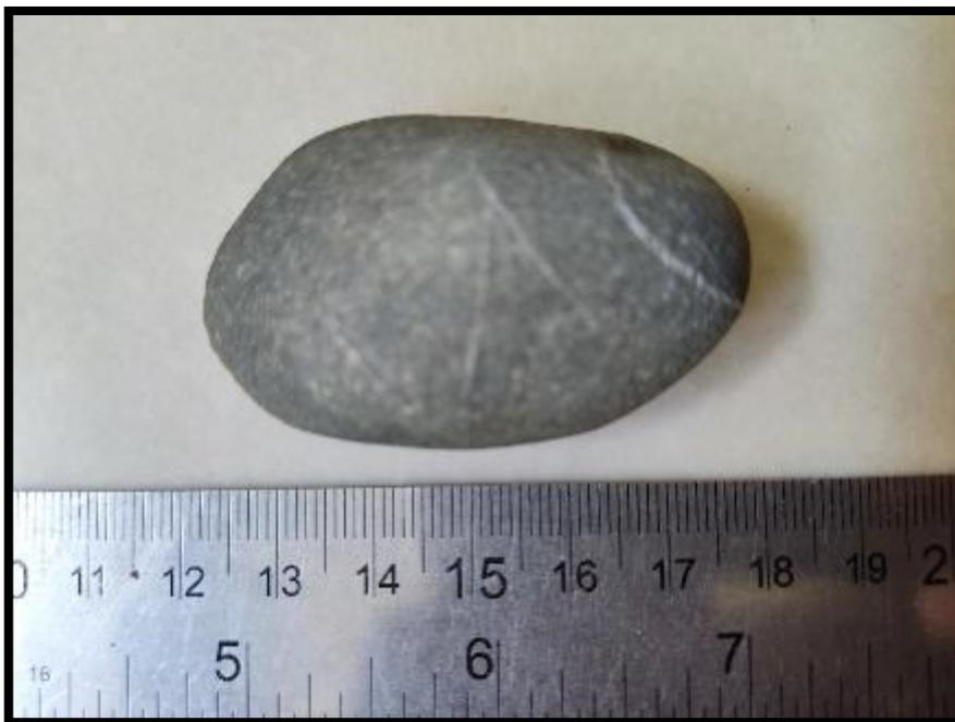
En el software AutoCAD Civil 3D 2020, se determinaron las dimensiones requeridas para el cálculo de esfericidad, para ello se dibujó el contorno de la sección de la partícula y el círculo circunscrito en ella, ver Imagen 4.
