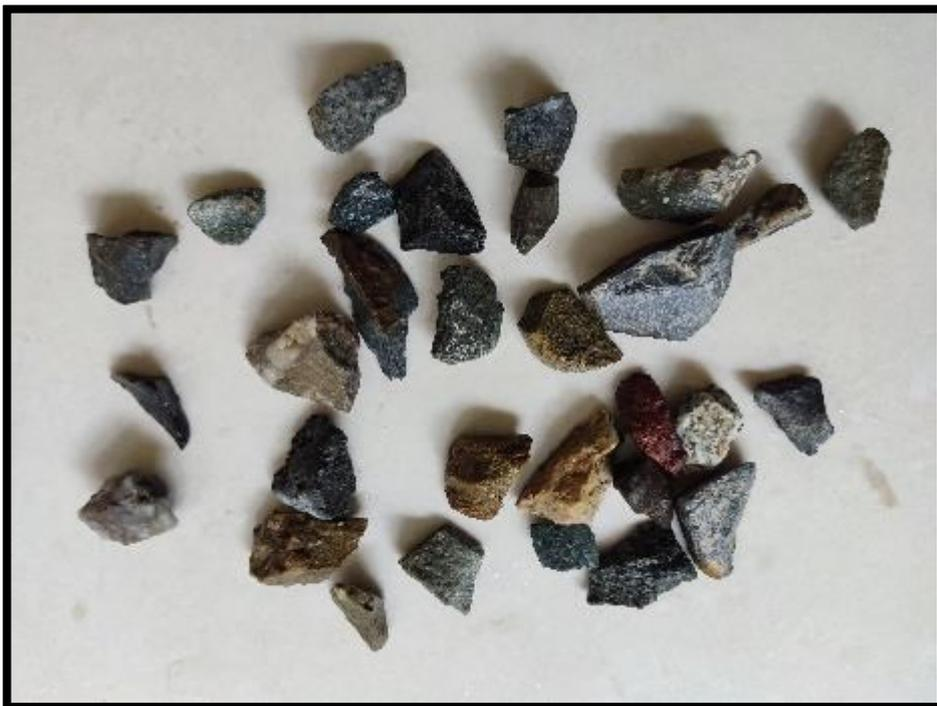
A continuación, se fotografiaron las partículas de forma independiente en dos planos perpendiculares incluyendo una regla metálica para el patrón de escala como se muestra en la Imagen 3, las 120 fotografías fueron exportadas al software AutoCAD Civil 3D 2020 con la finalidad de determinar las dimensiones de los granos, necesarias para el cálculo de los factores de esfericidad y redondez de los 2 tipos de agregado grueso.
