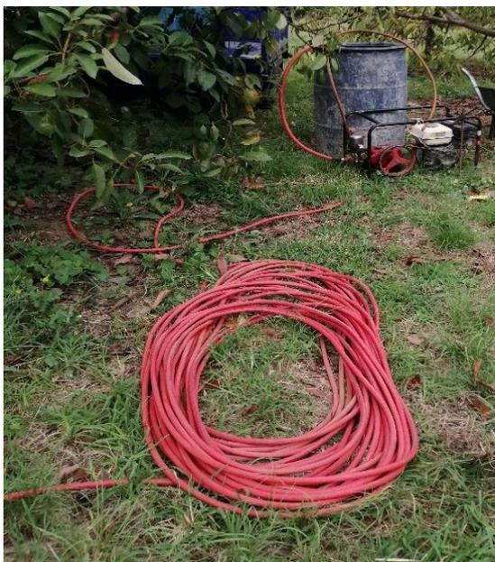
**Figura N° 31:** fumigadora estacionaria
