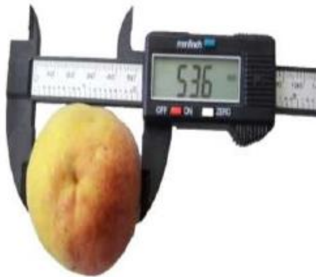
Figura 11. Medición del diámetro ecuatorial
