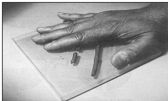
*Nota.* Dichas pruebas se elaboran conforme al ASTM D-4318. Selección de imagen de *Fundamentos de Ingeniería Geotécnica* (p. 29), de Das, 1999.
