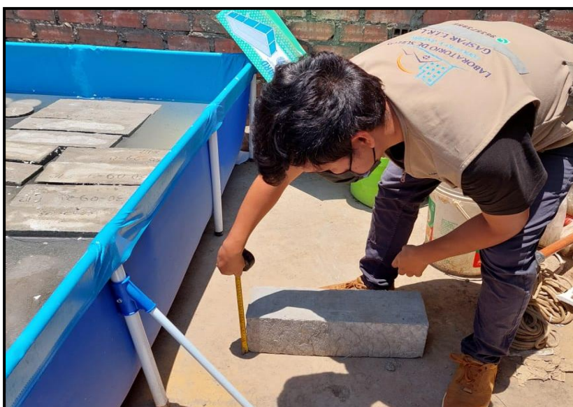
Figura 27 Medidas de las vigas a ensayar
