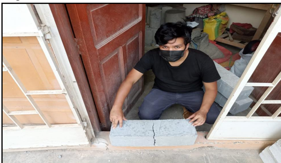
Figura 38 Identificación de la falla a flexión
