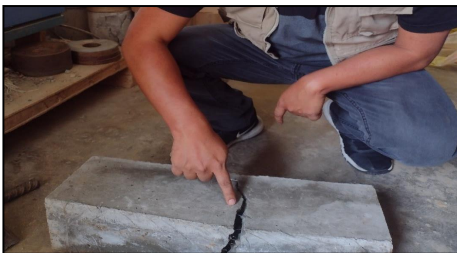
Figura 38 Identificación de la falla a flexión
