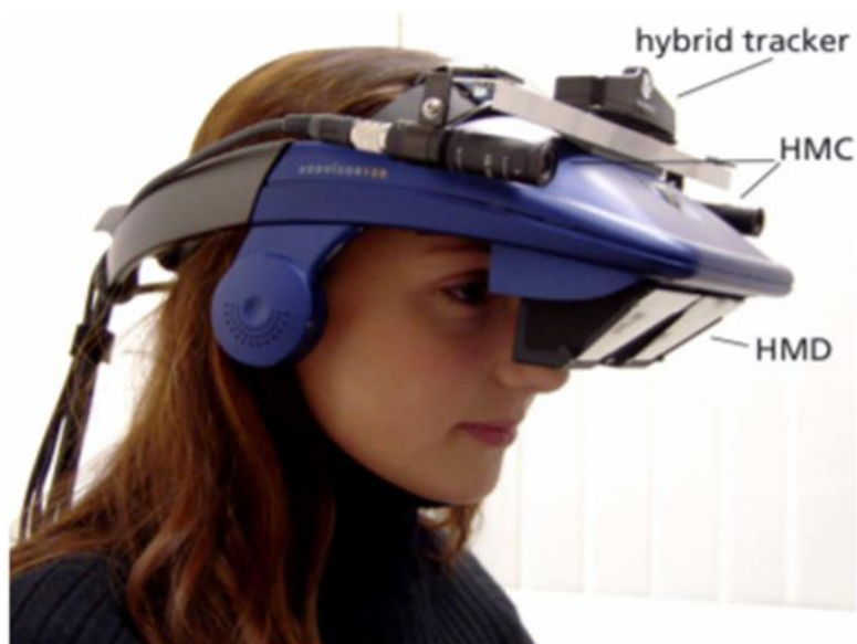
Figura 9 Pantalla ARTHUR Transparente Montada en la Cabeza.
