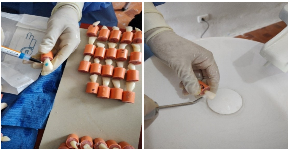
FIGURA 06: Colocamos acido grabador al 37% por 20segundos a las muestras y lavado por 20segundos.
