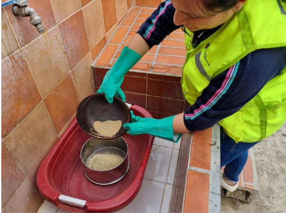
*Fotografía 11. Lavado de material, para realizar el secado y tamizado.*
