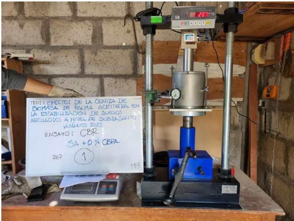
Fotografía 32. Ensayo de moldes en la prensa-Tratamiento 1
