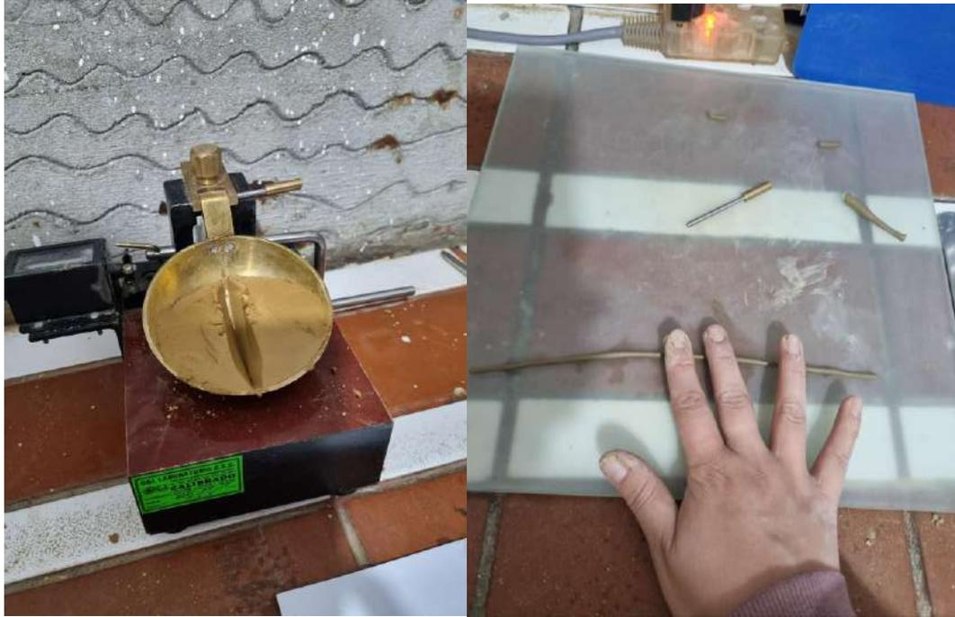
*Fotografía 13. Ensayos para determinar los límites de Atterberg*
