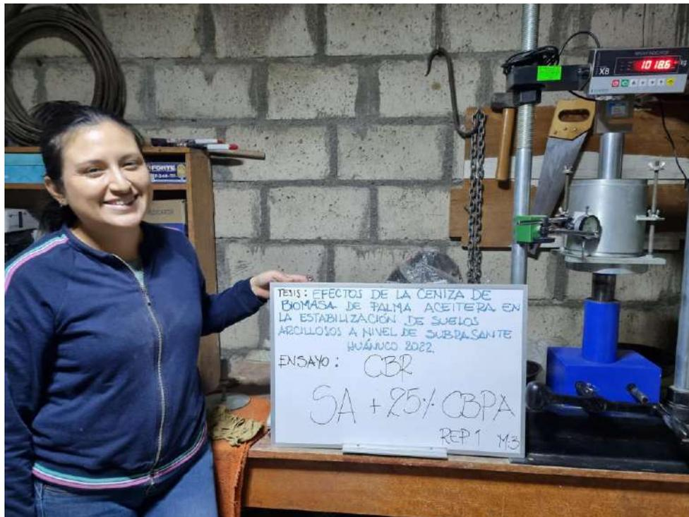
*Fotografía 35. Ensayo de moldes en la prensa-Tratamiento 4*
