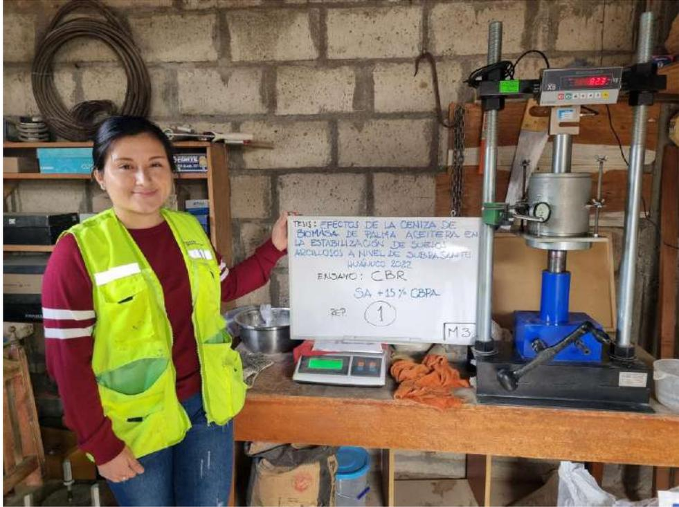
Fotografía 33. Ensayo de moldes en la prensa-Tratamiento 2
