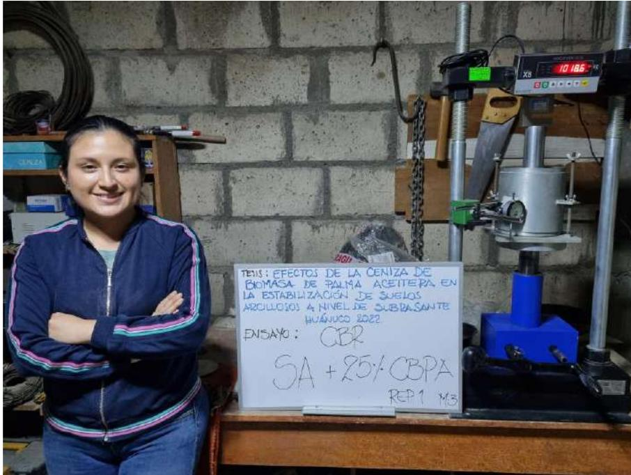
*Nota.* Luego de los 4 días se realiza el ensayo correspondiente en la prensa, en la fotografía el mejor resultado obtenido para tratamiento de 25%. Fuente: Propia
