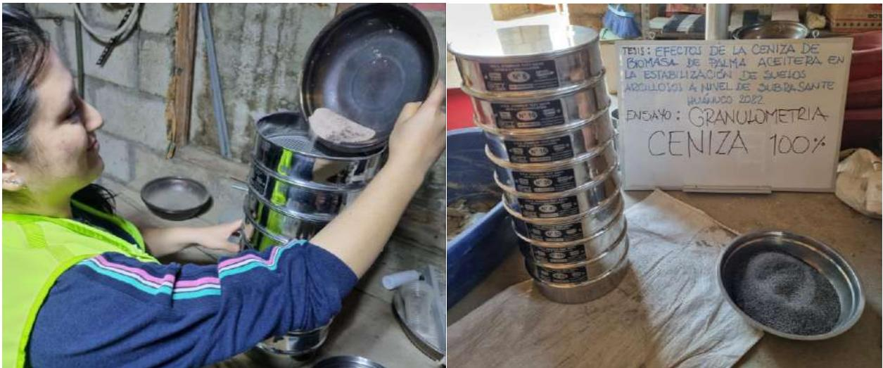
Nota. En la izquierda se observa el ensayo a una muestra con tratamiento y en la izquierda los tamices utilizados para el ensayo correspondiente a la CBPA. Fuente: Propia.
