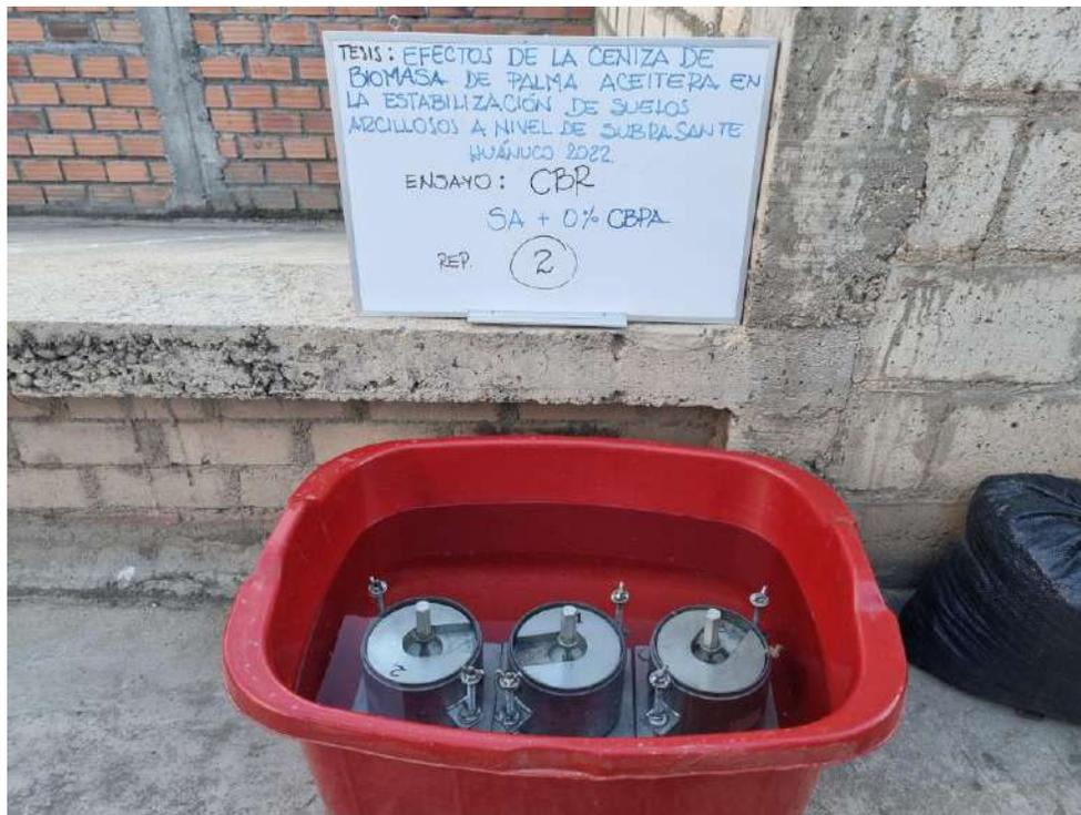
*Fotografía 28. Moldes durante el proceso de saturación de muestras-Tratamiento 1*
