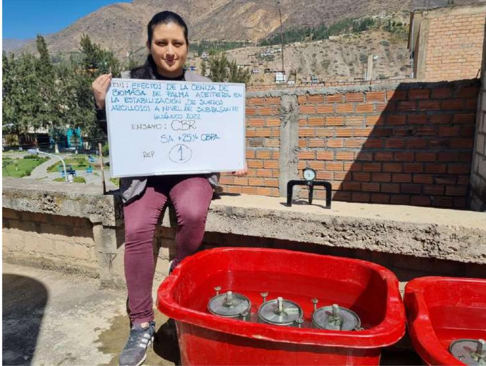
Fotografía 31. Moldes durante el proceso de saturación de muestras-Tratamiento 4
