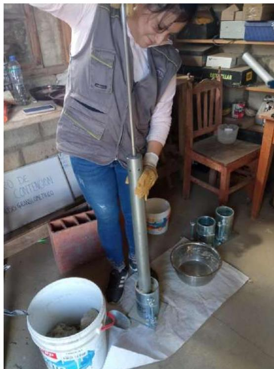
*Fotografía 18. Preparación de moldes para el ensayo Proctor Modificado*
