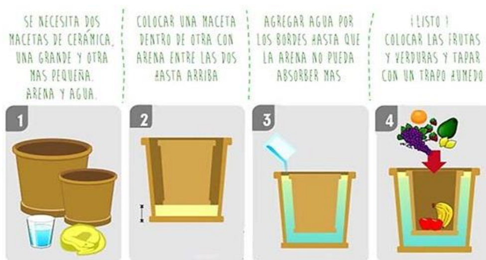
Figura 11. Detalle constructivo de una nevera ecologica
