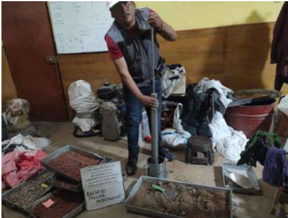
Foto 9 Ensayo de Proctor modificado a las pruebas de control
