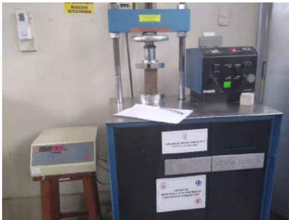
Foto 10 Ensayo de resistencia a la compresión simple – Calicata 01 – 0% de adición
