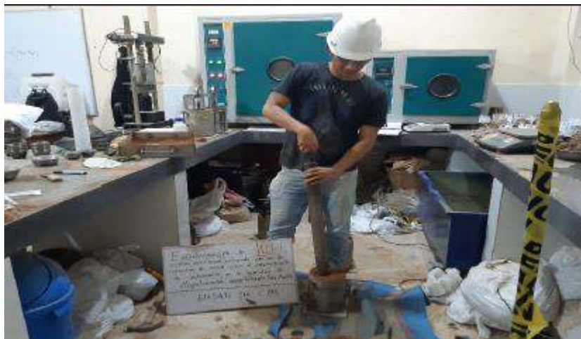
Foto 8 Ensayo de CBR – Calicata 03
