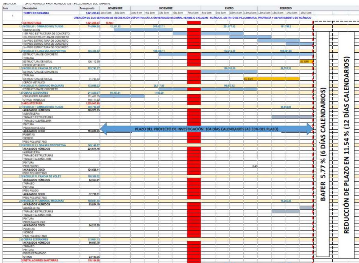
Gráfico 20: Planeamiento aprobado con reducción de plazo de ejecución de la obra para el estudio. Extraído de anexo D.1.2
