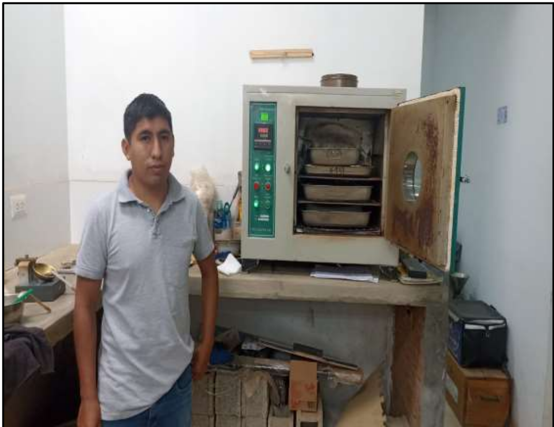
FOTOGRAFÍA N°10. Se muestra la cocción de las muestras de tierra para el ensayo de densidad de suelo.
