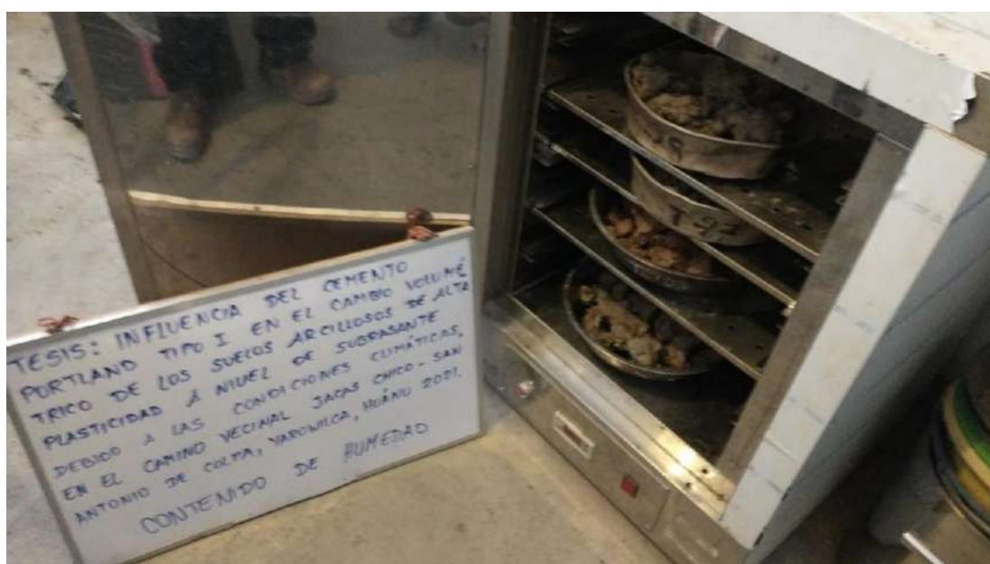
Figura 31. Se introduce las muestras al horno para obtener los resultados del contenido de humedad.
