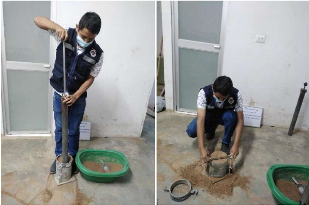
Compactación y enrasado.
