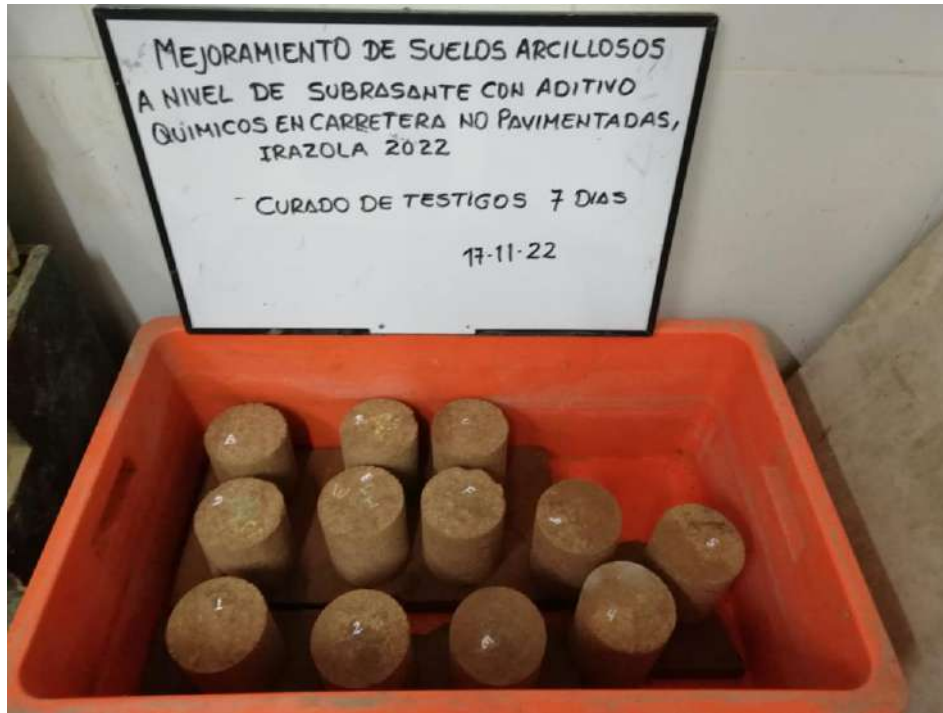
Curado de testigo con aditivo liquido Proes y Terrasil con adición de cemento.
