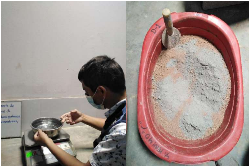
Dosificación de los aditivos químicos y del cemento.
