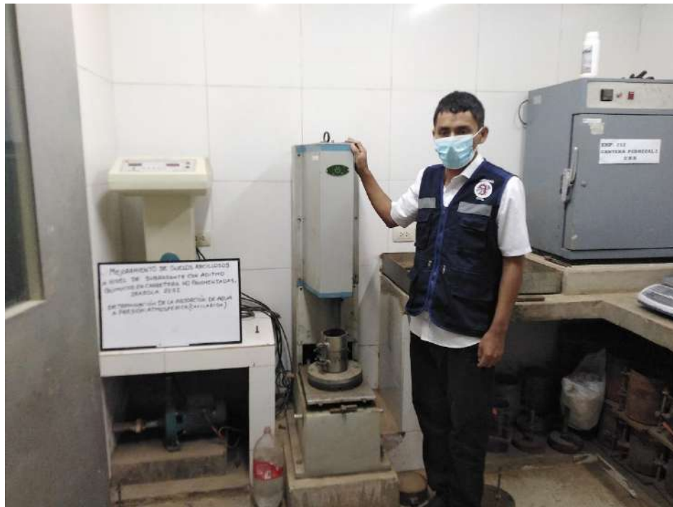
Elaboración de probetas para el ensayo de capilaridad
