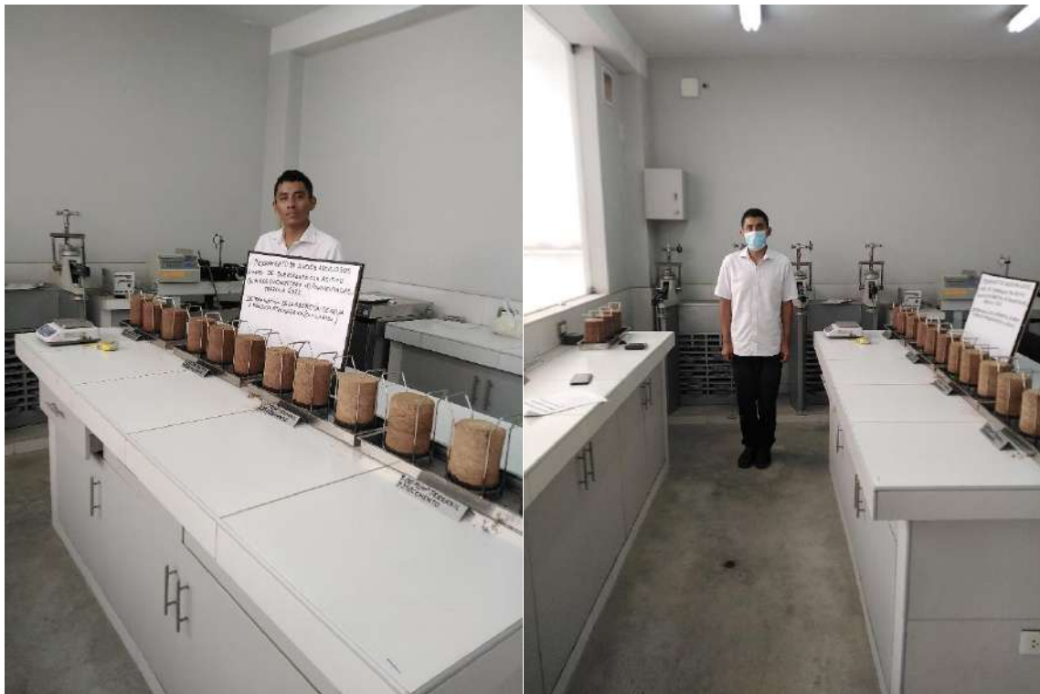
Ensayo de ascensión y absorción capilar.
