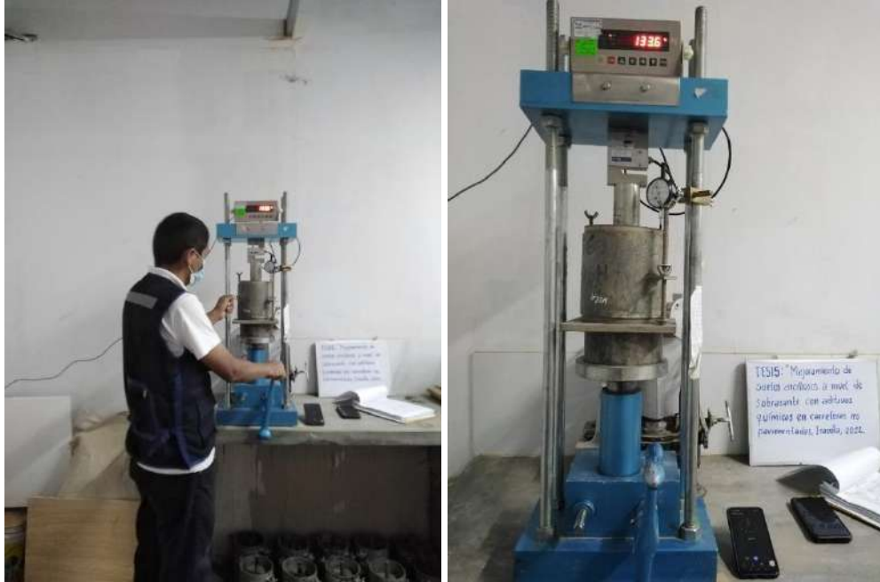
Ensayo de resistencia a la penetración de la muestra.
