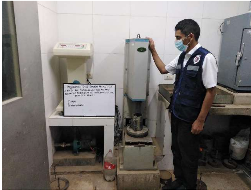
Equipo de compactación.
