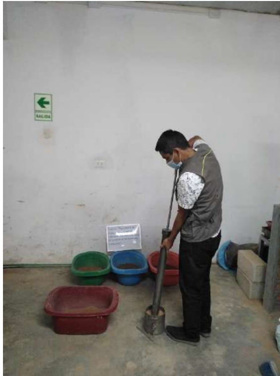
Figura 12: Ensayo de Proctor Modificado
