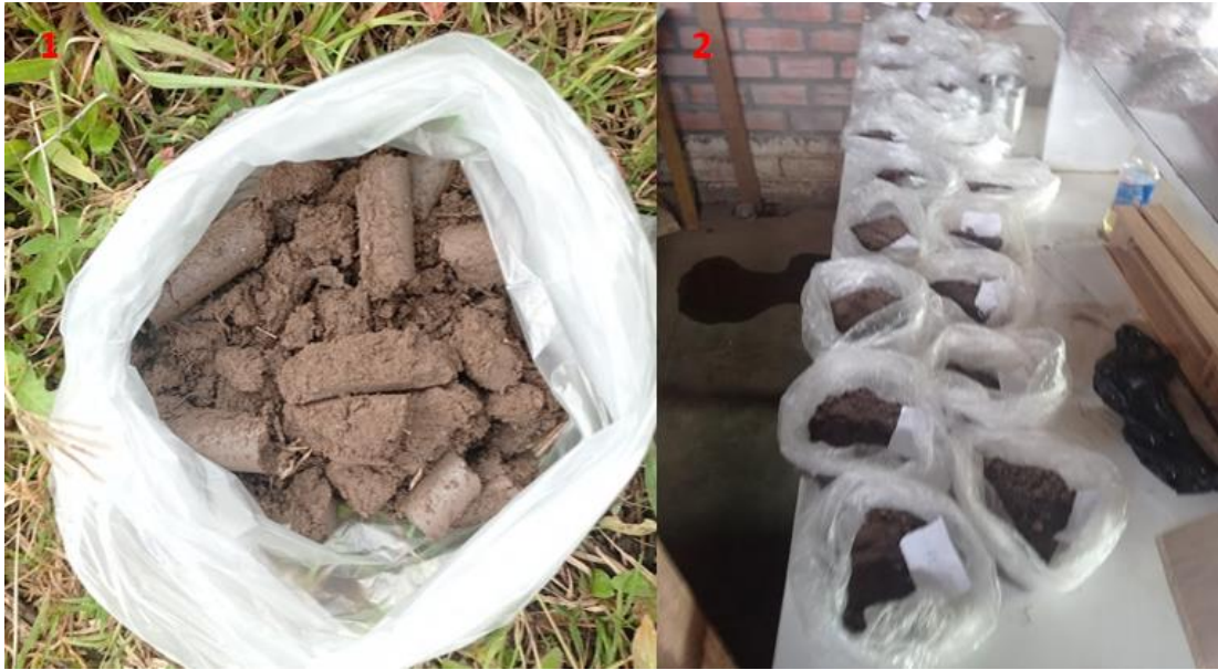
Figura 10. Submuestra extraída del suelo de 0-20 cm de profundidad (1), submuestras de suelo secando bajo sombra (2).
