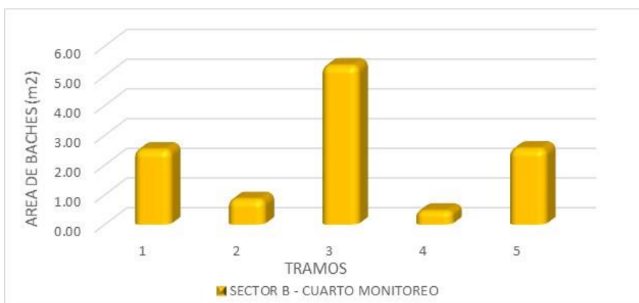
Figura 43 Deterioro superficial (baches) – Sector con enzima pz-22x
