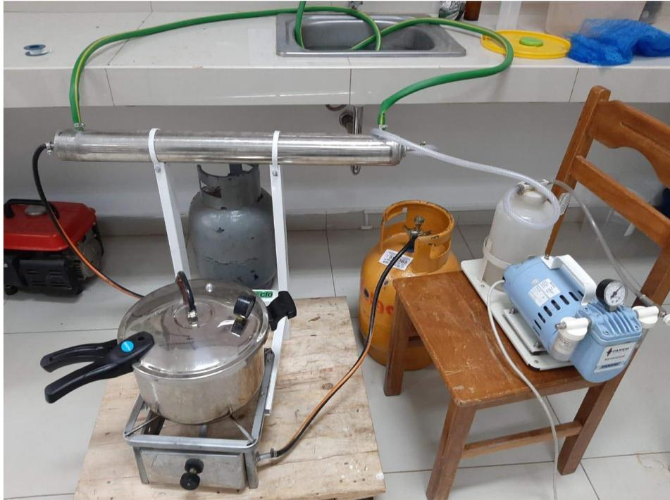
*Imagen 5. Freidora de vacío*
