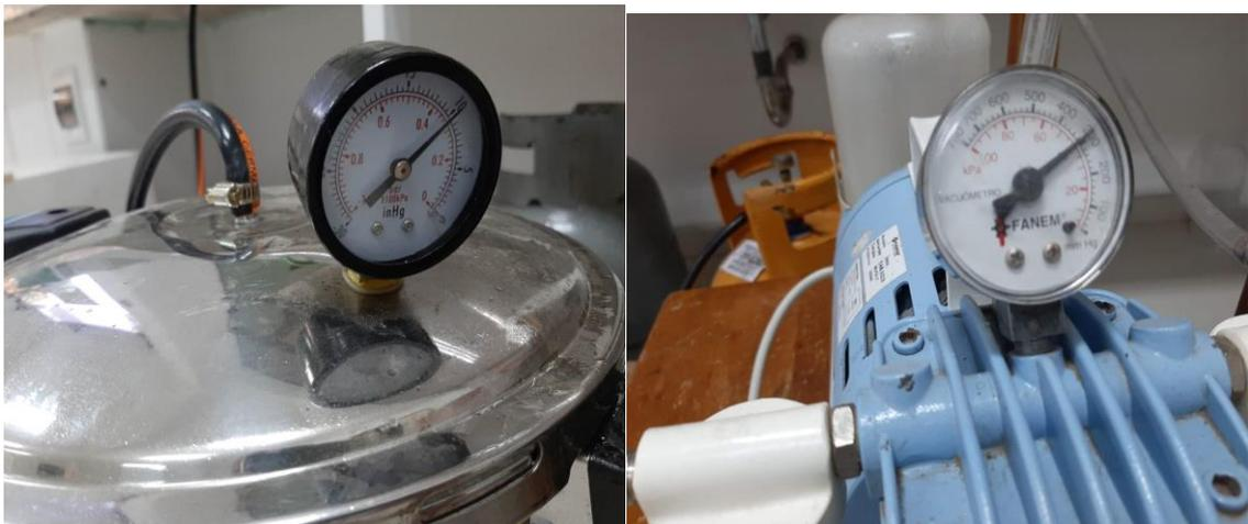
*Imagen 5. Vacuometro de la freidora de vacío*
