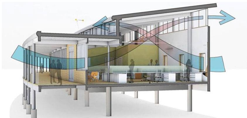
*Nota.* Se muestran un diagrama de la ventilación cruzada en una edificación.
