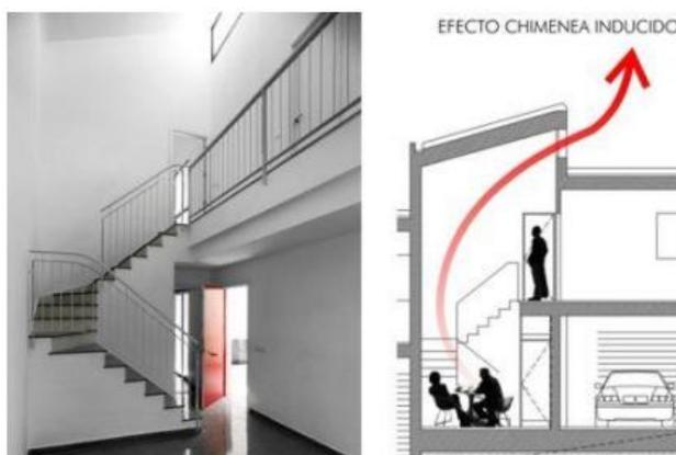
*Nota.* Imagen donde se ve la función de la ventilación de tipo efecto chimenea
