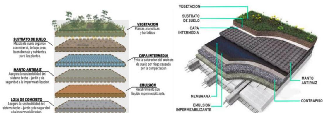
*Nota:* Materiales que se usan para la creación de techo verde, fuente: datos usados de internet.
