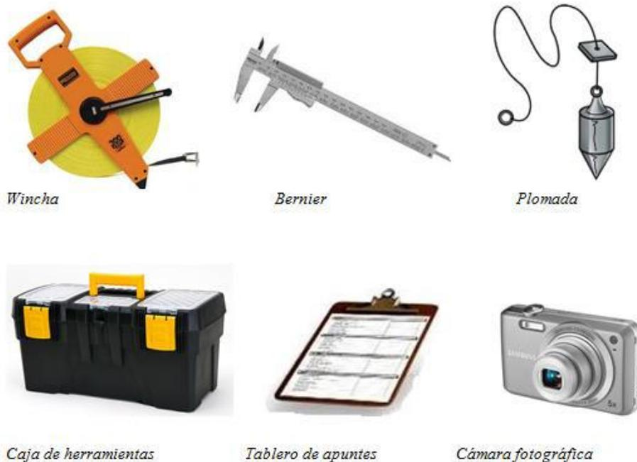
Nota. En la imagen se muestra las herramientas básicas que se necesita para realizar la inspección del puente. Tomado del *Guía para la inspección de puentes* (2019, p. 35), del MTC.
