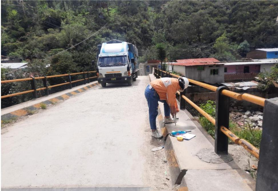
SE REALIZARON ENSAYOS DE ESCLEROMETRIA PARA ESTIMAR LA RESISTENCIA DEL CONCRETO SIGUIENDO LOS PRECEDIMIENTOS ESTABLECIDOS EN EL ASTM C805. SE TOMARON MUESTRAS EN LOS DIFERENTES ELEMENTOS DE LA SUPERESTRUCTURA DEL PUENTE, EN LA FOTOGRAFIA SE MUESTRA LOS PUNTOS EN LA VEREDA DE PUENTE.
