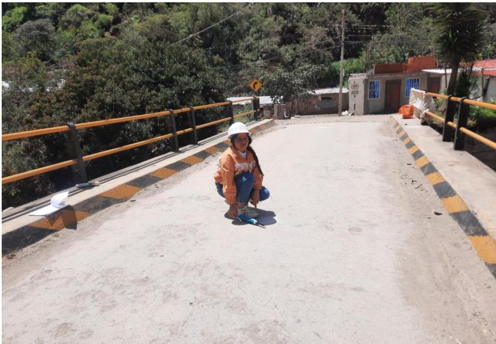
SE REALIZO ENSAYOS DE ESCLEROMETRÍA PARA ESTIMAR LA RESISTENCIA DEL CONCRETO SIGUIENDO LOS PROCEDIMIENTOS ESTABLECIDOS EN EL ASTM C805. SE TOMARON MUESTRAS EN LOS DIFERENTES ELEMENTOS DE LA SUPERESTRUCTURA DEL PUENTE. EN LA FOTOGRAFÍA SE MUESTRA LA REALIZACIÓN DEL NUMERO DE REBOTE EN CENTRO DE LA LOSA DEL PUENTE.
