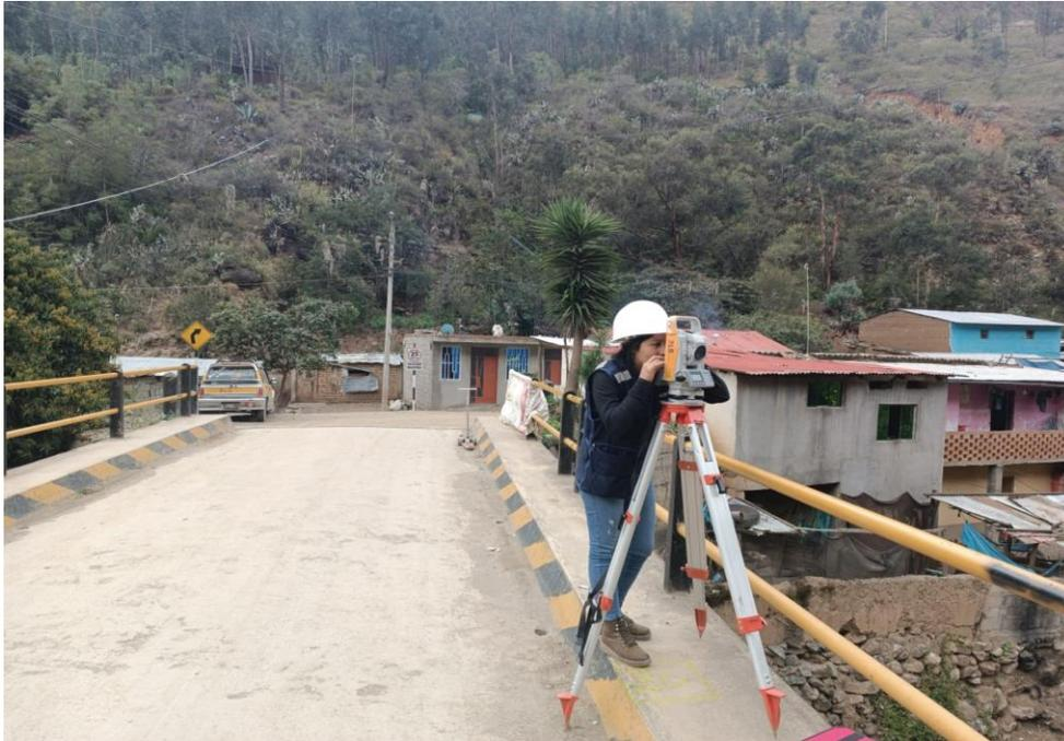
SE REALIZÓ EL LEVANTAMIENTO TOPOGRAFICO EN LE PUENTE PARA DETERMINAR LA GEOMETRIA DEL PUENTE Y TOMAR DATOS TOPOFRATICOS PARA TRABAJOS DE GABINETE.
