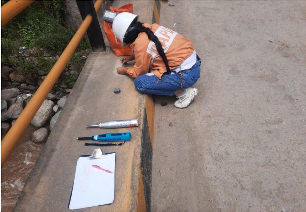
SE REALIZARON ENSAYOS DE ESCLEROMETRIA PARA ESTIMAR LA RESISTENCIA DEL CONCRETO SIGUIENDO LOS PRECEDIMIENTOS ESTABLECIDOS EN EL ASTM C805 SE TOMARON MUESTRAS EN LOS DIFERENTES ELEMENTOS DE LA SUPERESTRUCTURA DEL PUENTE. EN LA FOTOGRAFIA SE MUESTRA EL DIBUJO DE LA CUADRICULA PARA LA TOMA DE NUMERO DE REBOTE DEL ESCLEROMETRO.
