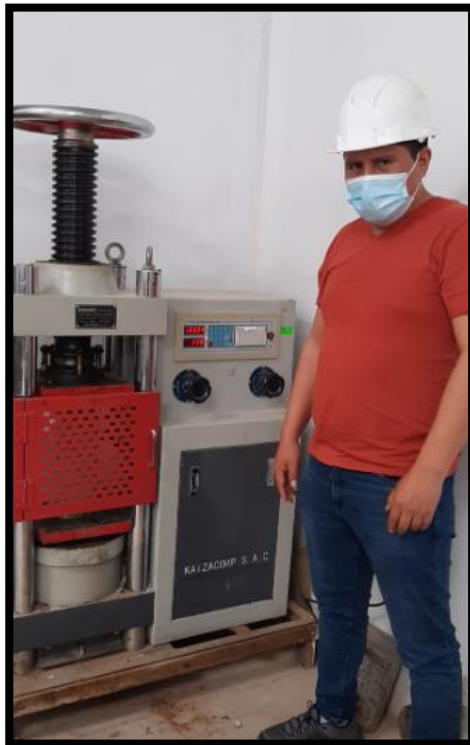
Fotografía 35: Rotura de testigos de concreto del módulo 2.
