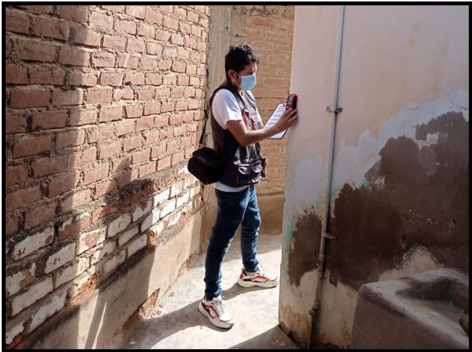
Fotografía 21 y 22: Medición con pacómetro en columnas.
