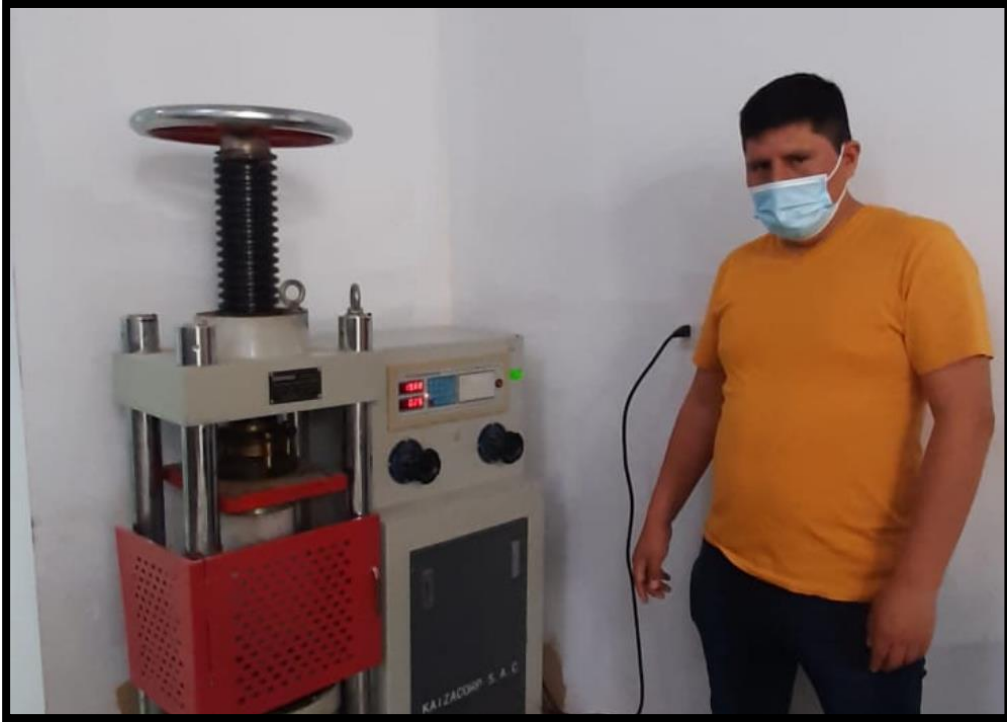
Fotografía 34: Rotura de testigos de concreto del módulo 1.
