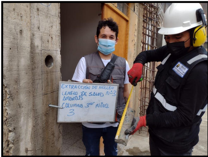
Fotografía 33: Extracción de testigos de concreto módulo 2.
