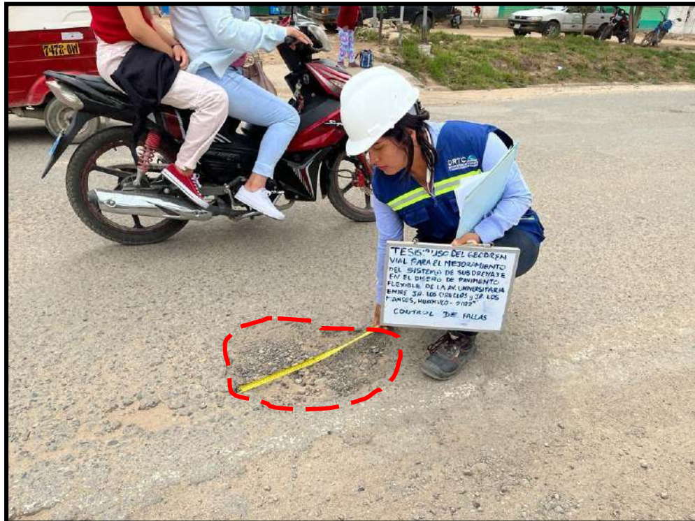
Figura 6 Bache de grado de severidad media , registrado en la unidad de muestra U6, sección 1. Tiene una profundidad de 13 cm y un diámetro de 58 cm.
