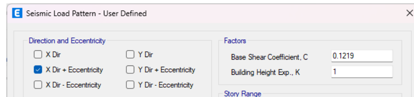
Figura 52 Parámetros de sismo estático en X-X del caso 2
