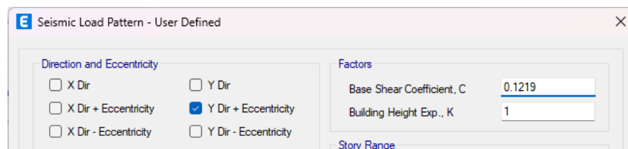
Figura 46 Parámetros de sismo estático en Y-Y del caso 1
