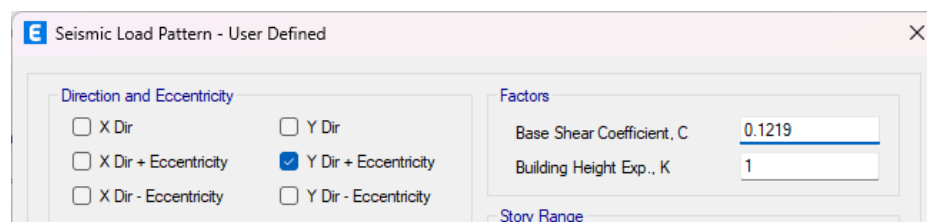
Figura 123 Parámetros de sismo estático en Y-Y del caso 6
