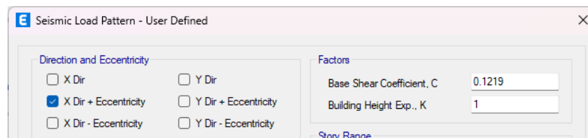
Figura 157 Parámetros de sismo estático en X-X del caso 5
