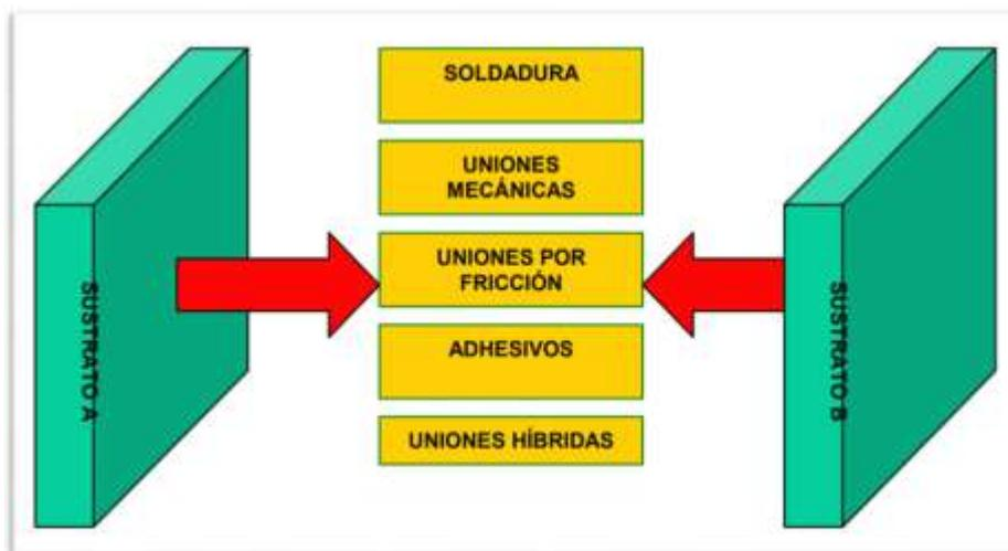
**Nota:** En la figura se puede observar cómo es la unión de sustratos, en este caso el sustrato A y sustrato B, p.9, extraído de la web: <https://repositorio.ucv.edu.pe/handle/20.500.12692/39761>
