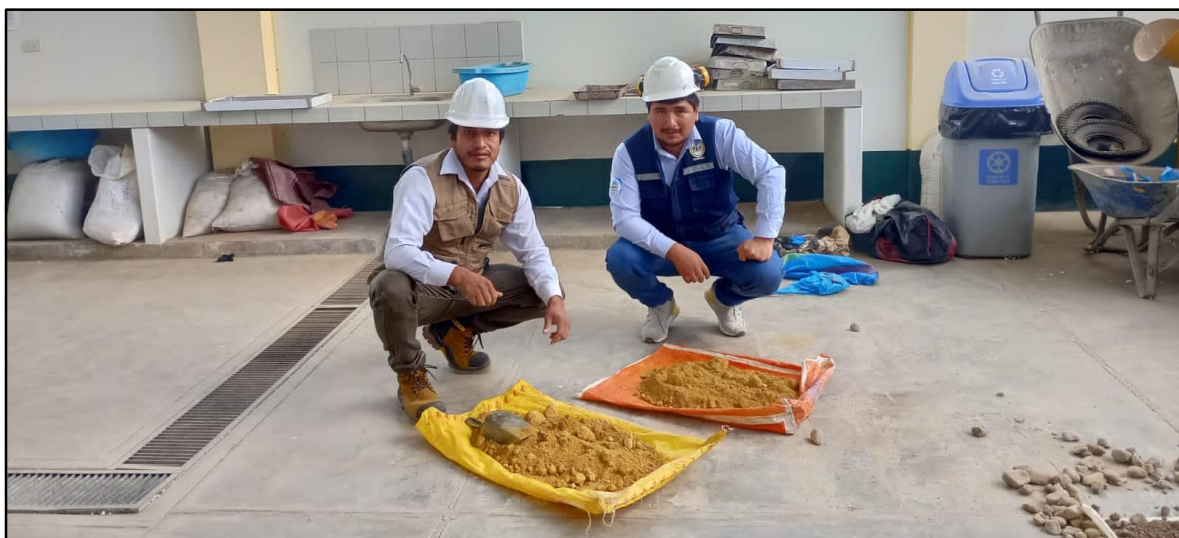
Imagen 08: En la imagen se puede observar la extracción de muestra de las calicatas de talud en estudio del tramo Rancho-Panao km 42.
