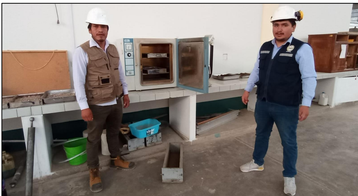
Imagen 10: En la imagen se puede observar el secado de las muestras en laboratorio de Geotecnia, Pavimentos y Ensayo de Materiales.
