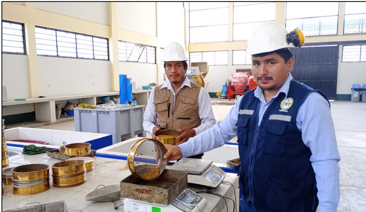
Imagen 13: En la imagen se puede observar el peso retenido de la muestra en laboratorio de Geotecnia, Pavimentos y Ensayo de Materiales.
