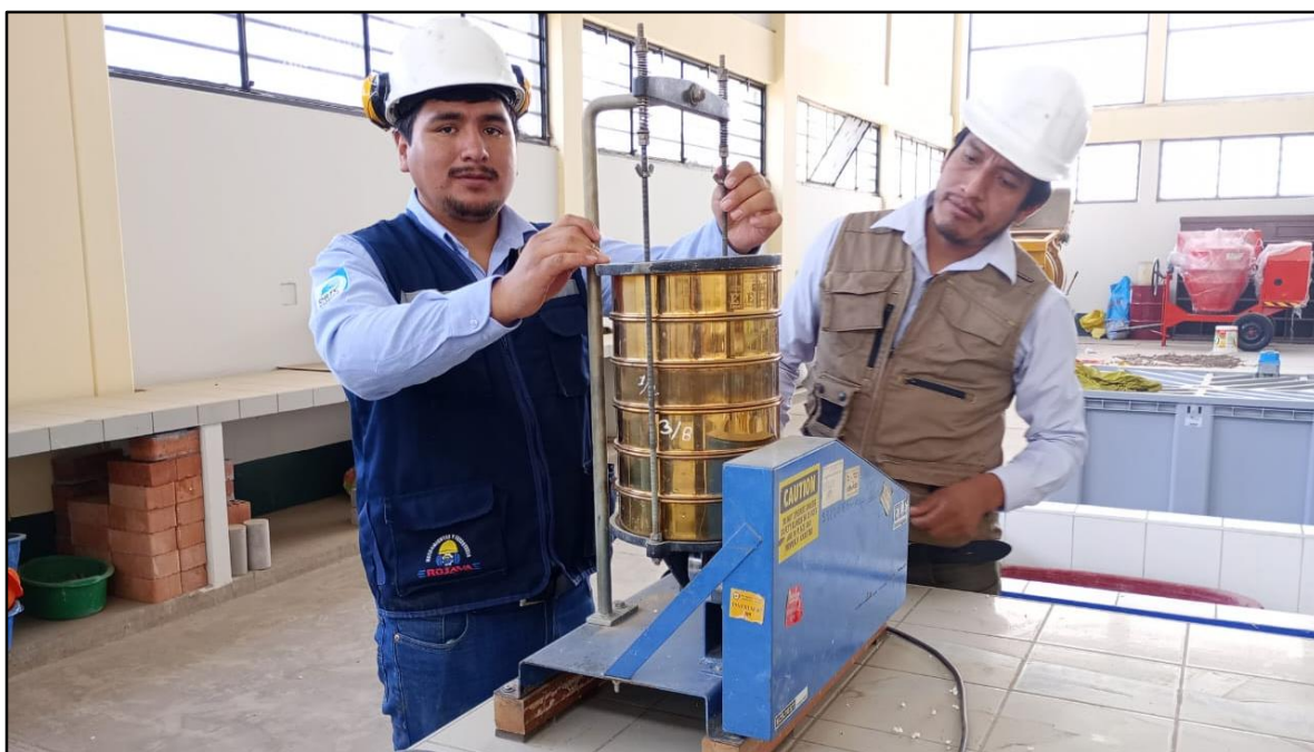
Imagen 12: En la imagen se puede observar en el tamizador en laboratorio de Geotecnia, Pavimentos y Ensayo de Materiales.
