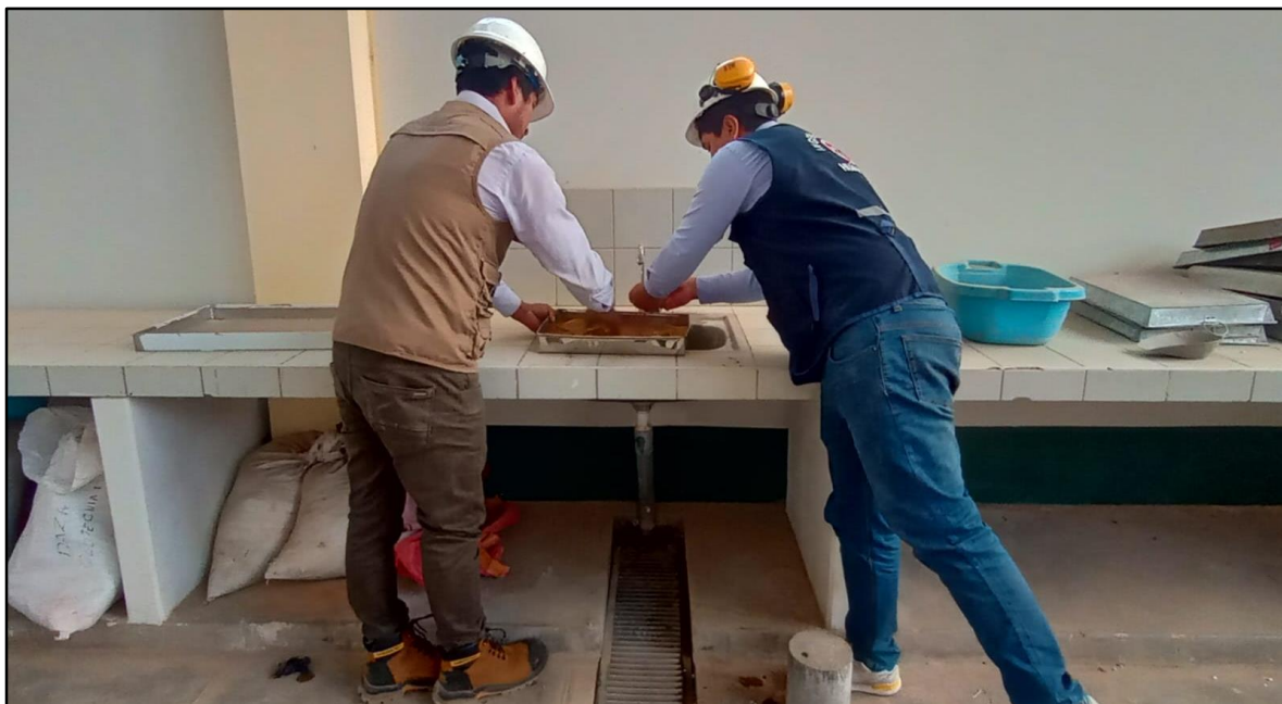
Imagen 09: En la imagen se puede observar el lavado de las muestras en laboratorio de Geotecnia, Pavimentos y Ensayo de Materiales.
