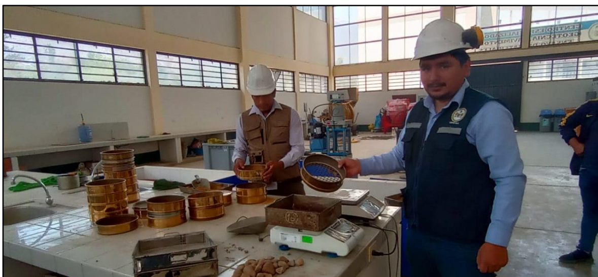
Imagen 14: En la imagen se puede observar el peso retenido de la muestra en laboratorio de Geotecnia, Pavimentos y Ensayo de Materiales.
