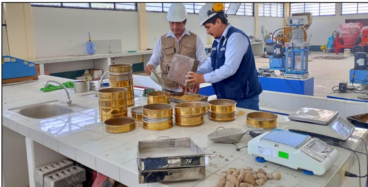
Imagen 11: En la imagen se puede observar los tamices que se utilizaron para el ensayo de granulometría de las muestras.
