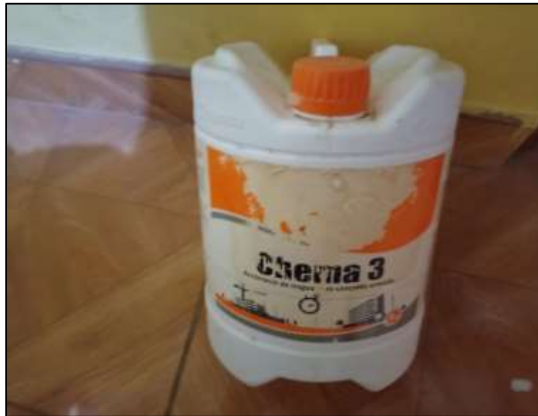
Figura 12. Aditivo Chema 3. Tipo acelerante.
