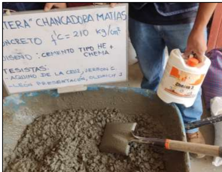
Figura 16. Mezcla diseñada con el cemento tipo HE y chema 3.
