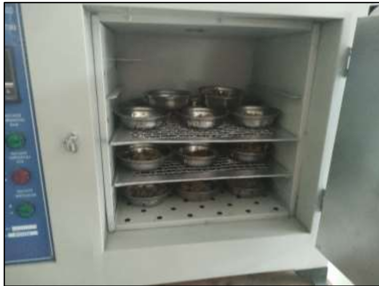
Figura 8. Ensayos de humedad de agregados.
