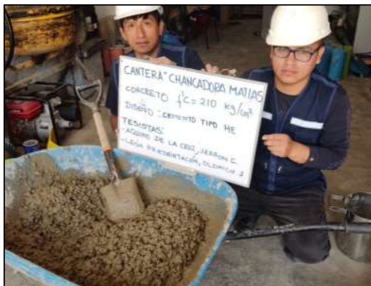
Figura 14. Mezcla diseñada con el cemento tipo HE.
