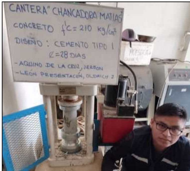
Figura 29. Prueba de resistencia. Edad 28 días. Diseño: Cemento tipo I.
