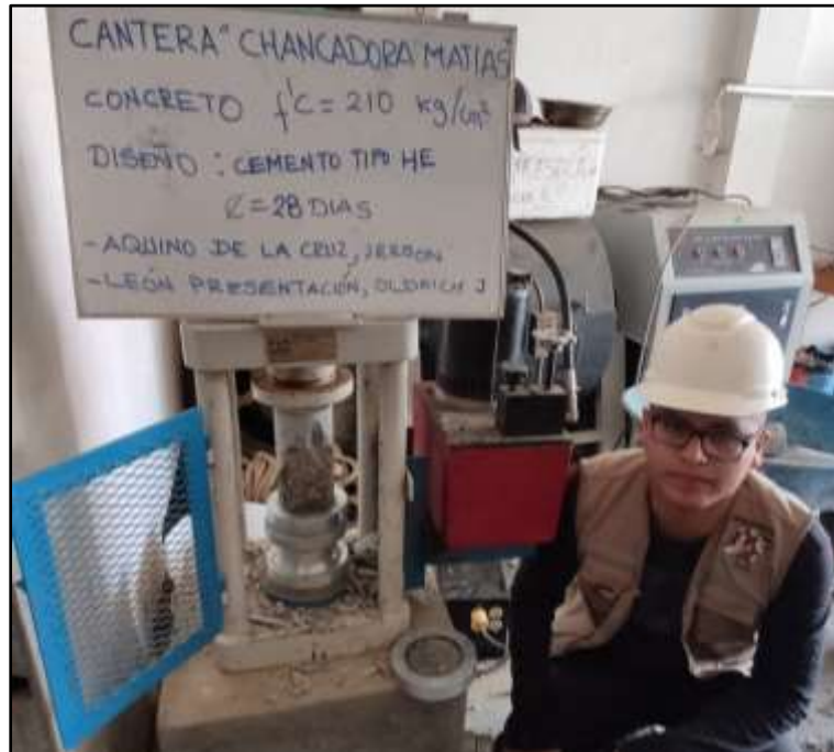
Figura 30. Prueba de resistencia. Edad 28 días. Diseño: Cemento tipo HE.
