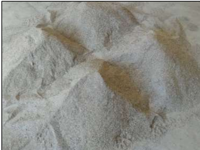
Figura 5. Cuarteo del agregado fino.
