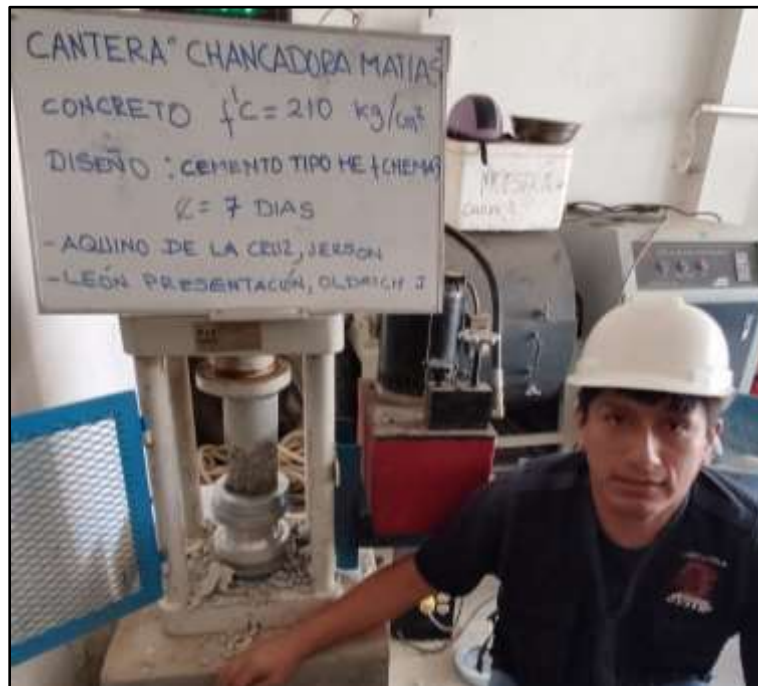
Figura 24. Prueba de resistencia. Edad 7 días. Diseño: Cemento tipo HE + Chema 3.
