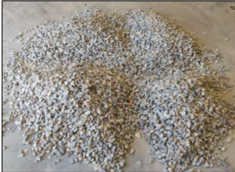
Figura 4. Cuarteo del agregado grueso.
