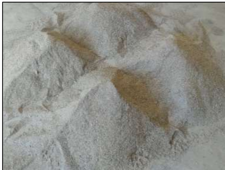
Figura 9. Cuarteo del agregado grueso.
