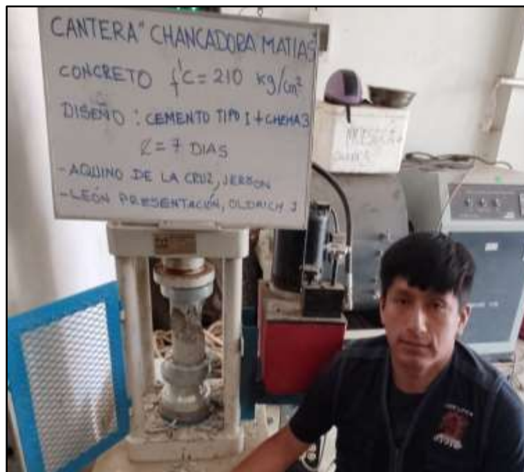
Figura 23. Prueba de resistencia. Edad 7 días. Diseño: Cemento tipo I + Chema 3.
