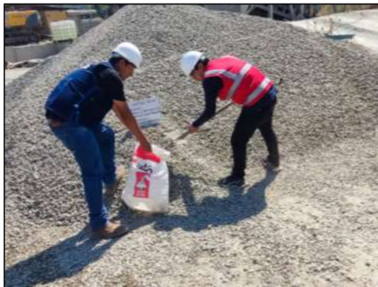
Figura 1. Selección del agregado grueso en cantera.
