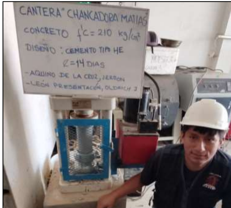
Figura 26. Prueba de resistencia. Edad 14 días. Diseño: Cemento tipo HE.
