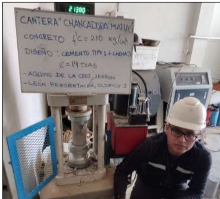
Figura 27. Prueba de resistencia. Edad 14 días. Diseño: Cemento tipo I + Chema 3.
