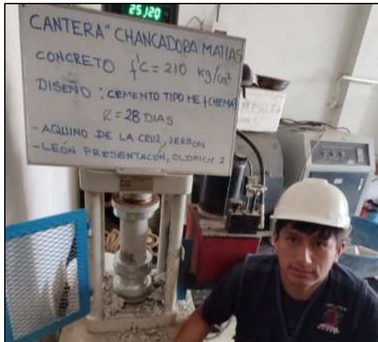
Figura 32. Prueba de resistencia. Edad 28 días. Diseño: Cemento tipo HE + Chema 3.
