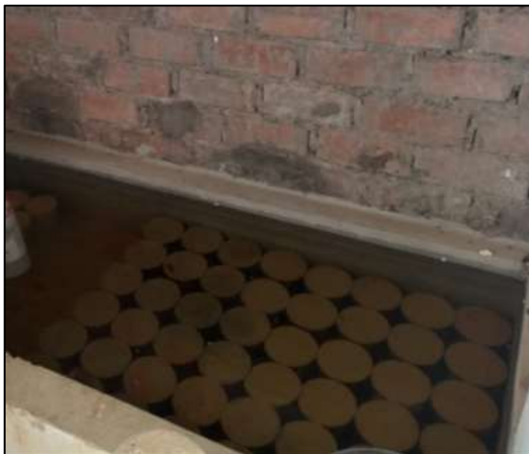
Figura 19. Curado de las 48 probetas en la poza.
