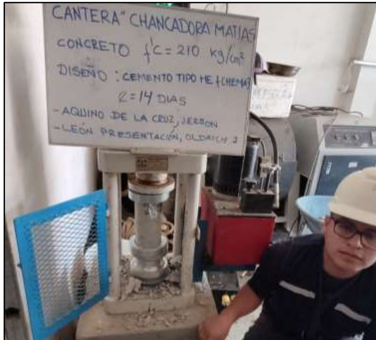
Figura 28. Prueba de resistencia. Edad 14 días. Diseño: Cemento tipo HE + Chema 3.
