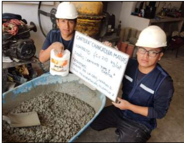
Figura 15. Mezcla diseñada con el cemento tipo I y chema 3.
