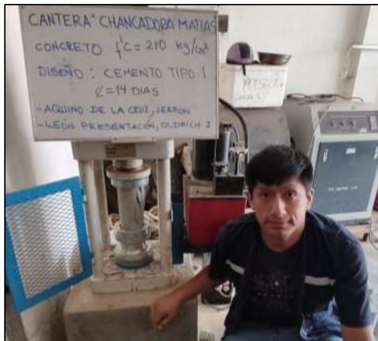
Figura 25. Prueba de resistencia. Edad 14 días. Diseño: Cemento tipo I.
