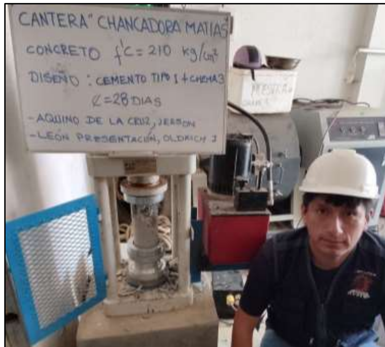
Figura 31. Prueba de resistencia. Edad 28 días. Diseño: Cemento tipo I + Chema 3.
