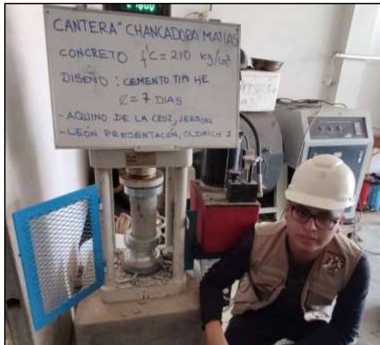
Figura 22. Prueba de resistencia. Edad 7 días. Diseño: Cemento tipo HE.
