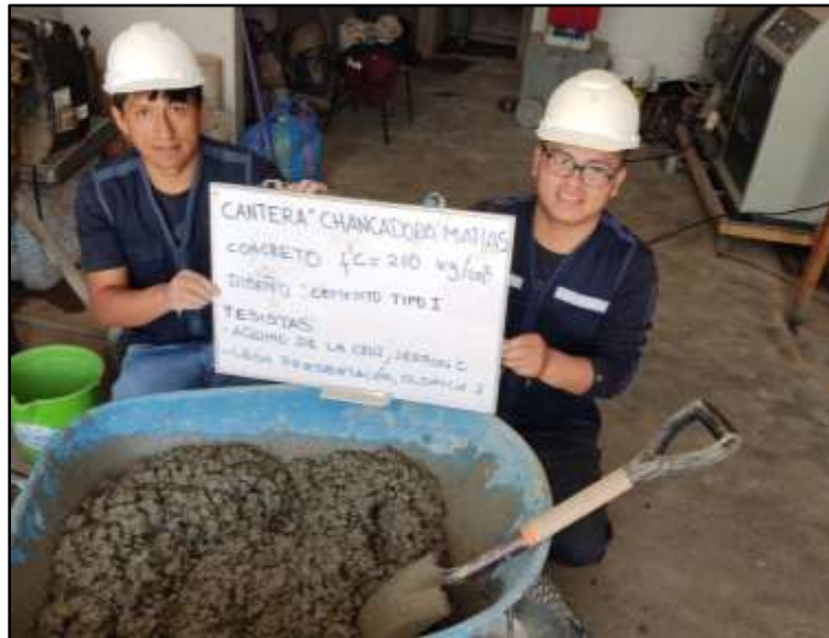
Figura 13. Mezcla diseñada con cemento tipo I.
