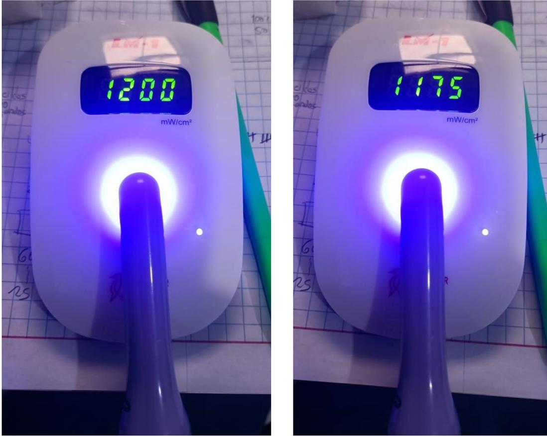
Figura 5 y figura 6. Radiómetro en el cual se verificó la potencia de la lámpara Iled (Woodpecker) y también en el cual se realizó la medición antes de cada grupo y cada disparo.
