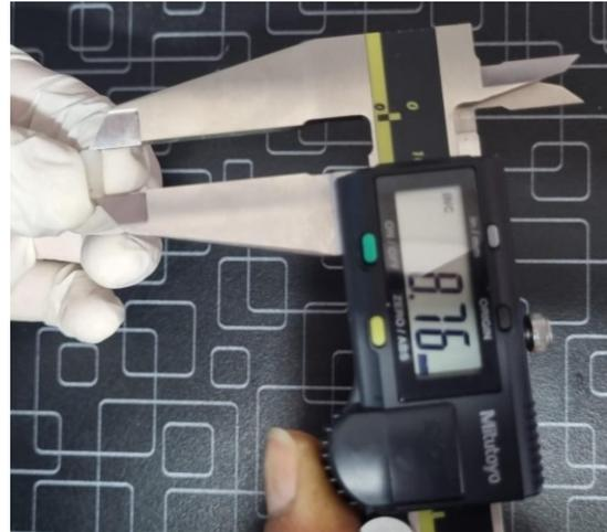
Figura 16 figura 17. Ya después de realizar el raspado de la resina, procedimos a medir la resina y esta medición se hizo a los extremos y en la parte media, las mediciones se ejecutaron 2 veces para evitar variaciones.
