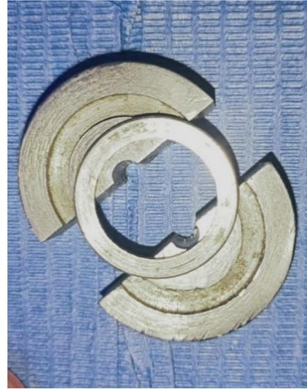
Figura 2 y figura 3: Matriz de acero inoxidable de 10mm de altura con circunferencia interna de 4mm de diámetro con anillo de fijación, utilizado para realizar los bloques de resina y posteriormente la prueba Scraping Test.
