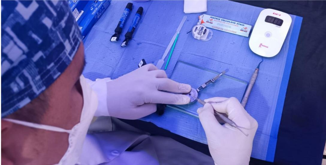
Figura 15. Todo el proceso desde la compactación de la resina hasta el raspado de la parte no polimerizada fue realizado por una sola persona así evitando la intensidad y discrepancia de fuerzas entre distintos operadores.
