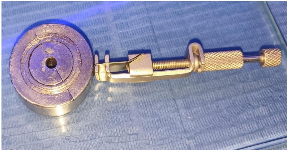
Figura 4. Porta matriz para poder mantener una alta precisión de la circunferencia interna de 4mm, para posteriormente añadir la resina.
