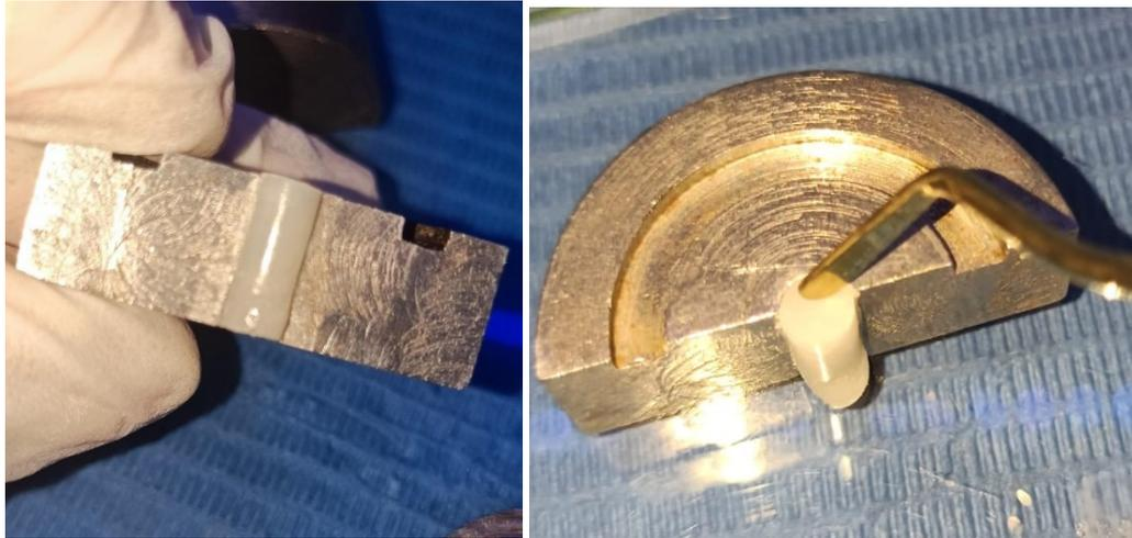
Figura 12. Se procede a desmoldar el molde de acero primero la porta matriz luego el anillo de fijación y ultimo la resina con mucho cuidado, con una espátula de resina se retira el bloque por la parte superior evitando fracturarla.
