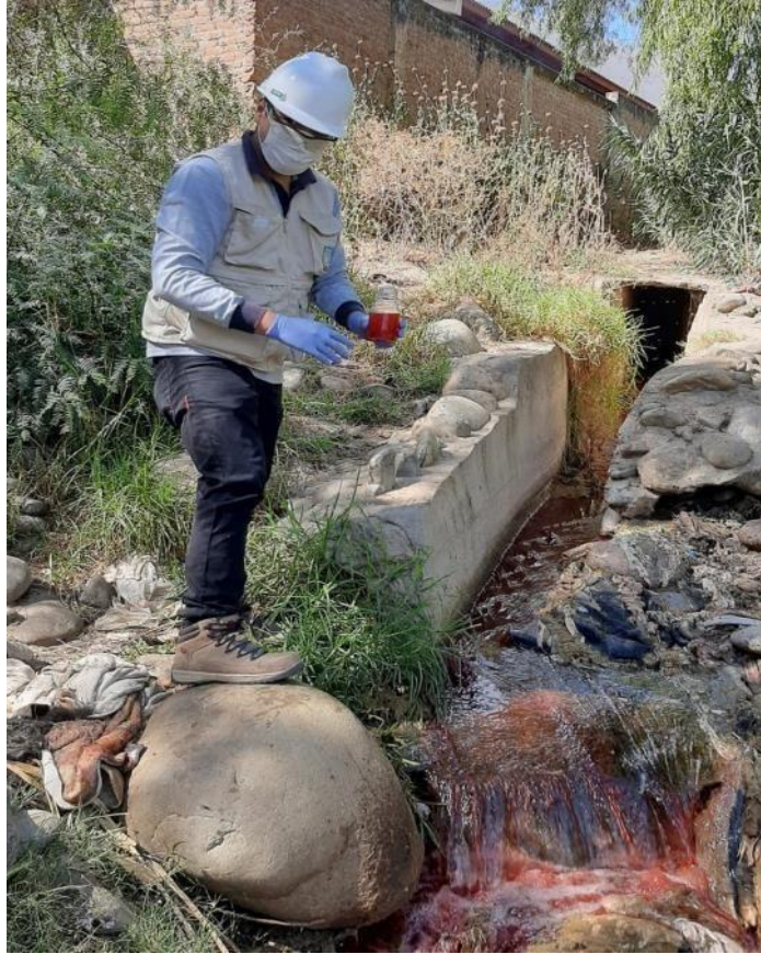
Fotografía 25 Recolección de muestrade aguas residuales provenientes del camal municipal
