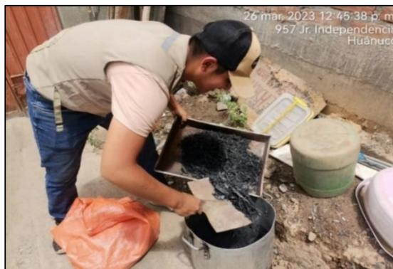
Tras la obtención de las cenizas, se llevó a cabo un proceso de molienda con el objetivo de eliminar impurezas encontradas y lograr un nivel adecuado de finura comparable a la del cemento, como se observa en la Figura 25.
