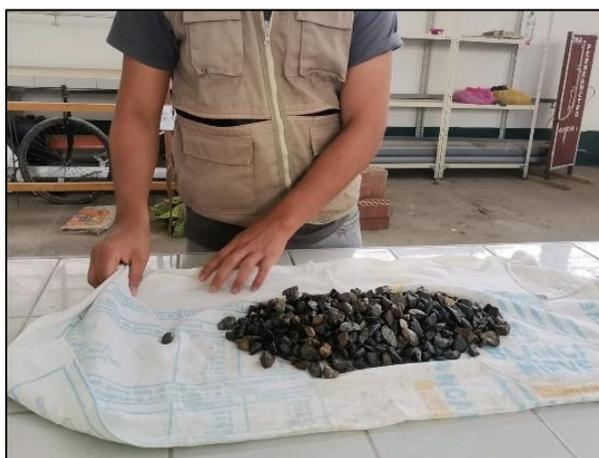
Seguidamente, se procedió a retirar la muestra del agua y se eliminaron las partículas visibles de agua al rolarla sobre un paño absorbente, como se muestra en la
