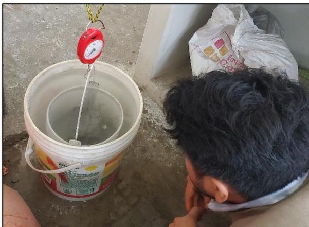
Seguidamente, se retiró la muestra sumergida y se secó superficialmente con un mantel antes de pesarla para obtener peso saturado. Finalmente, los adoquines fueron colocados en el horno para obtener el peso seco de las muestras.
