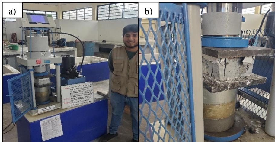
*Nota.* a) Colocación de la muestra de ensayo b) Rotura de la muestra de ensayo.
