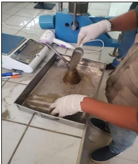
A continuación, se pesó y se colocaron 500 g de la muestra dentro del picnómetro, el cual se llenó de agua hasta alcanzar la marca especificada en el dispositivo. Para eliminar el aire presente en el picnómetro, se utilizó una bomba de vacío.
