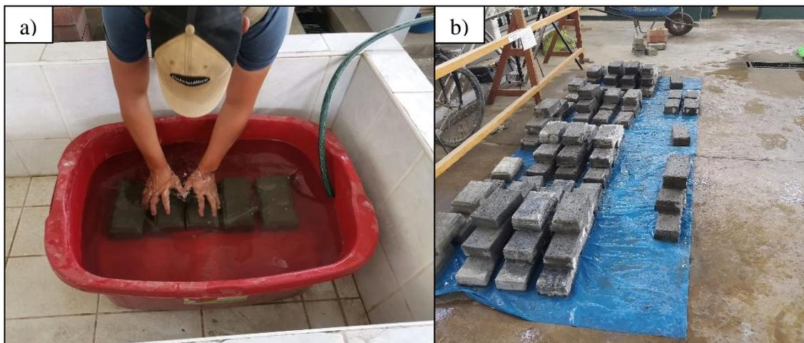
*Nota.* a) Curado de muestras por sumersión b) Curado de muestras por riego.
