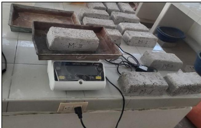
Posteriormente, se realizó la inmersión de las muestras en agua durante un plazo de 24 horas. Luego del tiempo de sumersión, como se observa en la Figura 55, las muestras fueron retiradas y pesadas para la obtención del peso saturado.
