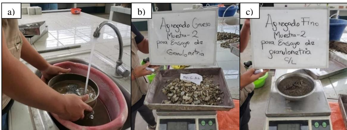
*Nota.* a) Lavado de agregados b) Agregado grueso lavado c) Agregado fino lavado.
