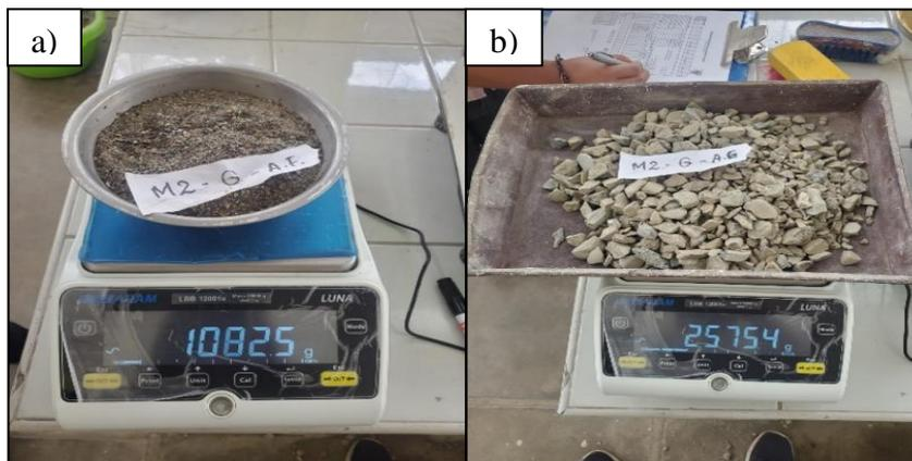
*Nota.* a) Pesado de agregado fino seco al horno b) Pesado de agregado grueso seco al horno.
