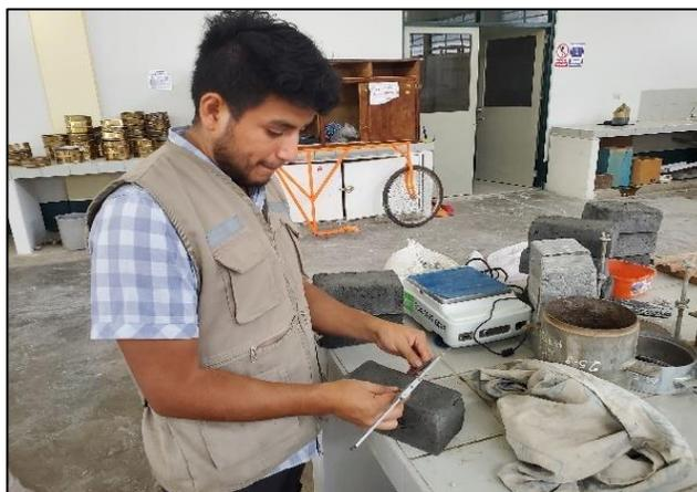
Luego se realizó el refrendado de las muestras de adoquines para que tengan un nivel uniforme y pueda distribuirse de manera uniforme en una de las caras del adoquín la carga aplicada por la maquina uniaxial, la cantidad de adoquines que se usaron para los especímenes de prueba fue de 3 muestras tal y como indica en la NTP 366.604.
