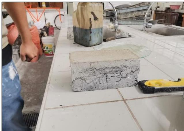
A continuación, después de haber logrado la consolidación del refrendado, se procedió a la disposición de los adoquines en la máquina uniaxial.
