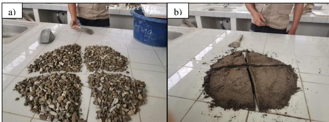
*Nota.* a) Cuarqueo de agregados gruesos b) Cuarqueo de agregados finos.
