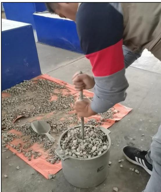
Una vez que se colocó la muestra de agregados dentro de los recipientes, se niveló la parte superior de la muestra para obtener una superficie plana y se pesaron los recipientes con la muestra para obtener el peso total de la muestra contenida.
