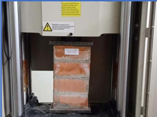
**Figura 123.** Pila de albañilería N°13-Dosf. (1:6+10%CH), soporta una resistencia de axial de (4.580 Mpa).
