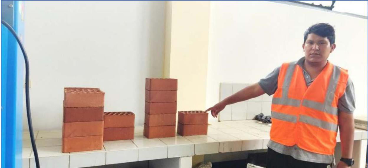
Nota. Se eliminó todo tipo de material orgánico e inorgánico que estaba adherido a los ladrillos y se remojo en agua lo necesario para evitar absorción cuando se elaboró las pilas y los muretes. Autores: Gómez & Soto. Elaboración Propia
