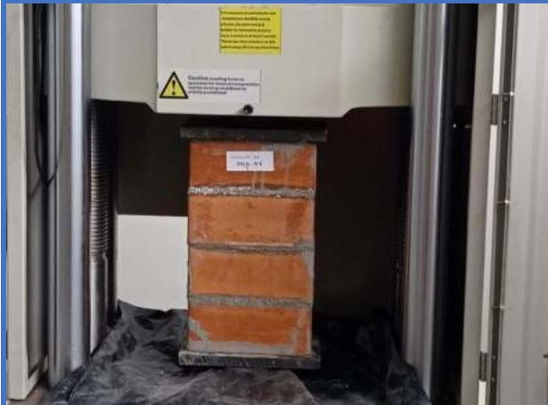
**Figura 109.** Pila de albañilería N°6-Dosf. (1:6+5%CH), soporta una resistencia de axial de (5.06 Mpa).
