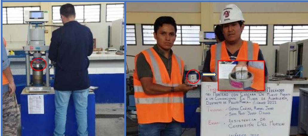
**Figura 151.** Mortero en Cubos de concreto N°18 - Dosificación. (1:4), soporta una resistencia de axial de (9.545 Mpa).
