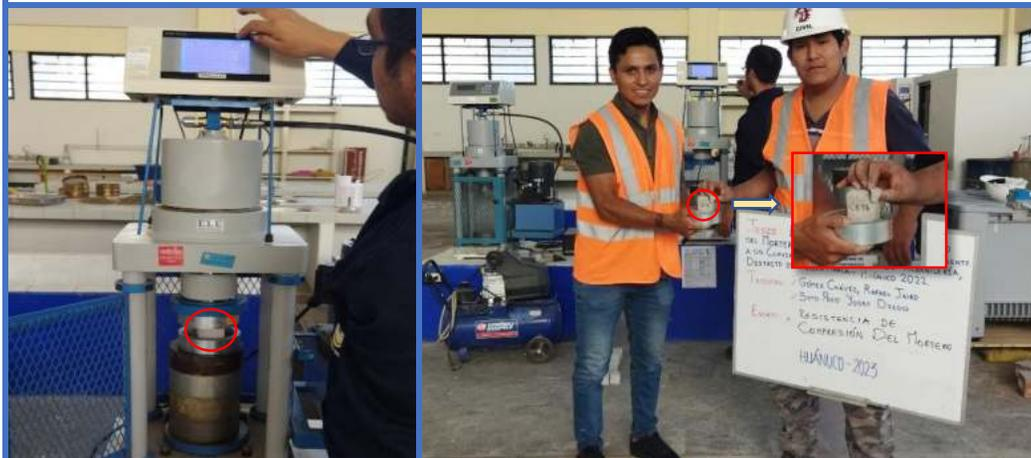
**Figura 150.** Mortero en Cubos de concreto N°17 - Dosificación. (1:4), soporta una resistencia de axial de (8.413 Mpa).
