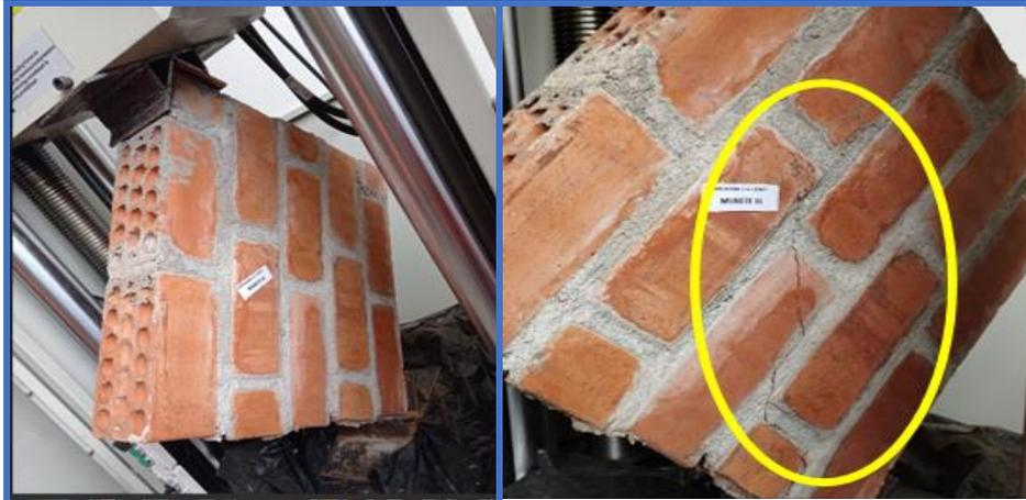
**Figura 179.** Muretes de concreto N°16 - Dosif. 1 : 6 + 15% C.H, falla por traccion diagonal y soporta una resistencia al corte de 5.76kg/cm<sup>2</sup>.
