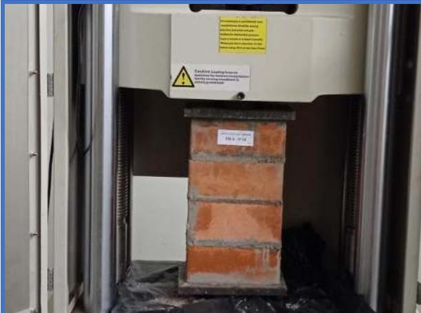
**Figura 119.** Pila de albañilería N°11-Dosf. (1:6+10%CH), soporta una resistencia de axial de (5.064 Mpa).
