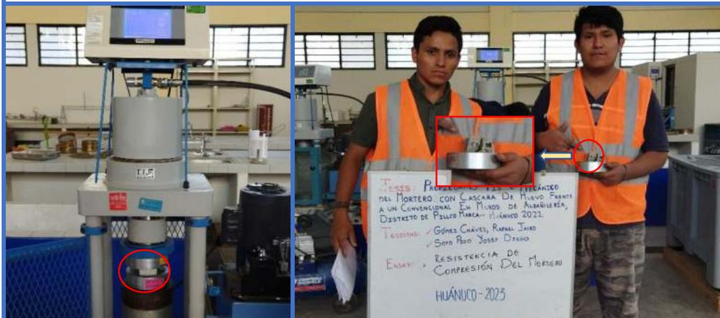
**Figura 163.** Mortero en Cubos de concreto N°30-Dosif. (1:6+20%C.H), soporta una resistencia de axial de (7.855 Mpa).
