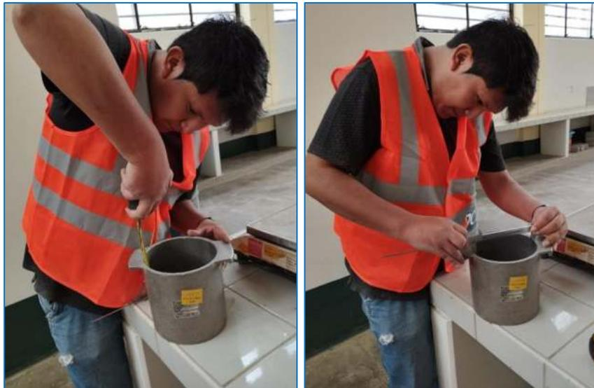
Nota. Medición de las dimensiones del recipiente (Diámetro y altura) para obtener el volumen.
