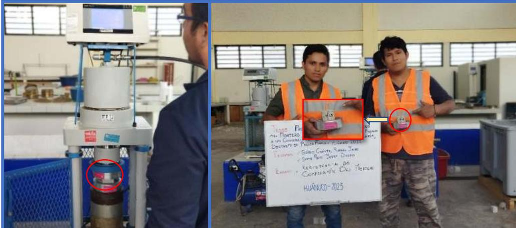
**Figura 158.** Mortero en Cubos de concreto N°25-Dosif. (1:6+15%C.H), soporta una resistencia de axial de (7.770 Mpa).
