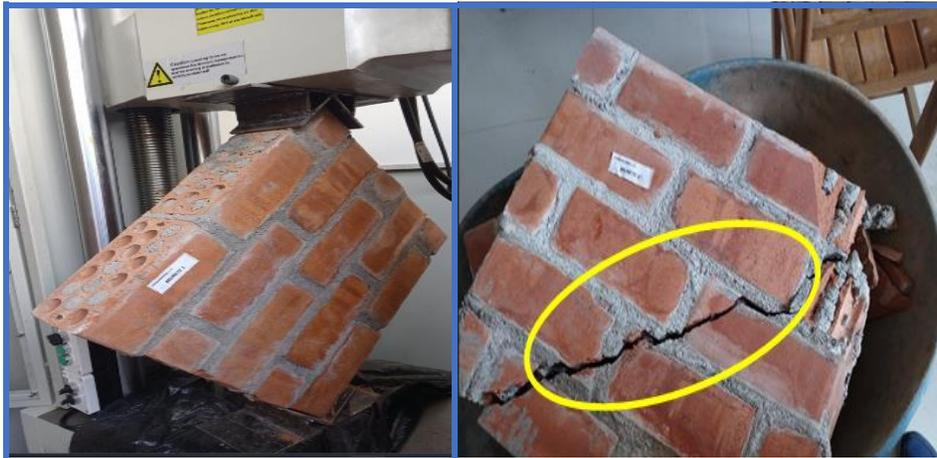
**Figura 164.** Muretes de concreto N°1 – Dosif. 1 : 4, falla por traccion diagonal y soporta una resistencia al corte de 7.55kg/cm2.
