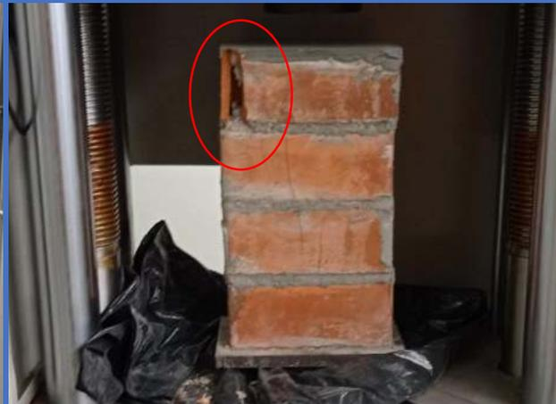
**Figura 136.** Pila de albañilería N°19-Dosf. (1:6+15%CH), muestra un tipo de falla por "Ladrillo ranurado"
