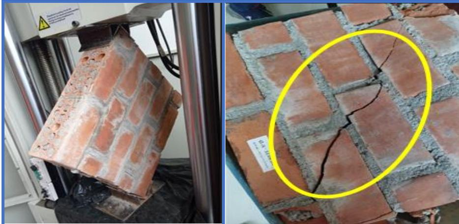
**Figura 176.** Muretes de concreto N°13 - Dosif. 1 : 6 + 10% C.H, falla por tracción diagonal y soporta una resistencia al corte de 7.92kg/cm<sup>2</sup>.
