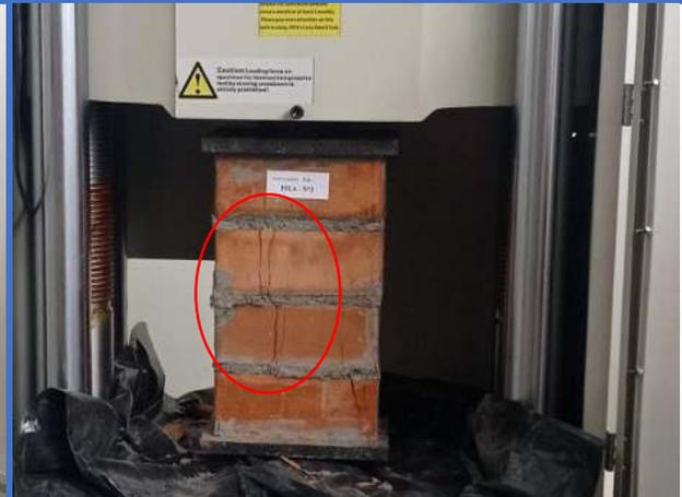
**Figura 104.** Pila de albañilería N°3-Dosf. (1:4), muestra un tipo de falla por “Ladrillos ranurados” y “Falla Ideal”.
