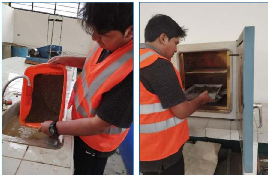
Nota. Proceso de lavado del agregado fino (Arena gruesa natural) y secado en horno con una temperatura de  $110^{\circ}\pm 5^{\circ}\text{C}$ . Autores: Gómez & Soto. Elaboración Propia.
