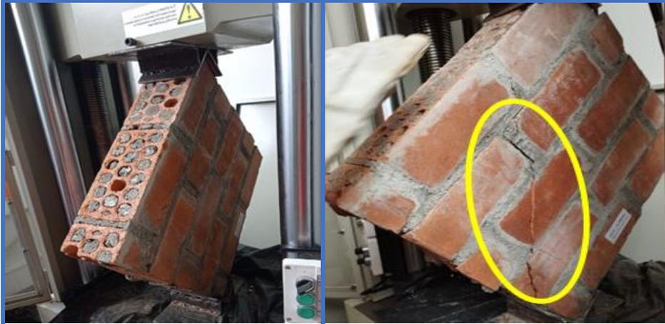
**Figura 173.** Muretes de concreto N°10 - Dosif. 1 : 6 + 5% C.H, falla por traccion diagonal y soporta una resistencia al corte de 5.64kg/cm<sup>2</sup>.
