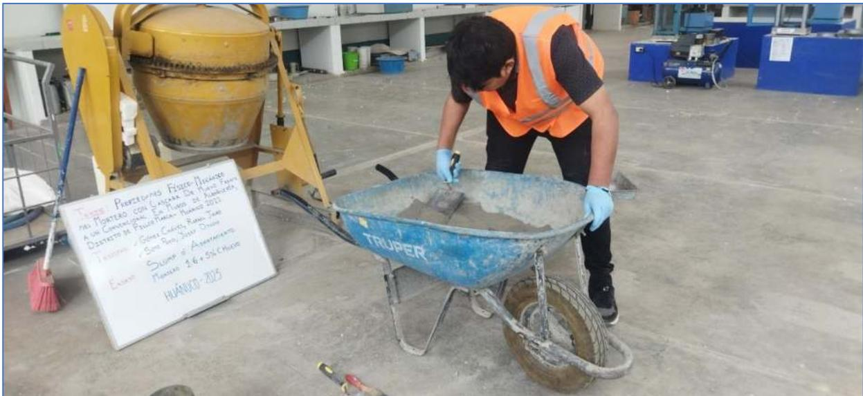
Nota. Se mezcla los materiales en el buggy para la fabricación de los tipos de morteros (convencional y experimental). Autores: Gómez & Soto. Elaboración Propia
