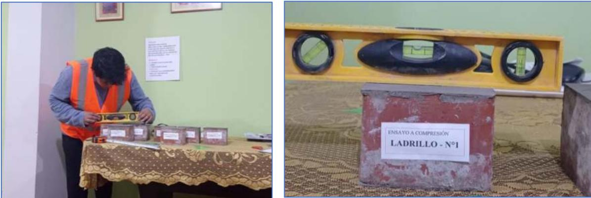
Nota. Refrenado de yeso y cemento en los especímenes, se verificó con el nivel las irregularidades en la superficie. Autores: Gómez & Soto. Elaboración Propia
