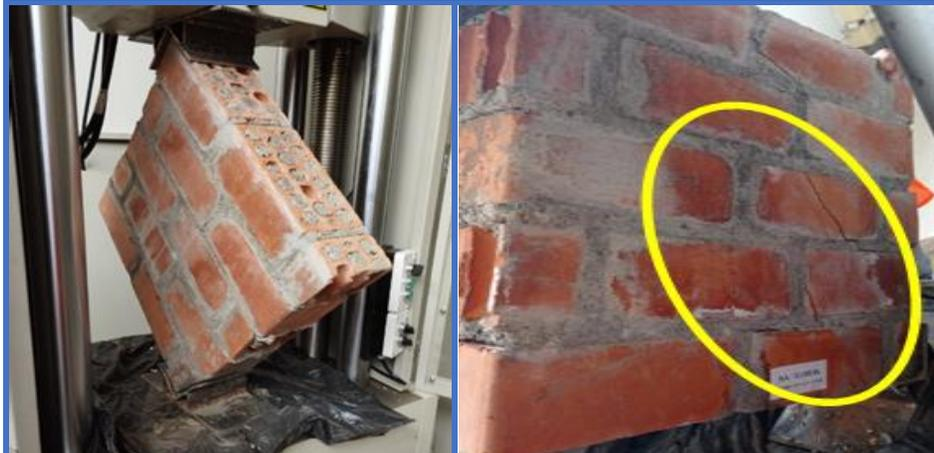
**Figura 169.** Muretes de concreto N°6 - Dosif. 1 : 6 + 5% C.H, falla mixta y soporta una resistencia al corte de 6.41kg/cm<sup>2</sup>.
