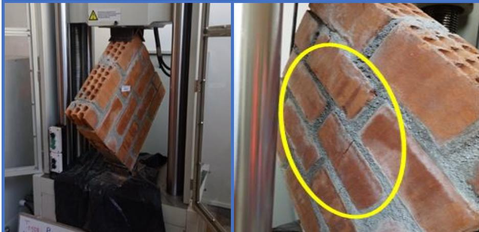
**Figura 166.** Muretes de concreto N°3 - Dosif. 1 : 4, falla por traccion diagonal y soporta una resistencia al corte de 6.17kg/cm2.
