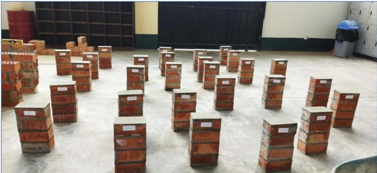
Nota. Pilas de albañilería de diferentes tipos de mortero (convencional – experimental) con refrenado de yeso - cemento. Autores: Gómez & Soto. Elaboración Propia.
