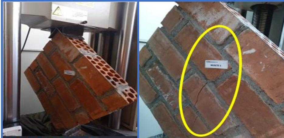
**Figura 168.** Muretes de concreto N°5 - Dosif. 1 : 4, falla por traccion diagonal y soporta una resistencia al corte de 8.11kg/cm<sup>2</sup>.
