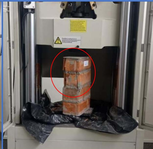
**Figura 100.** Pila de albañilería N°1-Dosf. (1:4), muestra un tipo de falla por "Trituración de Ladrillos".
