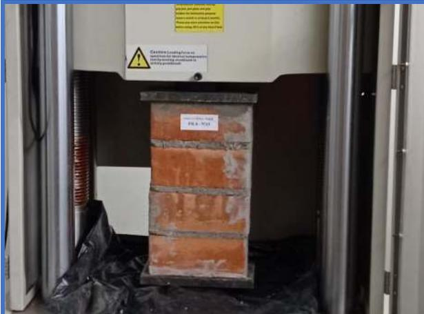
**Figura 113.** Pila de albañilería N°8-Dosf. (1:6+5%CH), soporta una resistencia de axial de (5.817 Mpa).
