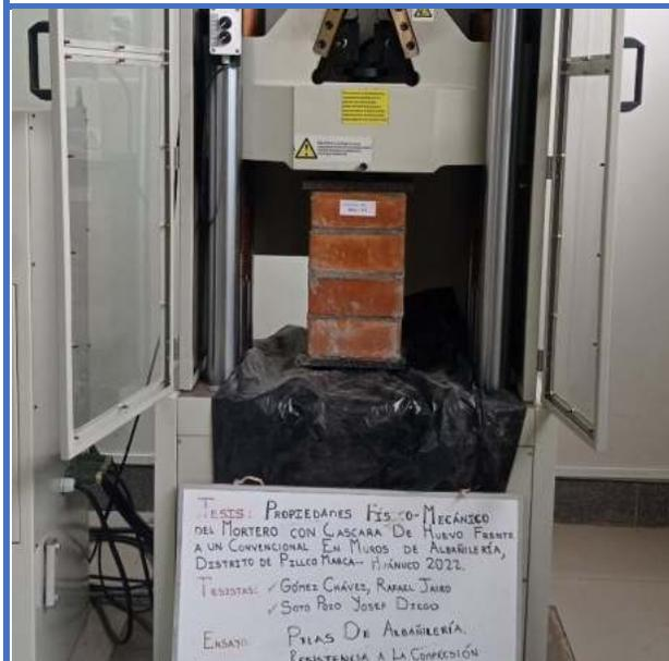
**Figura 101.** Pila de albañilería N°2-Dosf. (1:4), soporta una resistencia de axial de (4.475 Mpa).
