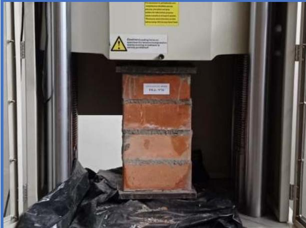
**Figura 139.** Pila de albañilería N°21-Dosf. (1:6+20%CH), soporta una resistencia de axial de (5.973 Mpa).
