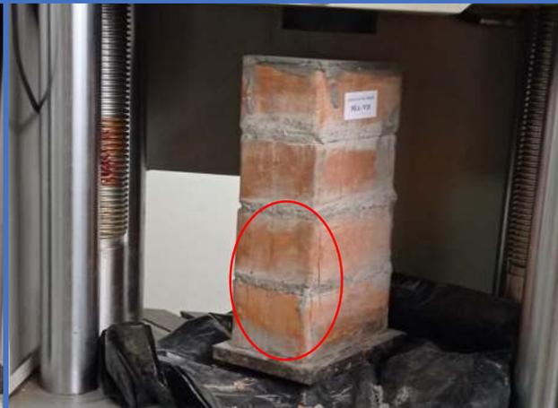
**Figura 128.** Pila de albañilería N°15-Dosf. (1:6+10%CH), muestra un tipo de falla por ‘Falla Ideal’.
