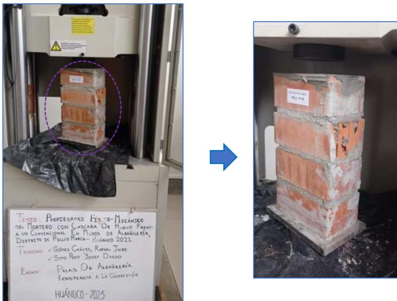
Nota. Resultado y Falla de las pilas de albañilería después del ensayo a compresión axial.
