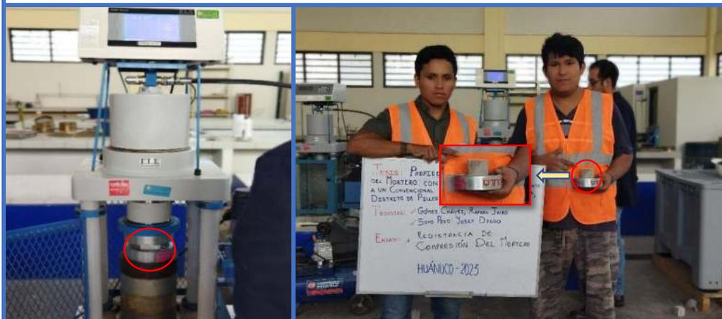
**Figura 160.** Mortero en Cubos de concreto N°27-Dosif. (1:6+15%C.H), soporta una resistencia de axial de (7.814 Mpa).
