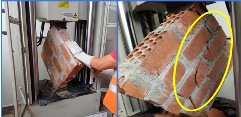
**Figura 186.** Muretes de concreto N°23 - Dosif. 1 : 6 + 20% C.H, falla mixta y soporta una resistencia al corte de 6.14kg/cm<sup>2</sup>.
