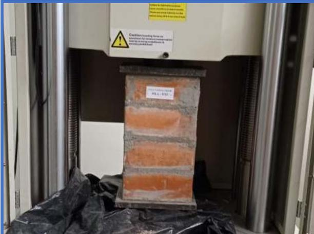
**Figura 137.** Pila de albañilería N°20-Dosf. (1:6+15%CH), soporta una resistencia de axial de (4.084 Mpa).
