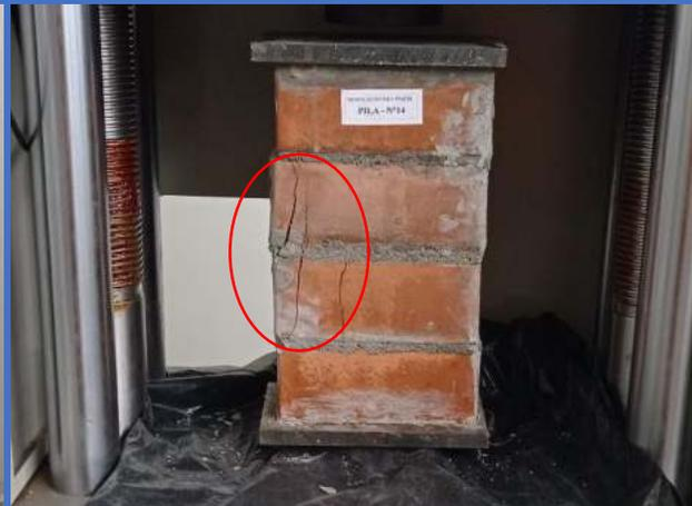
**Figura 116.** Pila de albañilería N°9-Dosf. (1:6+5%CH), muestra un tipo de falla por "Ladrillo ranurados" y "Falla Ideal".
