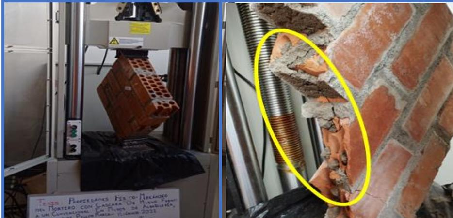
**Figura 178.** Muretes de concreto N°15 - Dosif. 1 : 6 + 10% C.H, falla por tracción diagonal y soporta una resistencia al corte de 8.18kg/cm<sup>2</sup>.
