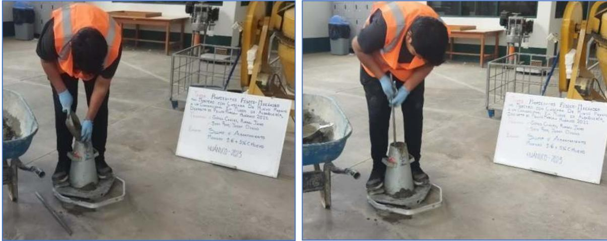
Nota. Llenado del mortero en capas de un  $\frac{1}{3}$  de altura del cono y compactado cada capa a 25 golpes. Autores: Gómez & Soto. Elaboración Propia
