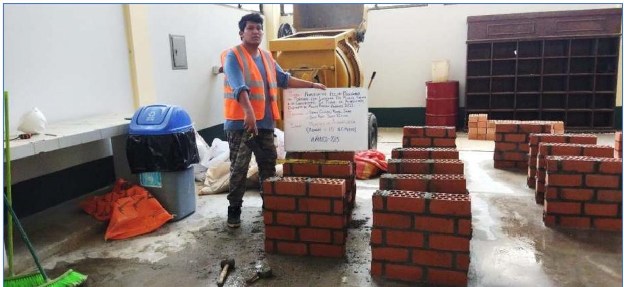
Nota. Asentado y verificación del nivel horizontal y vertical en muretes de albañilería. Autores: Gómez & Soto. Elaboración Propia.
