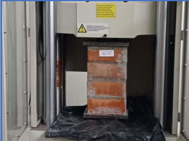
**Figura 115.** Pila de albañilería N°9-Dosf. (1:6+5%CH), soporta una resistencia de axial de (4.849 Mpa).
