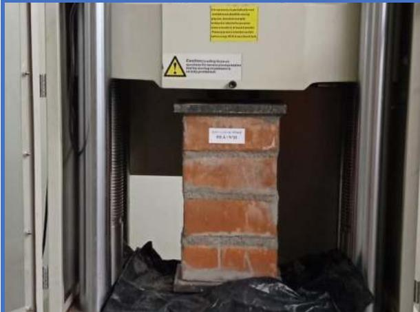
**Figura 131.** Pila de albañilería N°17-Dosf. (1:6+15%CH), soporta una resistencia de axial de (4.451 Mpa).
