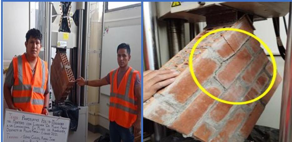
**Figura 171.** Muretes de concreto N°8 - Dosif. 1 : 6 + 5% C.H, falla escalonada y soporta una resistencia al corte de 5.8kg/cm2.
