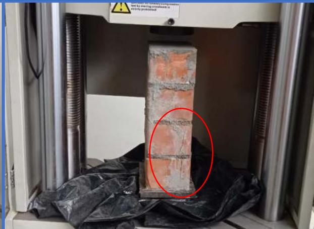
**Figura 112.** Pila de albañilería N°7-Dosf. (1:6+5%CH), muestra un tipo de falla por "Falla Ideal".
