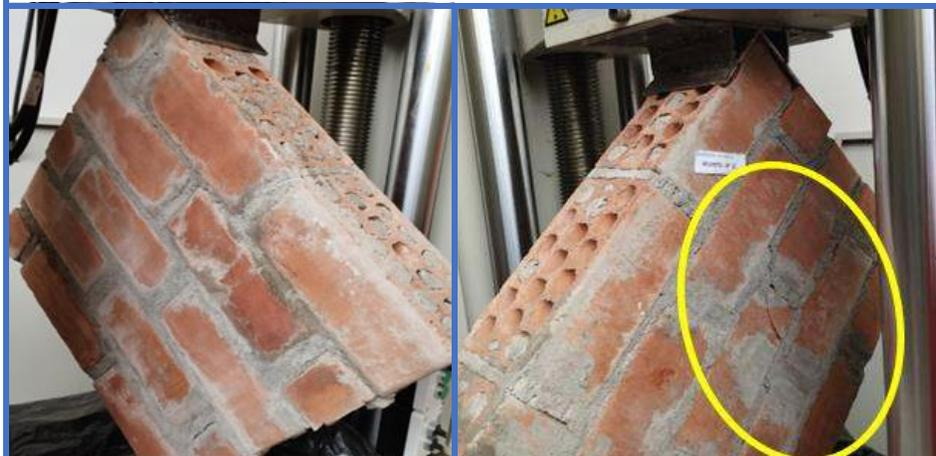
**Figura 184.** Muretes de concreto N°21 - Dosif. 1 : 6 + 20% C.H, falla escalonada y soporta una resistencia al corte de 5.17kg/cm<sup>2</sup>.
