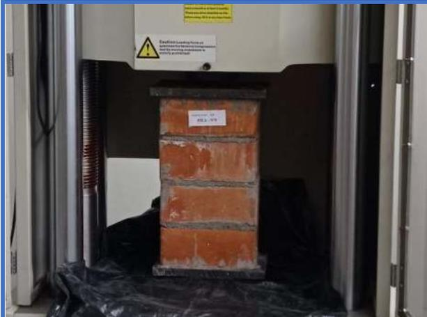
**Figura 107.** Pila de albañilería N°5-Dosf. (1:4), soporta una resistencia de axial de (8.717 Mpa).
