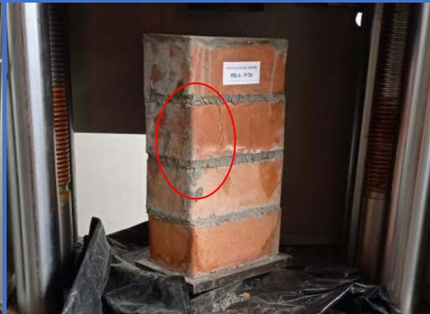
**Figura 140.** Pila de albañilería N°21-Dosf. (1:6+20%CH), muestra un tipo de falla por "Falla Ideal".
