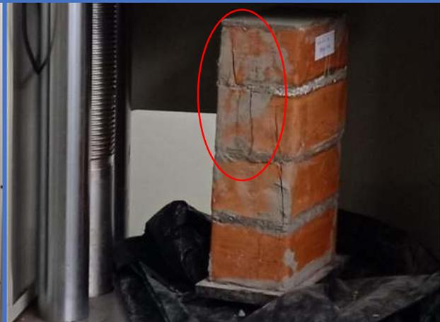
**Figura 110.** Pila de albañilería N°6-Dosf. (1:6+5%CH), muestra un tipo de falla por "Falla Ideal".
