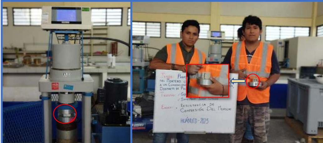
**Figura 161.** Mortero en Cubos de concreto N°28-Dosif. (1:6+20%C.H), soporta una resistencia de axial de (6.808 Mpa).
