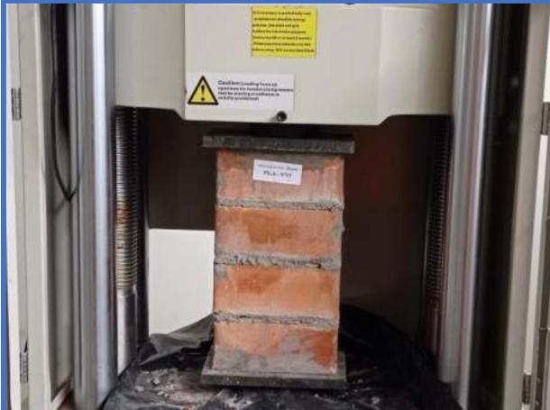
**Figura 121.** Pila de albañilería N°12-Dosf. (1:6+10%CH), soporta una resistencia de axial de (5.315 Mpa).
