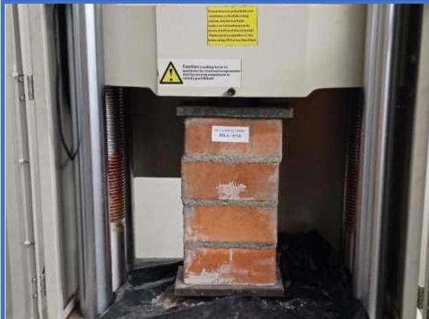
**Figura 117.** Pila de albañilería N°10-Dosf. (1:6+5%CH), soporta una resistencia de axial de (5.460 Mpa).
