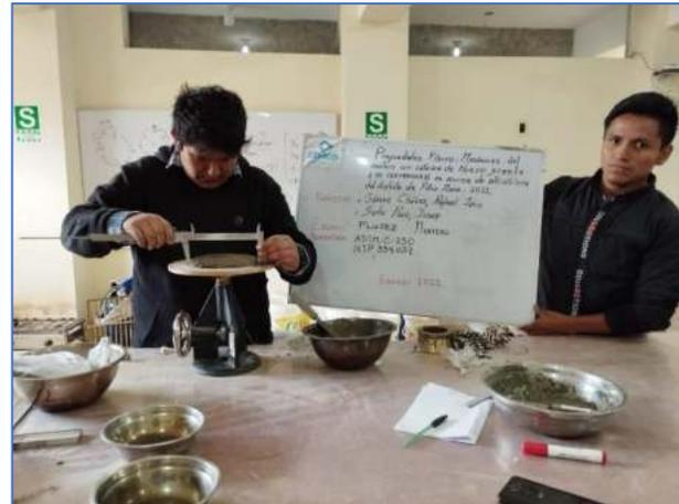
Nota. Retiro del cono después de un tiempo de 1 minuto del último compactado y medición en 4 direcciones del asentamiento del mortero. Autores: Gómez & Soto. Elaboración Propia.
