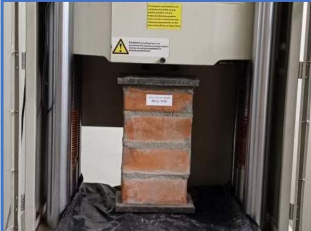
**Figura 133.** Pila de albañilería N°18-Dosf. (1:6+15%CH), soporta una resistencia de axial de (4.667 Mpa).
