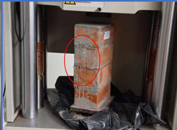
**Figura 120.** Pila de albañilería N°11-Dosf. (1:6+10%CH), muestra un tipo de falla por "Falla Ideal".
