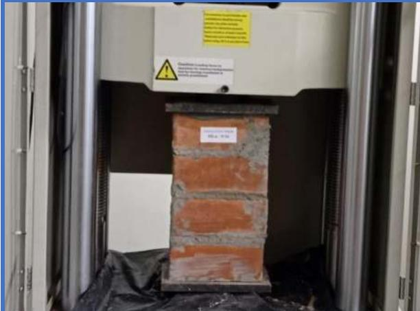
**Figura 135.** Pila de albañilería N°19-Dosf. (1:6+15%CH), soporta una resistencia de axial de (5.501 Mpa).
