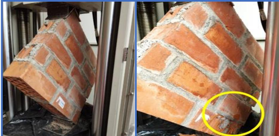
**Figura 177.** Muretes de concreto N°14 - Dosif. 1 : 6 + 10% C.H, falla por trituración local y soporta una resistencia al corte de 6.8kg/cm<sup>2</sup>.
