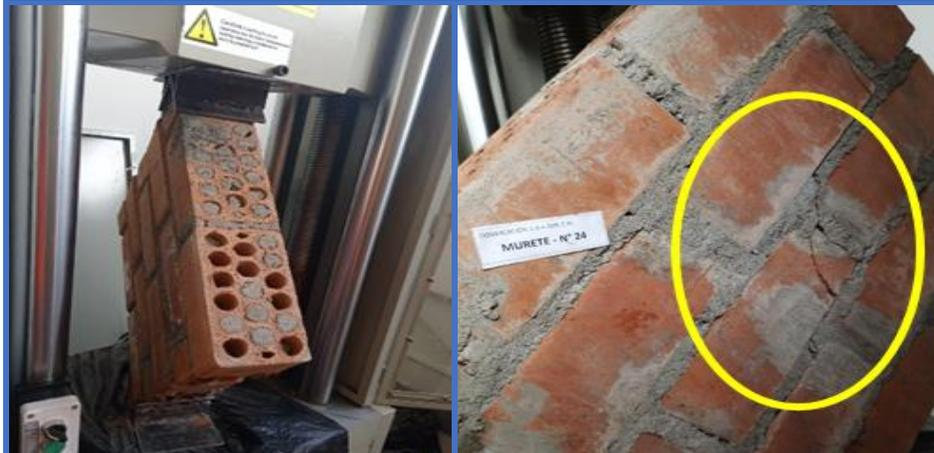
**Figura 187.** Muretes de concreto N°24 - Dosif. 1 : 6 + 20% C.H, falla mixta y soporta una resistencia al corte de 6.02kg/cm<sup>2</sup>.
