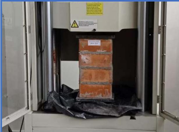
**Figura 111.** Pila de albañilería N°7-Dosf. (1:6+5%CH), soporta una resistencia de axial de (4.547 Mpa).
