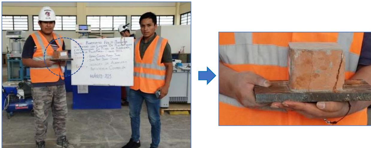
Nota. Resultado y falla del espécimen después del ensayo a compresión axial. Autores: Gómez & Soto. Elaboración Propia
