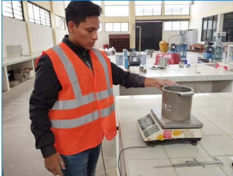
Nota. Peso del recipiente para el uso del ensayo del ensayo de peso unitario y compactado del agregado fino. Autores: Gómez & Soto. Elaboración Propia.
