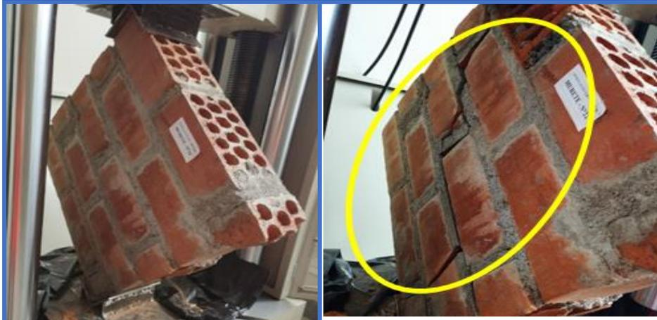
**Figura 185.** Muretes de concreto N°22 - Dosif. 1 : 6 + 20% C.H, falla escalonada y soporta una resistencia al corte de 5.56kg/cm<sup>2</sup>.
