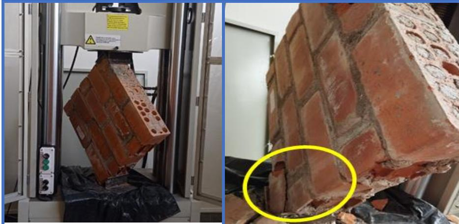
**Figura 170.** Muretes de concreto N°7 - Dosif. 1 : 6 + 5% C.H, falla por trituración local y soporta una resistencia al corte de 6.62kg/cm2.
