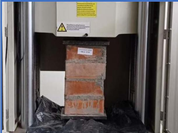
**Figura 125.** Pila de albañilería N°14-Dosf. (1:6+10%CH), soporta una resistencia de axial de (5.671 Mpa).
