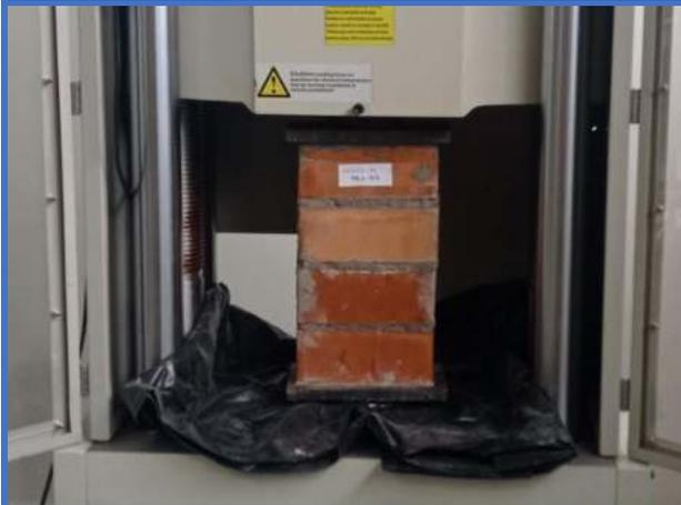
**Figura 105.** Pila de albañilería N°4-Dosf. (1:4), soporta una resistencia de axial de (7.261 Mpa).
