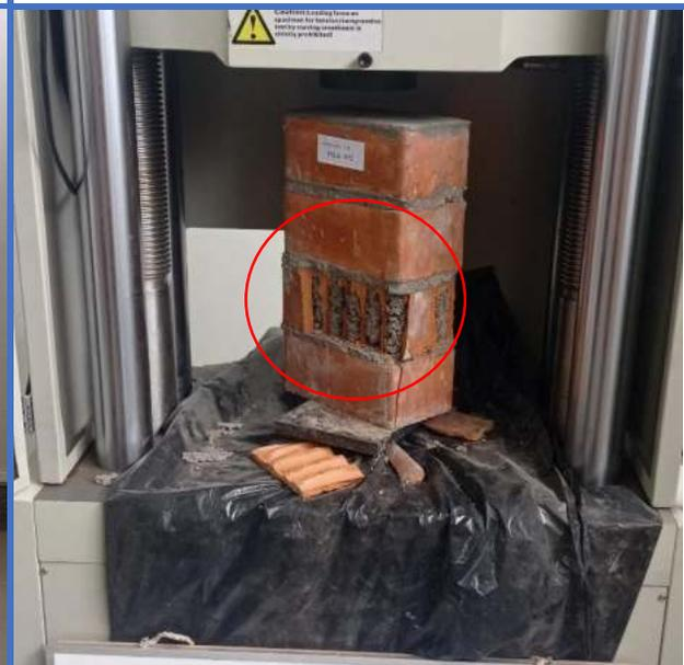
**Figura 102.** Pila de albañilería N°2-Dosf. (1:4), muestra un tipo de falla por "Trituración de Ladrillos".
