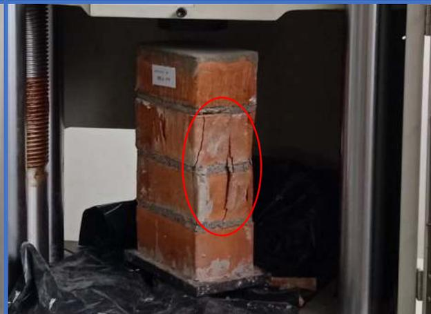
**Figura 108.** Pila de albañilería N°5-Dosf. (1:4), muestra un tipo de falla por “Falla ideal”.
