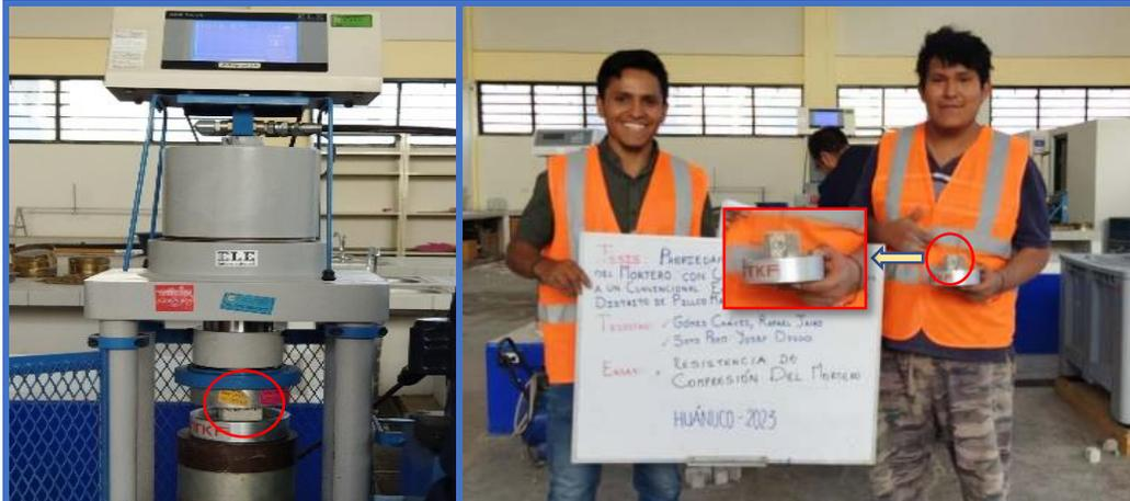
**Figura 155.** Mortero en Cubos de concreto N°22-Dosif. (1:6+10%C.H), soporta una resistencia de axial de (9.560 Mpa).
