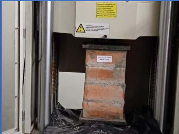
**Figura 127.** Pila de albañilería N°15-Dosf. (1:6+10%CH), soporta una resistencia de axial de (5.645 Mpa).
