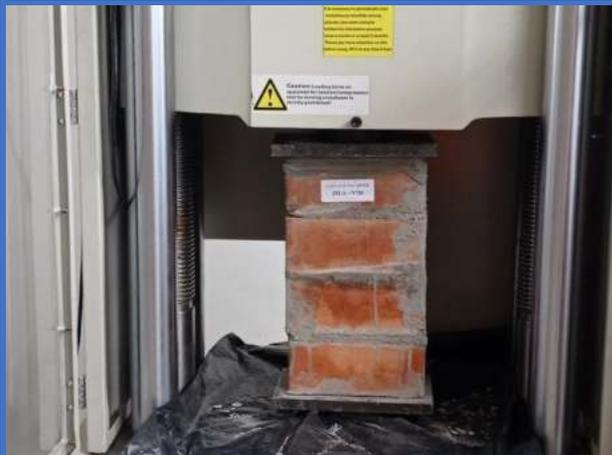
**Figura 147.** Pila de albañilería N°25-Dosf. (1:6+20%CH), soporta una resistencia de axial de (4.154 Mpa).
