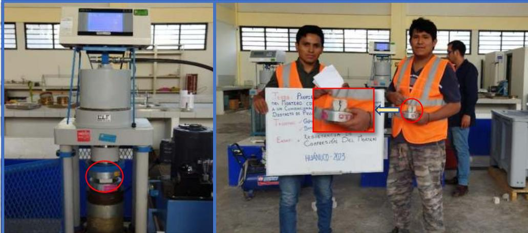
**Figura 156.** Mortero en Cubos de concreto N°23-Dosif. (1:6+10%C.H), soporta una resistencia de axial de (10.075 Mpa).
