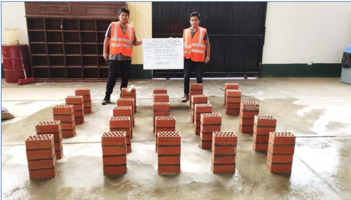
Nota. Curado de los especímenes manteniendo a una temperatura de  $24^{\circ} \pm 8^{\circ}\text{C}$ . Autores: Gómez & Soto. Elaboración Propia.
