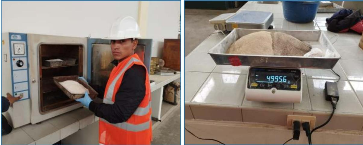
Nota. Colocación de la muestra (Cascara de huevo fino) en el horno a una temperatura de  $400^{\circ} \pm 50^{\circ}\text{C}$  y resultado de ser calcinada. Autores: Gómez & Soto. Elaboración Propia.
