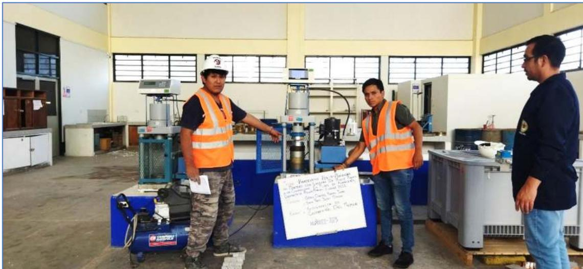
Nota. Colocación de los especímenes (Cubos de concreto) en la maquina a compresión axial.
