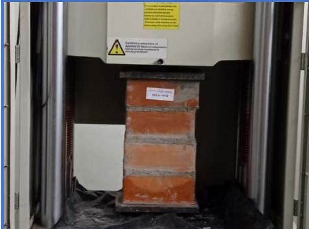
**Figura 129.** Pila de albañilería N°16-Dosf. (1:6+15%CH), soporta una resistencia de axial de (6.507 Mpa).
