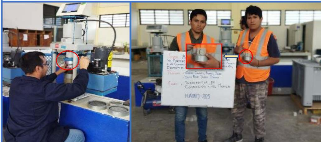
**Figura 157.** Mortero en Cubos de concreto N°24-Dosif. (1:6+10%C.H), soporta una resistencia de axial de (9.854 Mpa).
