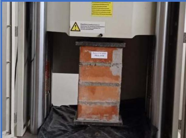
**Figura 143.** Pila de albañilería N°23-Dosf. (1:6+20%CH), soporta una resistencia de axial de (6.304 Mpa).
