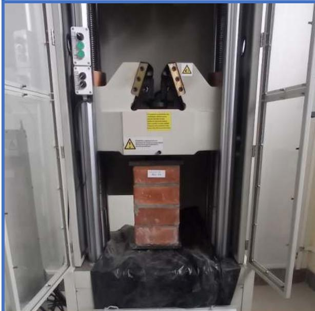
**Figura 99.** Pila de albañilería N°1-Dosf. (1:4), soporta una resistencia de axial de (4.75 Mpa).
