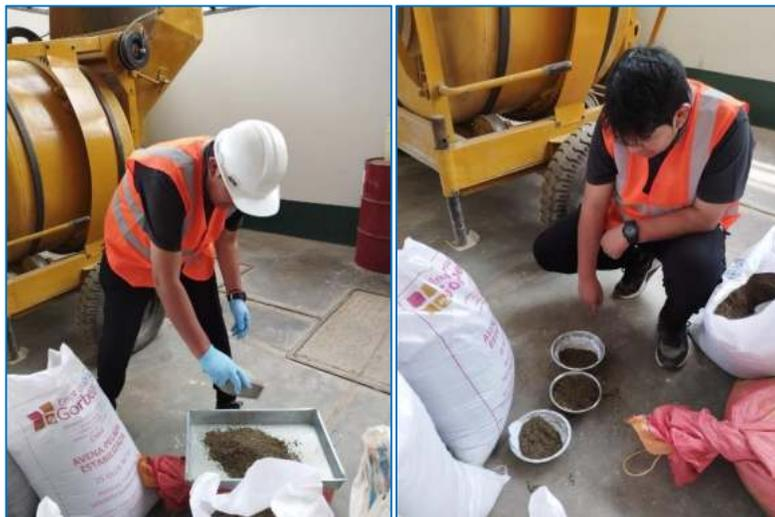
Nota. Separación de la muestra extraída de la cantera sin alteraciones para el ensayo del contenido de humedad. Autores: Gómez & Soto. Elaboración Propia.
