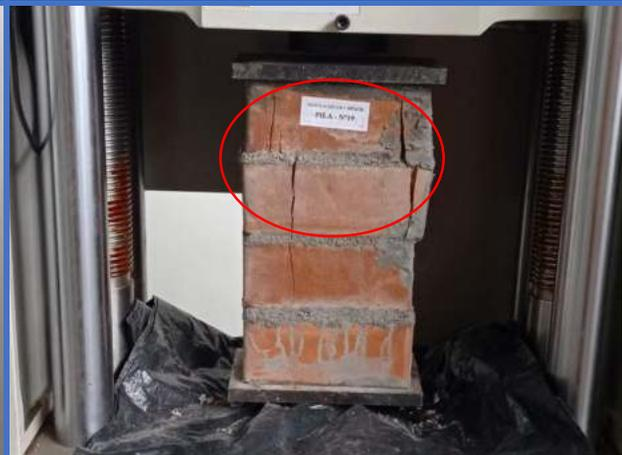
**Figura 126.** Pila de albañilería N°14-Dosf. (1:6+10%CH), muestra un tipo de falla por “Ladrillo ranurados”.
