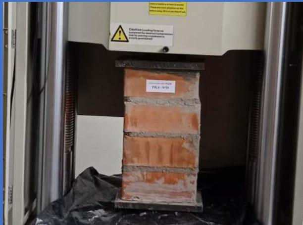
**Figura 145.** Pila de albañilería N°24-Dosf. (1:6+20%CH), soporta una resistencia de axial de (3.795 Mpa).
