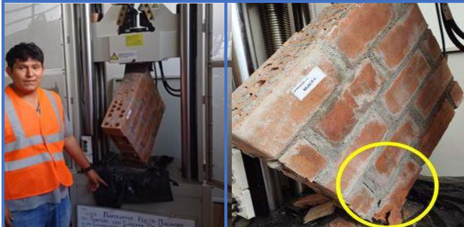
**Figura 167.** Muretes de concreto N°4 - Dosif. 1 : 4, falla por trituración local y soporta una resistencia al corte de 7.95kg/cm<sup>2</sup>.
