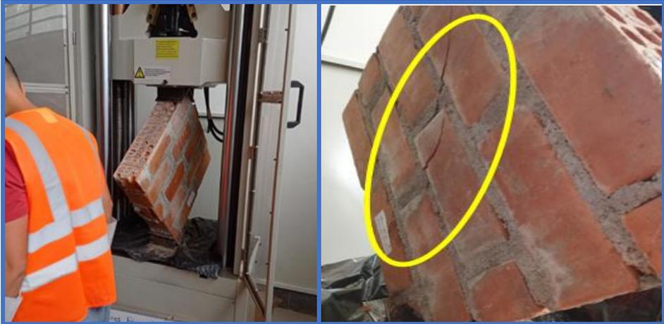
**Figura 188.** Muretes de concreto N°25 - Dosif. 1 : 6 + 20% C.H, falla por traccion diagonal y soporta una resistencia al corte de 5.4kg/cm2.
