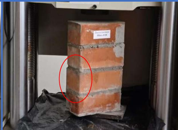
**Figura 144.** Pila de albañilería N°23-Dosf. (1:6+20%CH), muestra un tipo de falla por "Falla Ideal".
