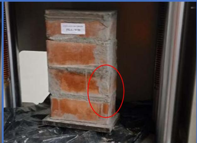
**Figura 148.** Pila de albañilería N°25-Dosf. (1:6+20%CH), muestra un tipo de falla por "Falla Ideal".
