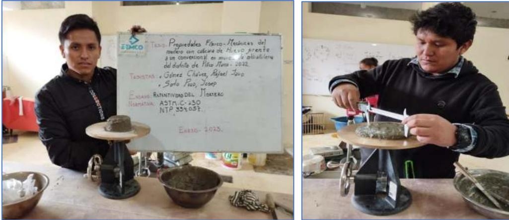
Nota. Retiro del cono después de un tiempo de 1 minuto del último compactado y medición en 4 direcciones del asentamiento del mortero. Autores: Gómez & Soto. Elaboración Propia.
