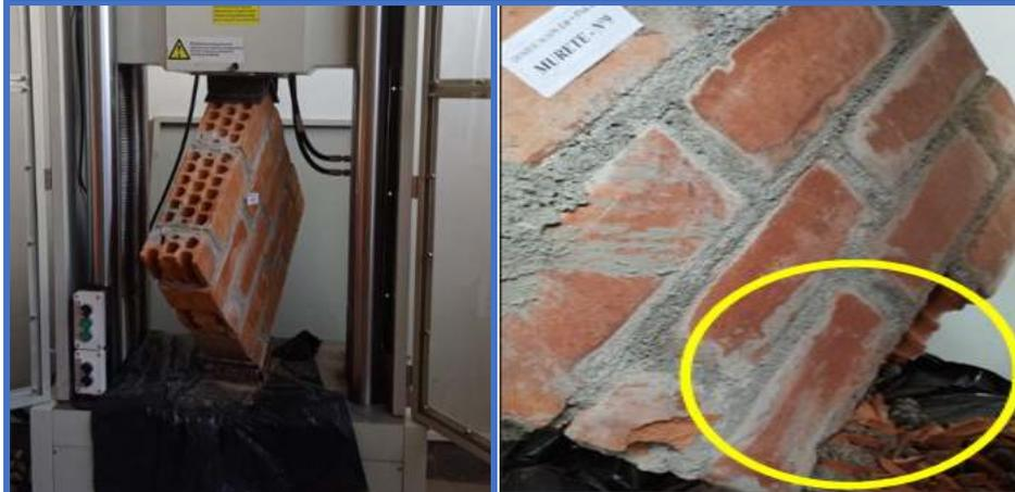
**Figura 172.** Muretes de concreto N°9 - Dosif. 1 : 6 + 5% C.H, falla por trituración local y soporta una resistencia al corte de 7.02kg/cm2.
