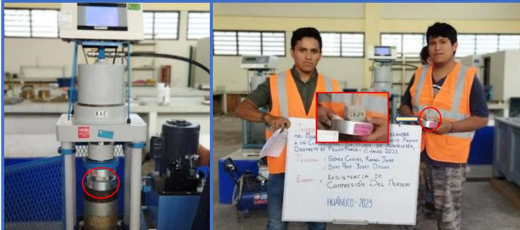
**Figura 162.** Mortero en Cubos de concreto N°29-Dosif. (1:6+20%C.H), soporta una resistencia de axial de (9.346 Mpa).
