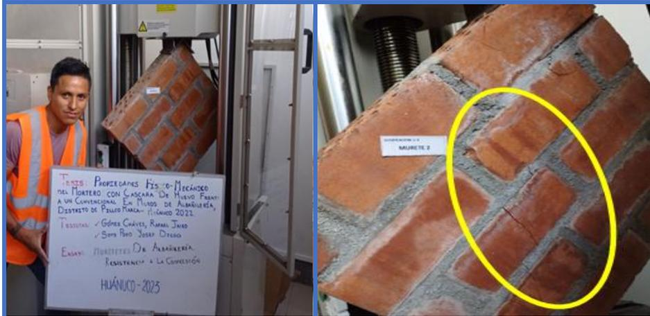
**Figura 165.** Muretes de concreto N°2 – Dosif. 1 : 4, falla mixta y soporta una resistencia al corte de 7.17kg/cm2.
