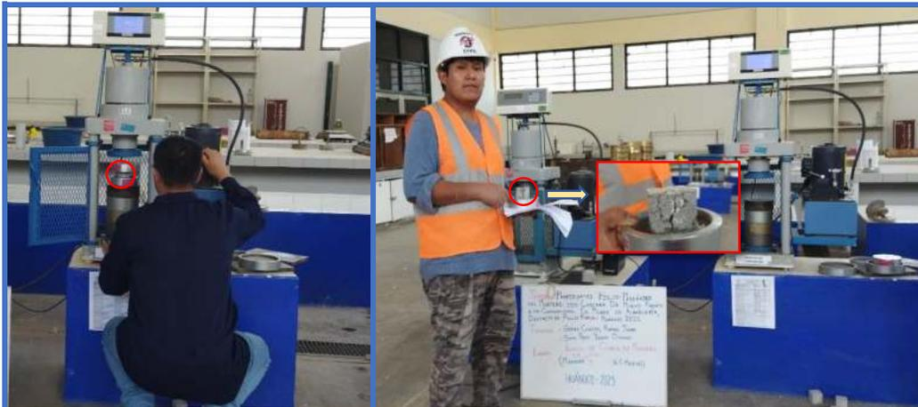
**Figura 149.** Mortero en Cubos de concreto N°16 - Dosificación. (1:4), soporta una resistencia de axial de (8.986 Mpa).
