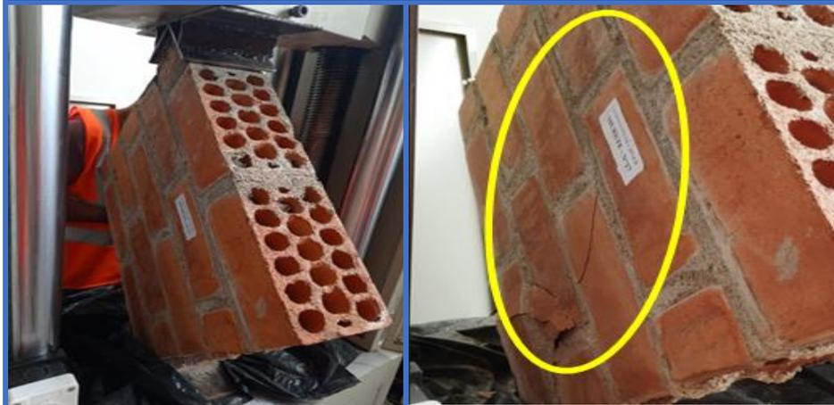
**Figura 180.** Muretes de concreto N°17 - Dosif. 1 : 6 + 15% C.H, falla por traccion diagonal y soporta una resistencia al corte de 6.26kg/cm<sup>2</sup>.
