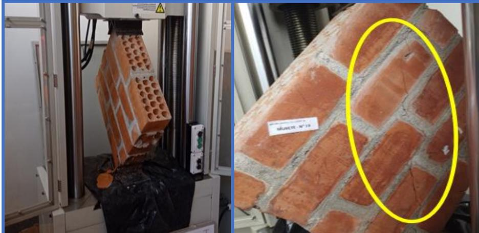
**Figura 182.** Muretes de concreto N°19 - Dosif. 1 : 6 + 15% C.H, falla mixta y soporta una resistencia al corte de 5.35kg/cm<sup>2</sup>.
