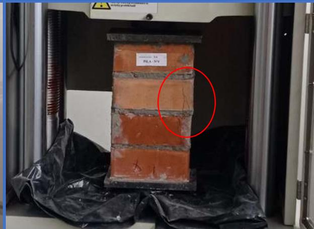
**Figura 106.** Pila de albañilería N°4-Dosf. (1:4), muestra un tipo de falla por “Ladrillos ranurados” y “Falla Ideal”.
