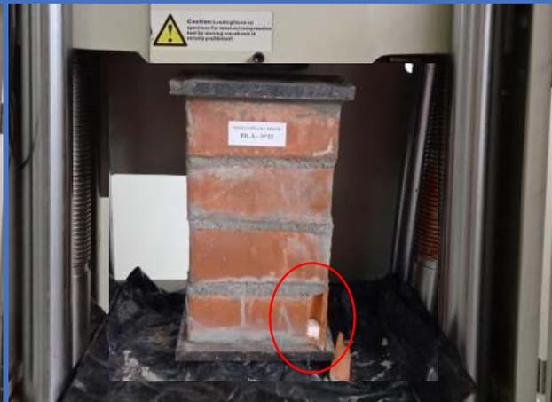
**Figura 132.** Pila de albañilería N°17-Dosf. (1:6+15%CH), muestra un tipo de falla por ‘Ladrillo ranurado’ ‘Trituración de Ladrillos’.
