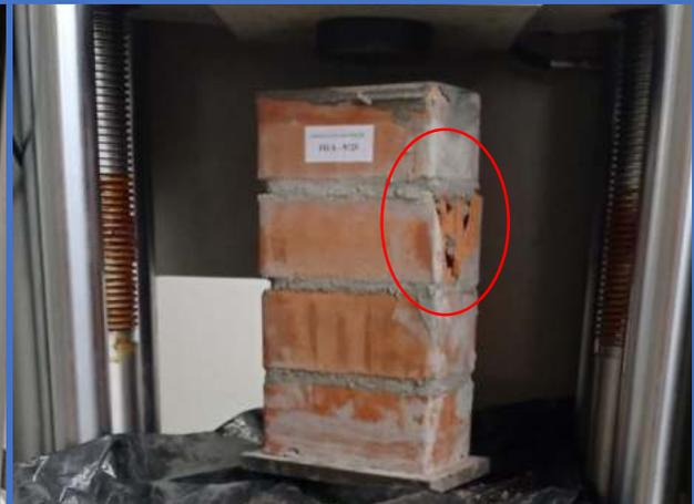
**Figura 146.** Pila de albañilería N°24-Dosf. (1:6+20%CH), muestra un tipo de falla por "Falla Ideal".
