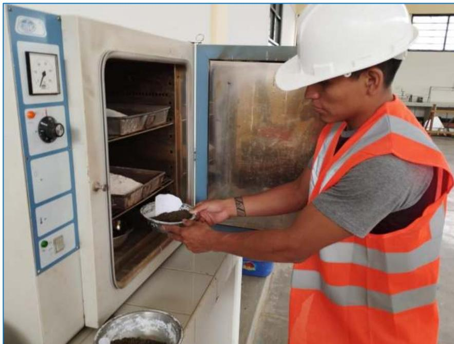
Nota. Colocación de la muestra sin alteraciones al horno a una temperatura de  $110^{\circ} \pm 5^{\circ}\text{C}$ .
