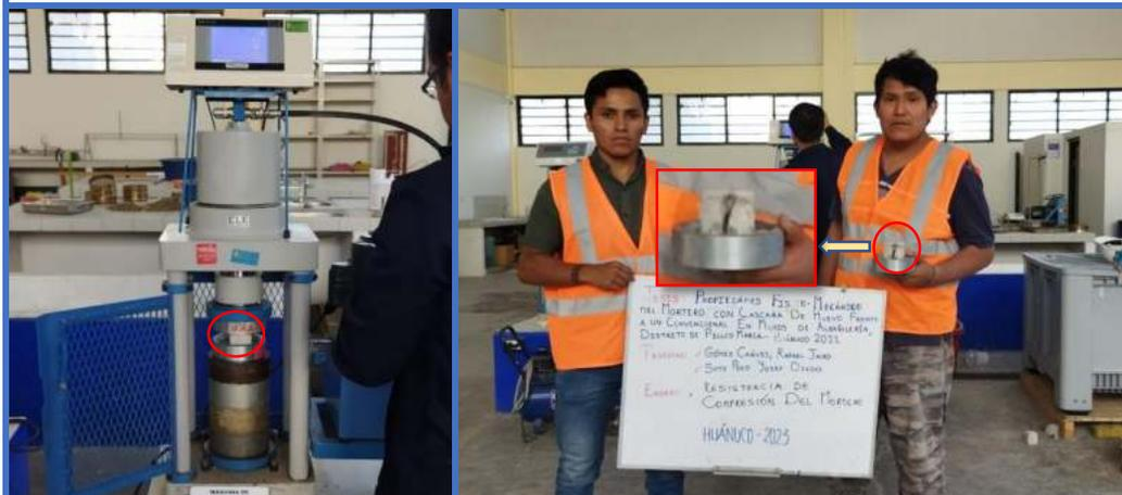
**Figura 154.** Mortero en Cubos de concreto N°21-Dosificación (1:6+5%C.H), soporta una resistencia de axial de (8.079 Mpa).
