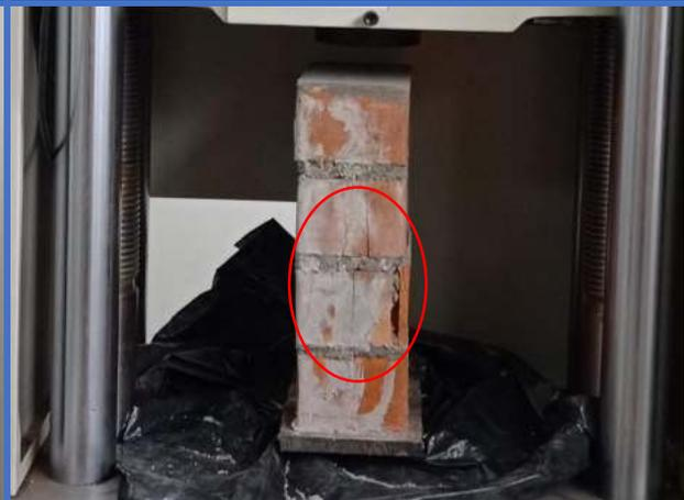
**Figura 114.** Pila de albañilería N°8-Dosf. (1:6+5%CH), muestra un tipo de falla por "Falla Ideal".
