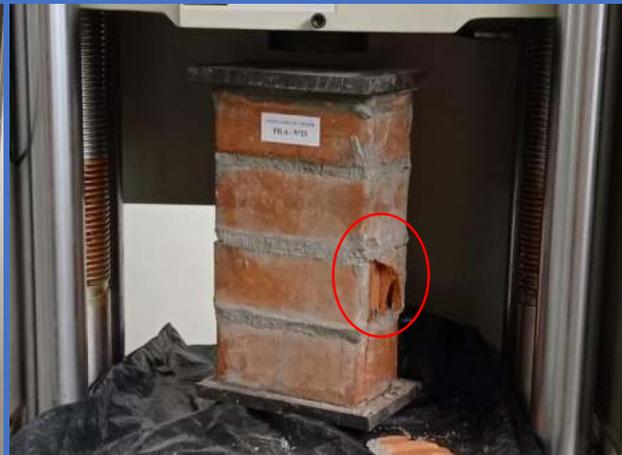
**Figura 134.** Pila de albañilería N°18-Dosf. (1:6+15%CH), muestra un tipo de falla por "Falla Ideal".
