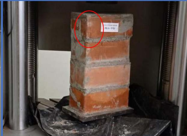
**Figura 130.** Pila de albañilería N°16-Dosf. (1:6+15%CH), muestra un tipo de falla por ‘Falla Ideal’ y ‘Ladrillo ranurados’.
