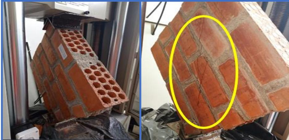
**Figura 183.** Muretes de concreto N°20 - Dosif. 1 : 6 + 15% C.H, falla por traccion diagonal y soporta una resistencia al corte de 5.85kg/cm<sup>2</sup>.
