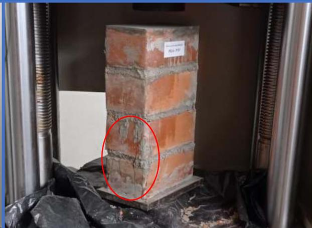
**Figura 142.** Pila de albañilería N°22-Dosf. (1:6+20%CH), muestra un tipo de falla por "Falla Ideal".
