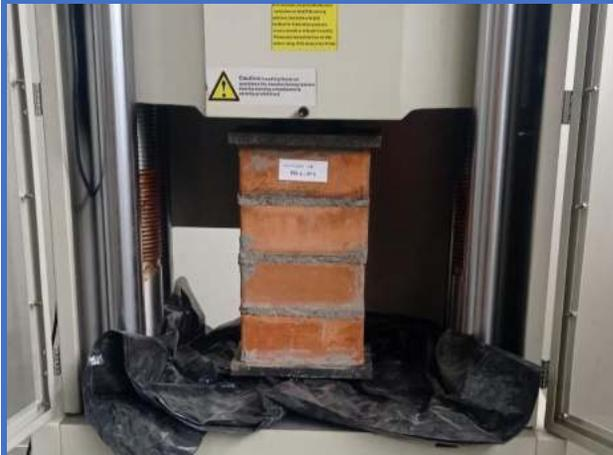
**Figura 103.** Pila de albañilería N°3-Dosf. (1:4), soporta una resistencia de axial de (8.283 Mpa).
