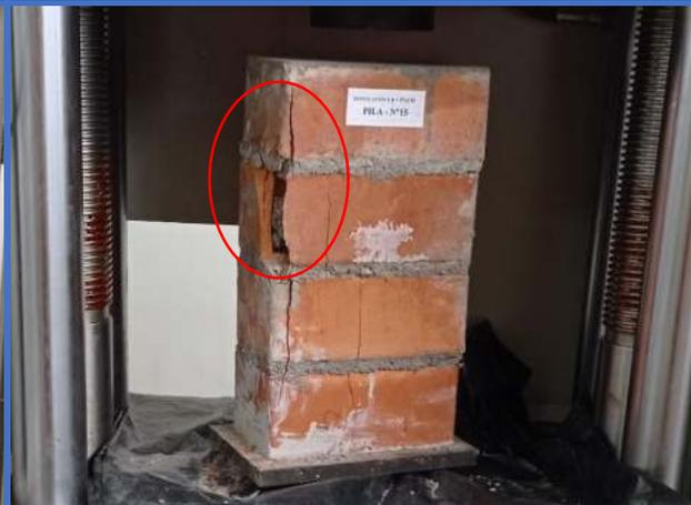
**Figura 118.** Pila de albañilería N°10-Dosf. (1:6+5%CH), muestra un tipo de falla por "Ladrillo ranurados" y "Falla Ideal".
