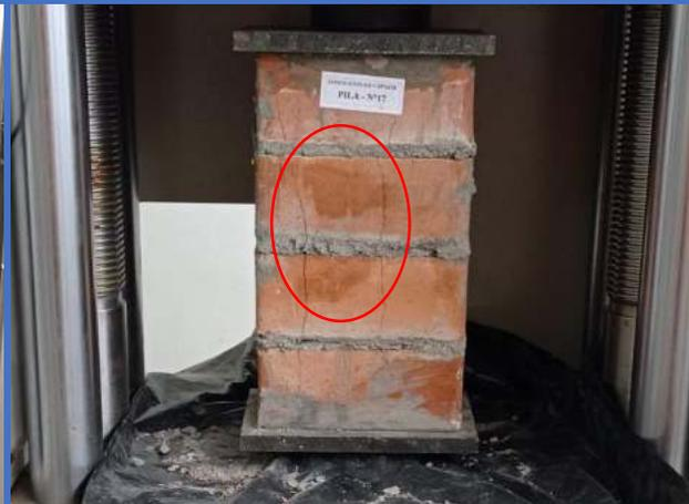
**Figura 122.** Pila de albañilería N°12-Dosf. (1:6+10%CH), muestra un tipo de falla por “Ladrillo ranurados”.
