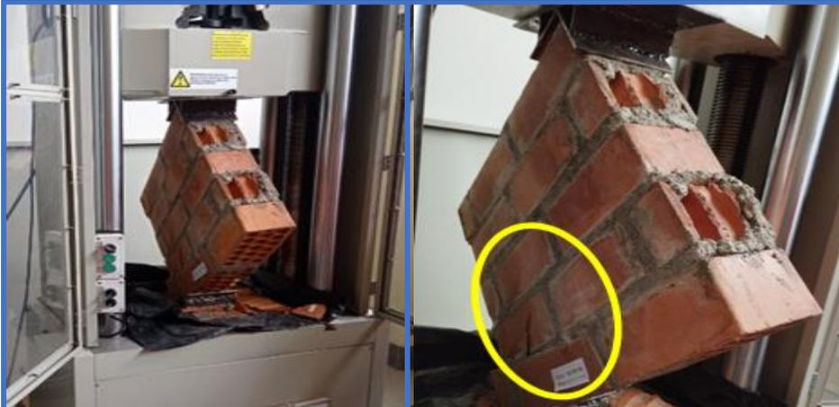
**Figura 175.** Muretes de concreto N°12 - Dosif. 1 : 6 + 10% C.H, falla mixta y soporta una resistencia al corte de 6.34kg/cm<sup>2</sup>.
