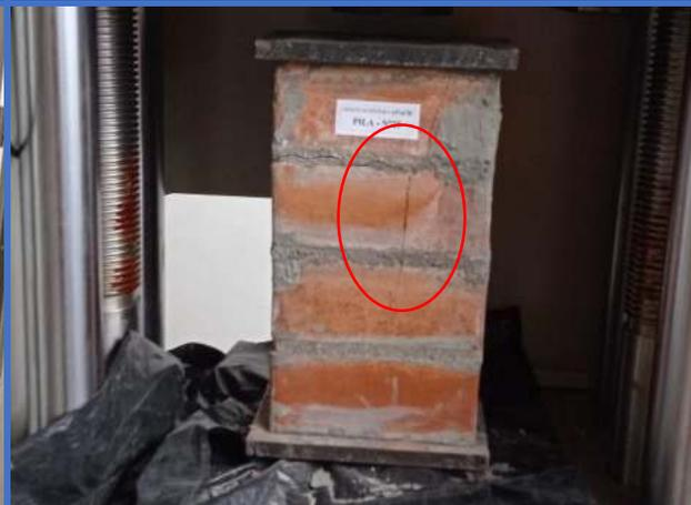
**Figura 138.** Pila de albañilería N°20-Dosf. (1:6+15%CH), muestra un tipo de falla por "Ladrillo ranurado"
