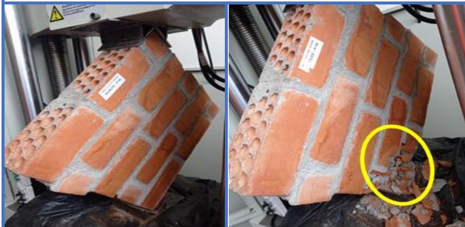
**Figura 181.** Muretes de concreto N°18 - Dosif. 1 : 6 + 15% C.H, falla por trituración local y soporta una resistencia al corte de 5.52kg/cm<sup>2</sup>.
