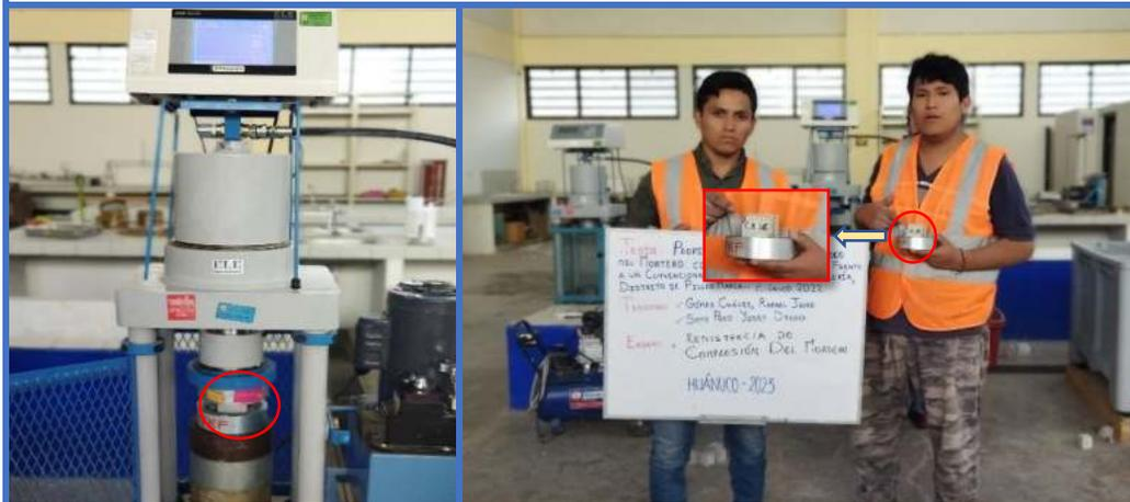
**Figura 159.** Mortero en Cubos de concreto N°26-Dosif. (1:6+15%C.H), soporta una resistencia de axial de (8.622 Mpa).
