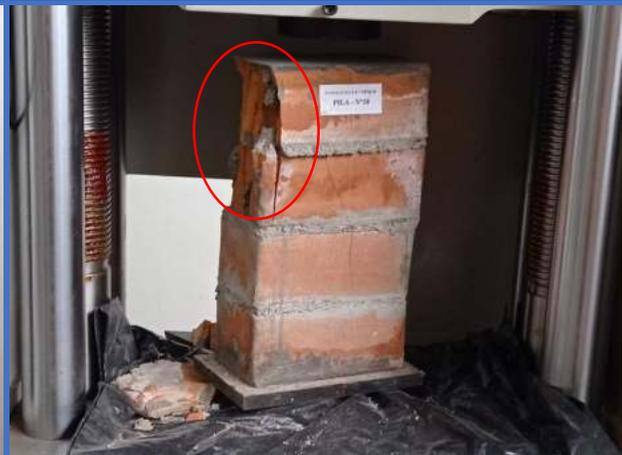
**Figura 124.** Pila de albañilería N°13-Dosf. (1:6+10%CH), muestra un tipo de falla por “Ladrillo ranurado” “Trituración de Ladrillos”.
