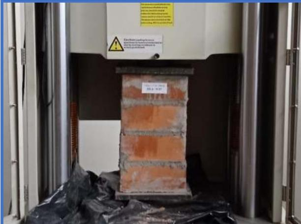
**Figura 141.** Pila de albañilería N°22-Dosf. (1:6+20%CH), soporta una resistencia de axial de (3.998 Mpa).
