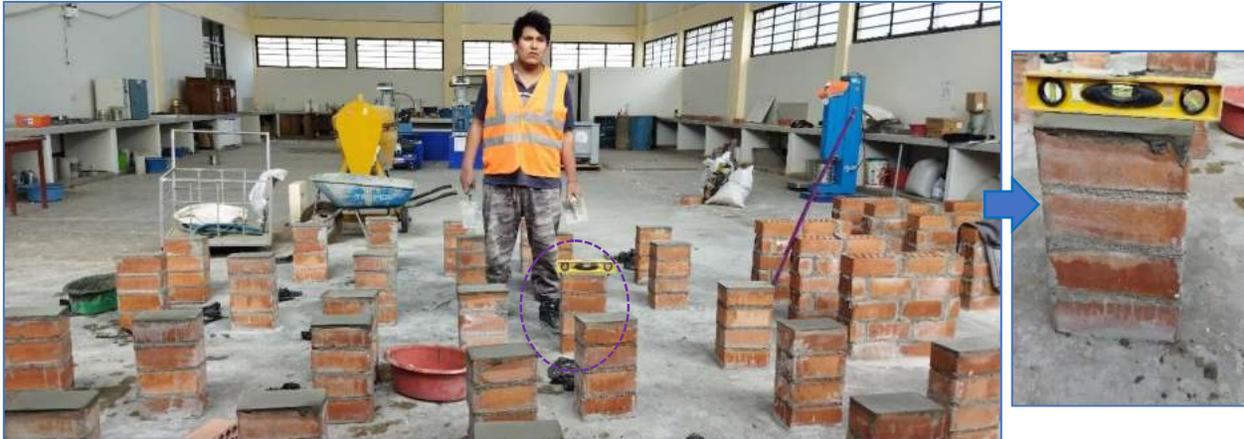
Nota. Proceso de refrenado de yeso - cemento en la parte superior e inferior de las pilas de albañilería. Autores: Gómez & Soto. Elaboración Propia.
