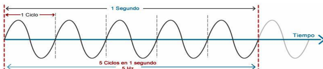
Figura 1. Representación gráfica de la unidad de medida "hercio" o "hertzio". Fuente: http://iris.hdplus.es/dictionary/hercio-hz/
