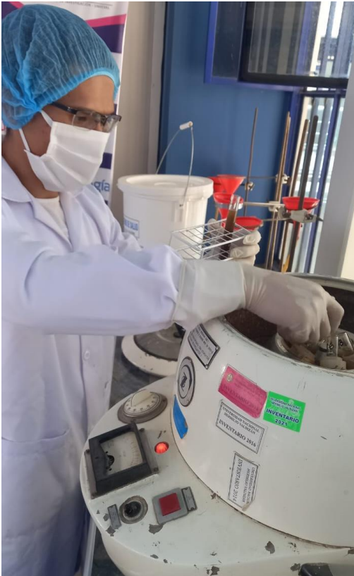
Fotografía 9. Centrifugar la suspensión a 1.500 rpm por un tiempo sobrenadante de 3 minutos.
