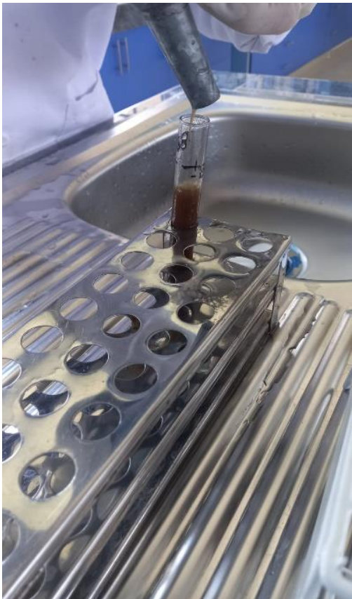
Fotografía 7. Filtrar 15 ml de suspensión a través de un colador en un tubo de ensayo.
