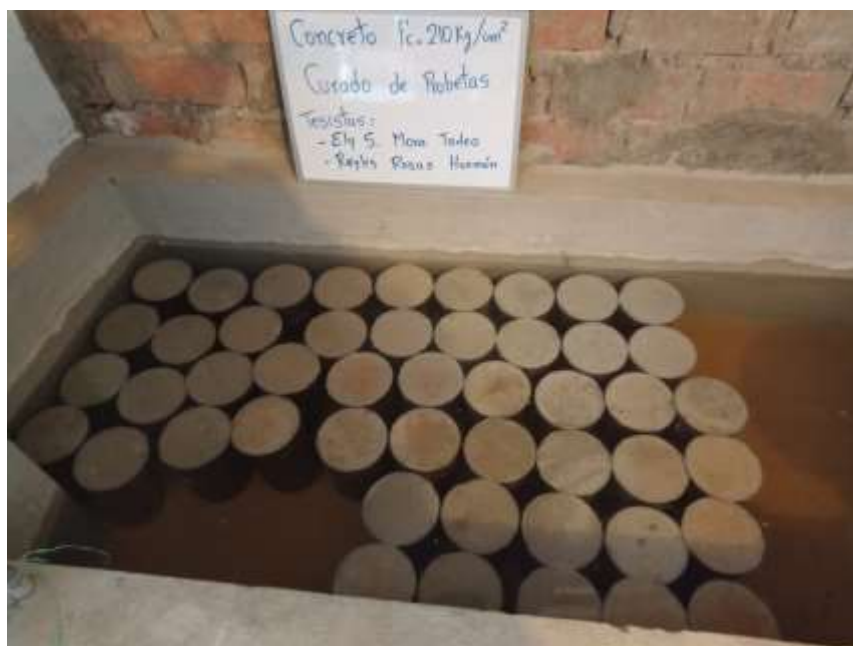
Figura 14 Curado por inmersión de probetas
