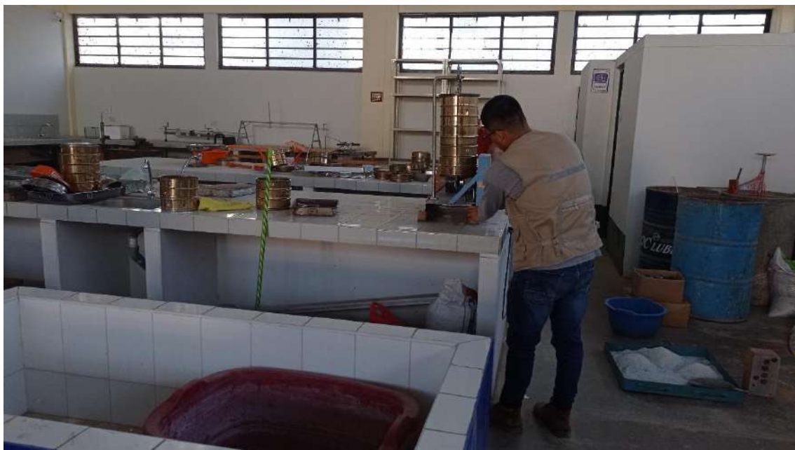
Fotografía 11 Tamizado del vidrio triturado.
