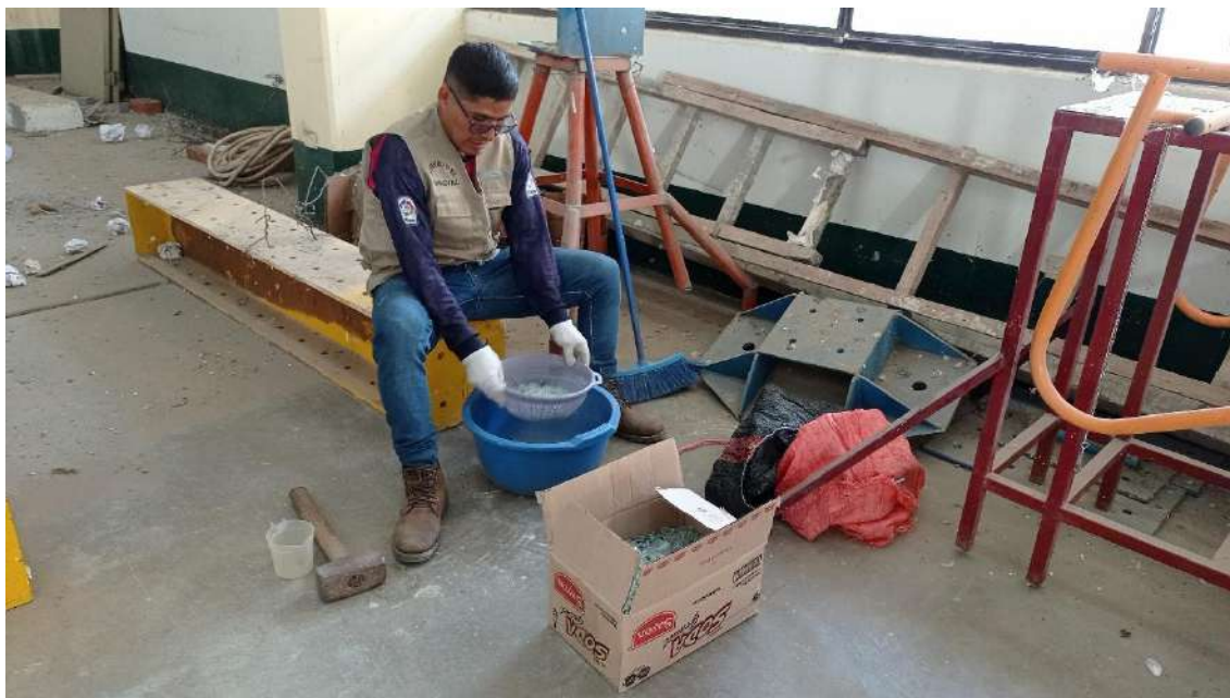
Fotografía 2 Triturado de vidrio manualmente
