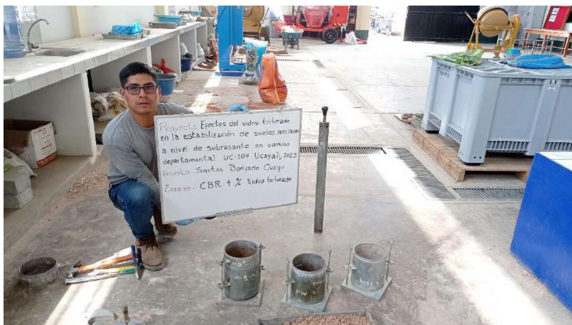
Fotografía 22 compactación manual de muestra
