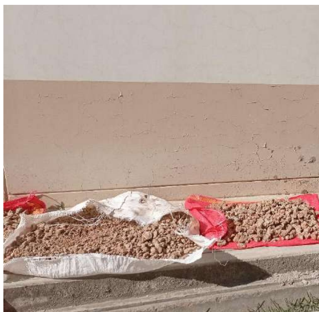
Fotografía 9 Secado del material arcilloso de la calicata N° 01 y N° 02
