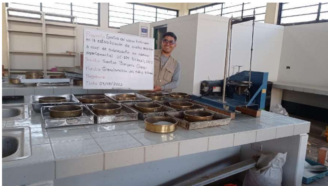
Fotografía 12 Granulometría del vidrio triturado
