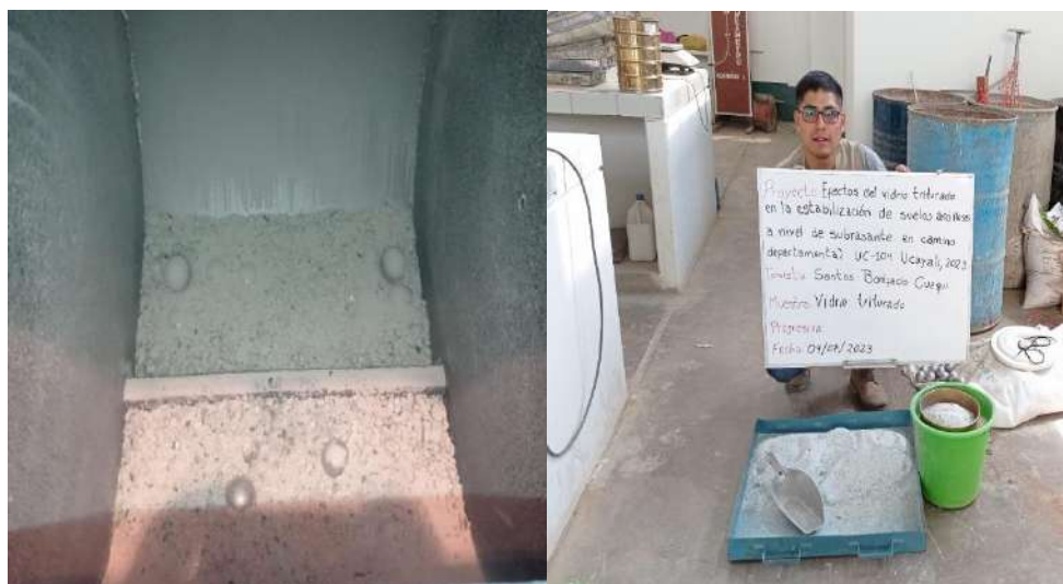
Fotografía 3 y 4 Triturado de vidrio en Máquina de los Ángeles
