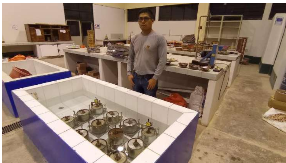
Figura 29. Preparación de Moldes a 55, 26 y 12 golpes, al 8%, 12% y 16% de Vidrio Triturado.
