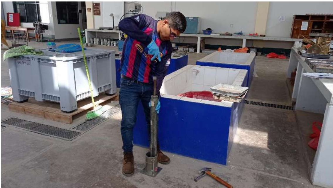
Fotografía 19 Preparación y compactación manual.
