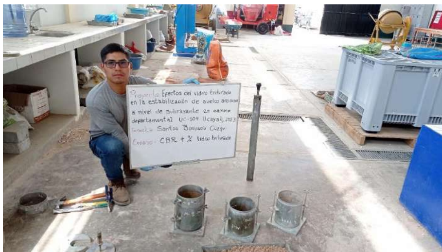
Figura 28. Preparación de Moldes a 55, 26 y 12 golpes, al 12% de Vidrio Triturado.
