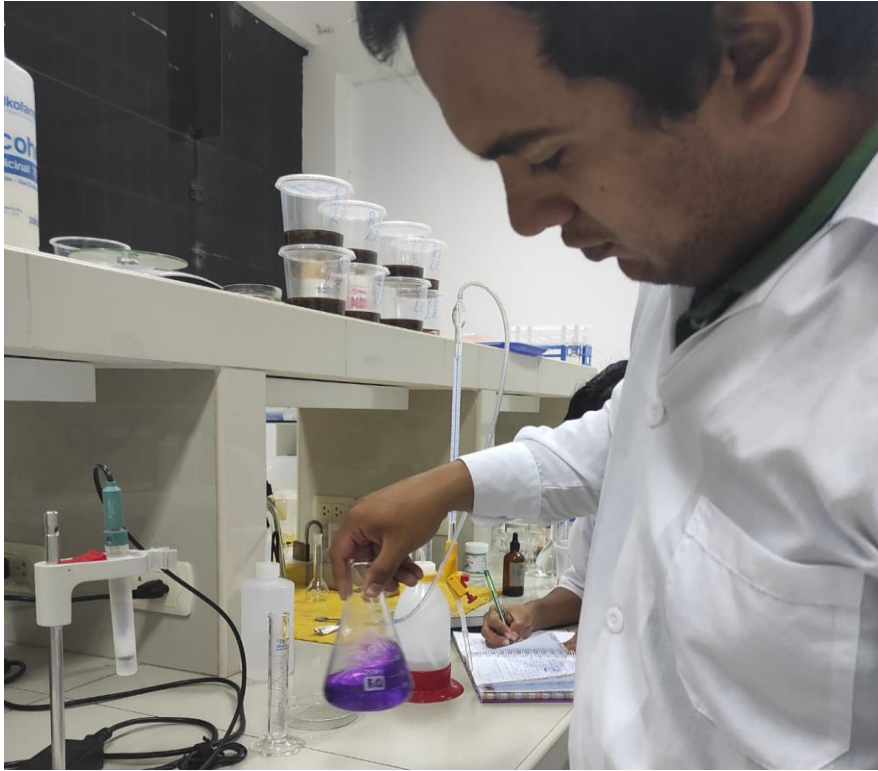
Figura 22. Determinación del contenido de metoxilo y peso equivalente del hidrocoloide
