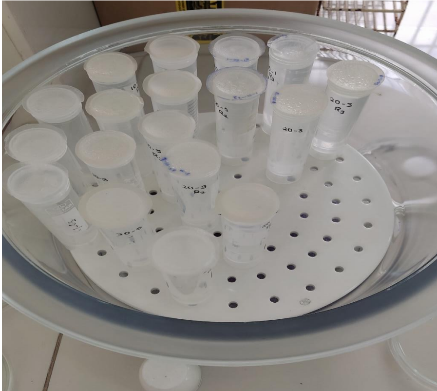
Figura 26. Evaluación de permeabilidad al vapor de agua a partir de hidrocoloide de mesocarpio de granadilla.
