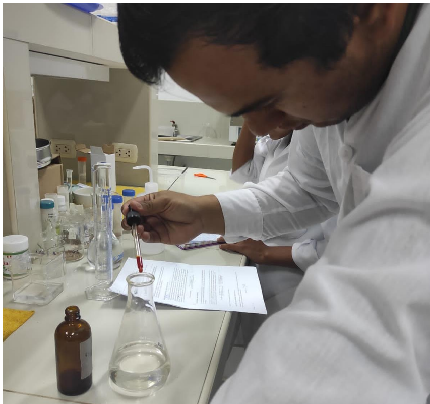
Figura 23. Determinación del contenido de metoxilo y peso equivalente del hidrocoloide
