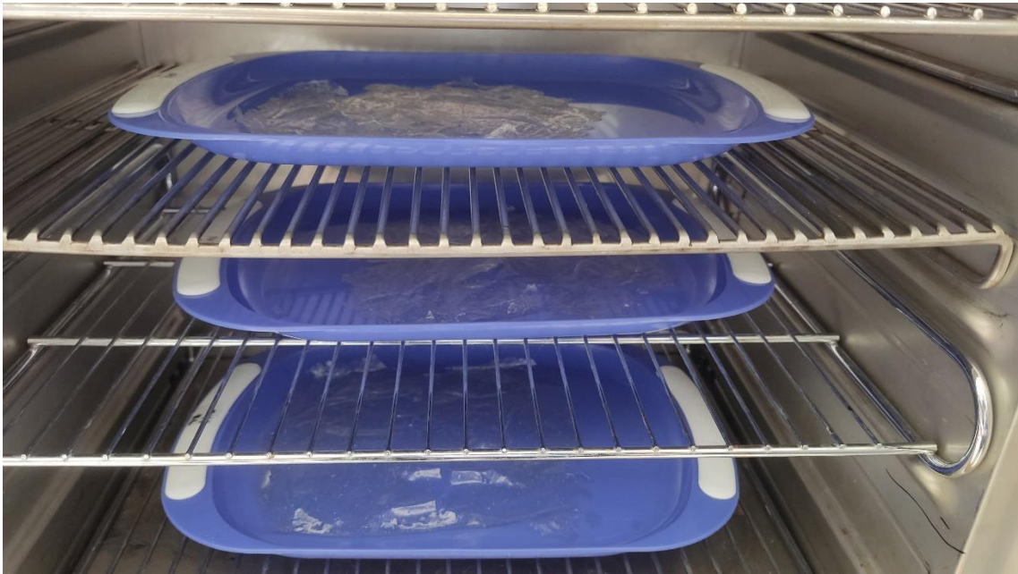
Figura 16. Secado del hidrocoloide de mesocarpio de granadilla a diferentes tiempos y pH
