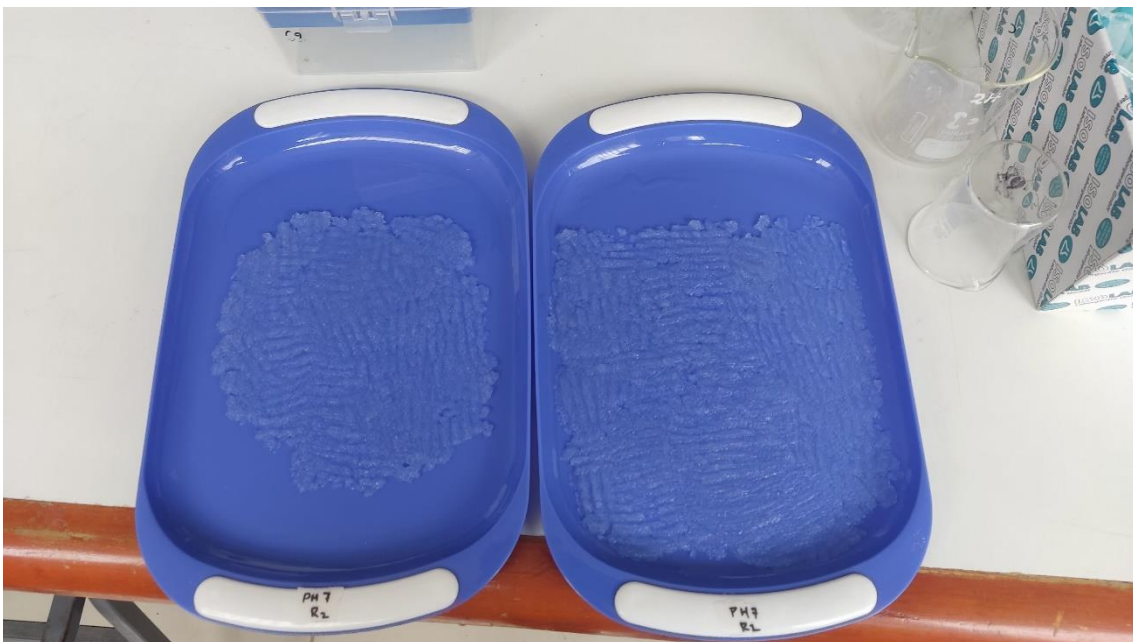
Figura 15. Acondicionado del hidrocoloide de mesocarpio de granadilla a diferentes tiempos y pH
