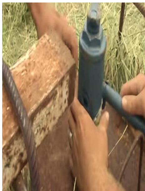
Figura N° 35: Colocado de tubo cuadrado de 2"x3" para presionar el Stipa Ichu .
