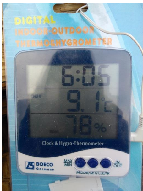
Figura N° 26: Toma de medida de Temperatura y Humedad.
