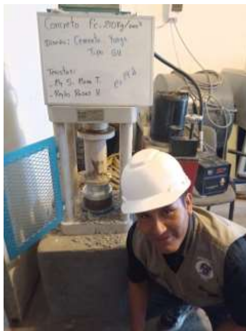
Figura 24 Compresión del concreto. Cemento Yunga tipo GU, e=14d
