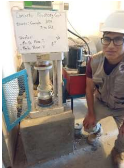
Figura 20 Compresión del concreto. Cemento Yunga tipo GU, e=7d
