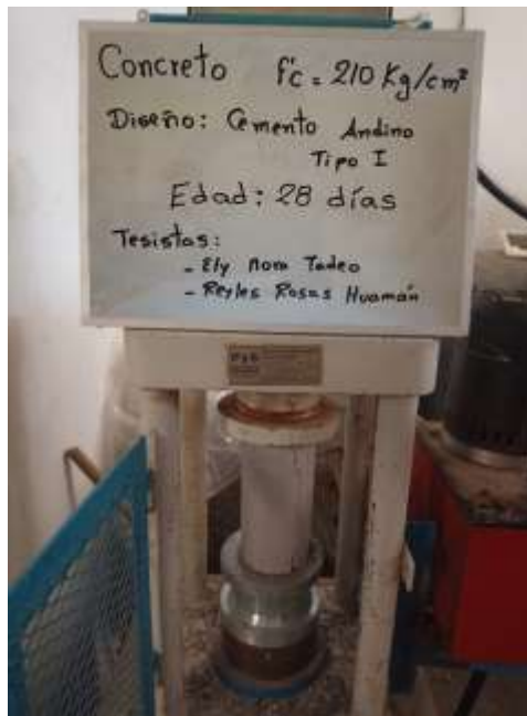
Figura 26 Compresión del concreto. Cemento Yunga tipo I, e=28d
