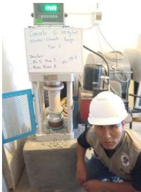
Figura 26 Compresión del concreto. Cemento Yunga tipo I, e=28d
