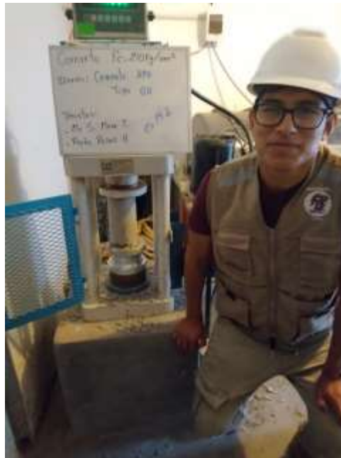
Figura 24 Compresión del concreto. Cemento Yunga tipo GU, e=14d
