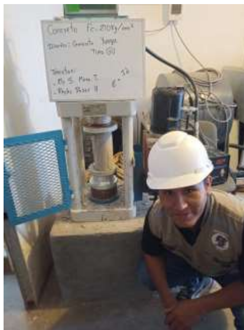
Figura 20 Compresión del concreto. Cemento Yunga tipo GU, e=7d
