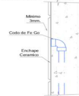
Figura 176 Salida de Punto de Agua
