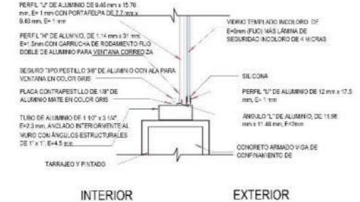
DETALLE 9 1:5 CORTE VERTICAL PAÑOS FIJOS con vidrio templado reflectivo bronce e=6mm más lámina de seguridad incoloro de 4 micras, con marco de aluminio.
