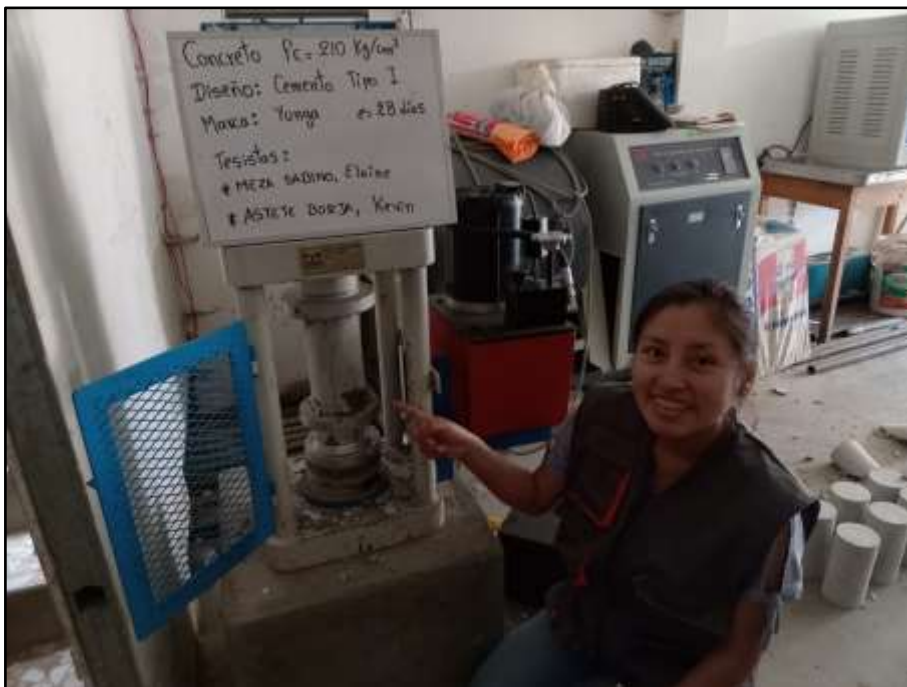
Figura 40 Resistencia a compresión. Yunga tipo I. Edad=28d. a/c=0.57
