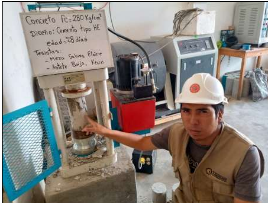
Figura 46 Resistencia a compresión. Cemex tipo HE. Edad=28d. a/c=0.40
