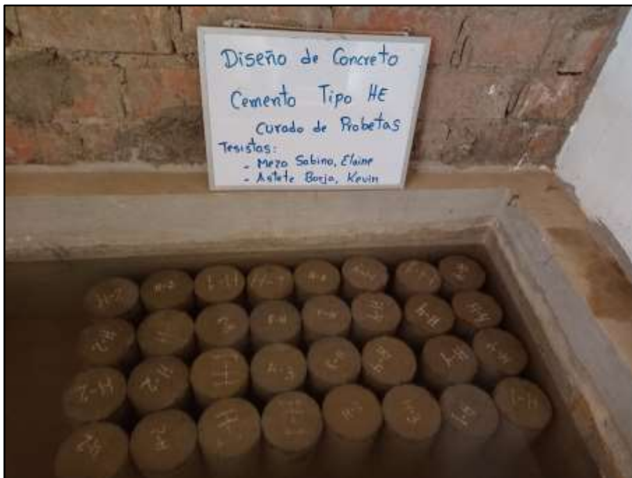
Figura 22 Curación de probetas hechas con cemento Cemex tipo HE.
