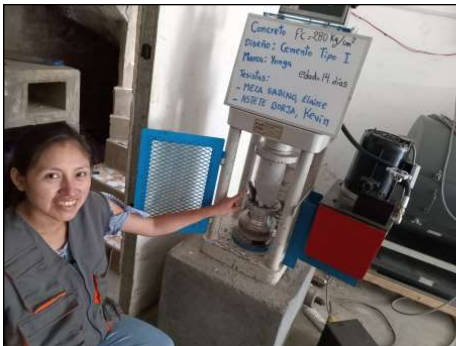
Figura 34 Resistencia a compresión. Yunga tipo I. Edad=14d. a/c=0.40
