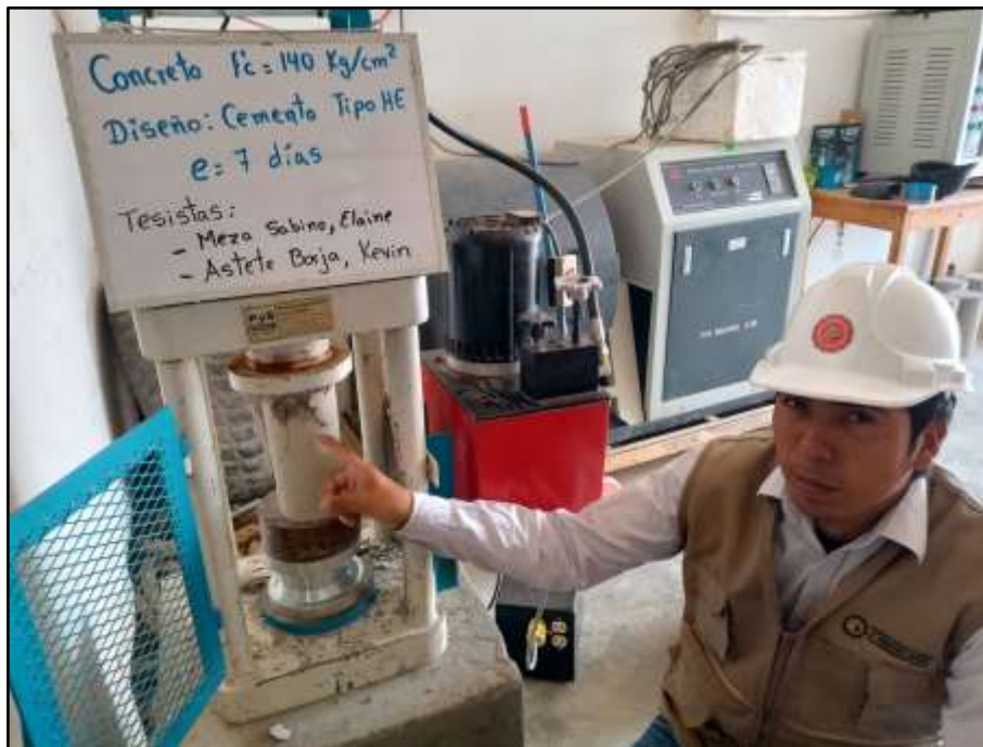
Figura 28 Resistencia a compresión. Cemex tipo HE. Edad=7d. a/c=0.57
