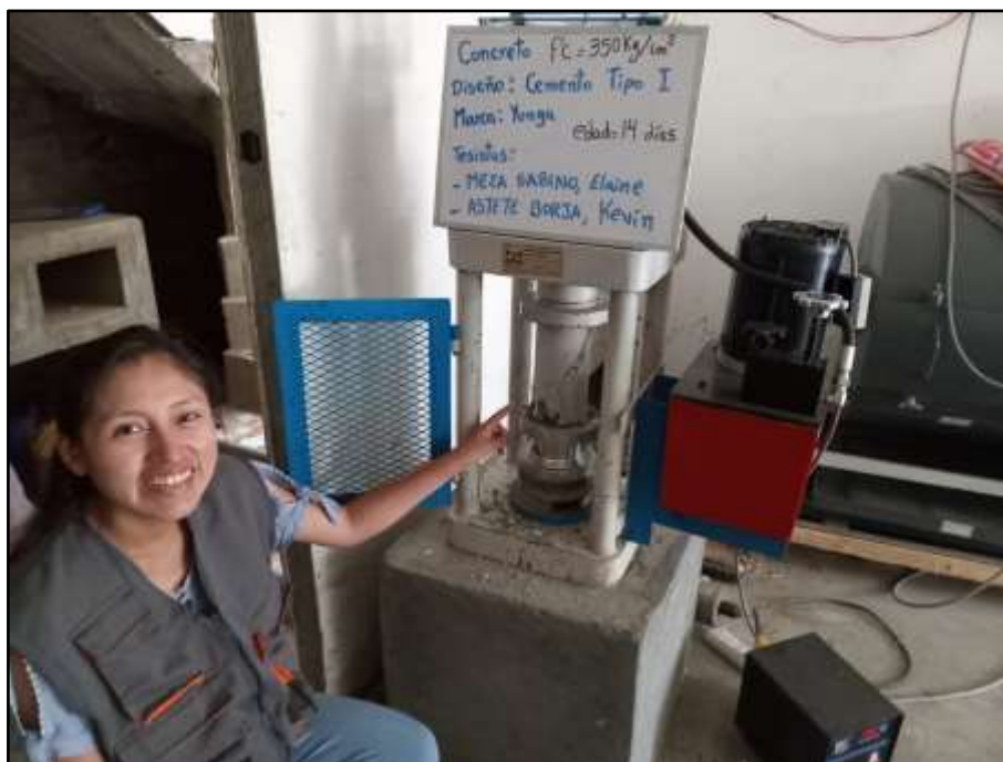
Figura 34 Resistencia a compresión. Yunga tipo I. Edad=14d. a/c=0.40
