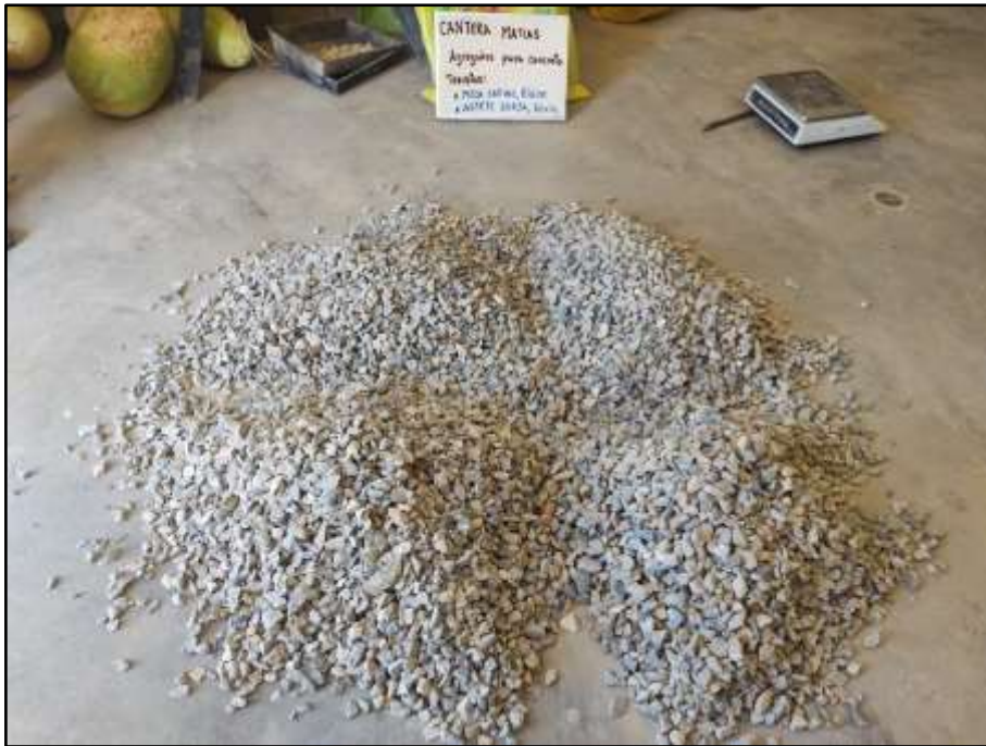
Figura 5 Cuarteo del agregado fino.
