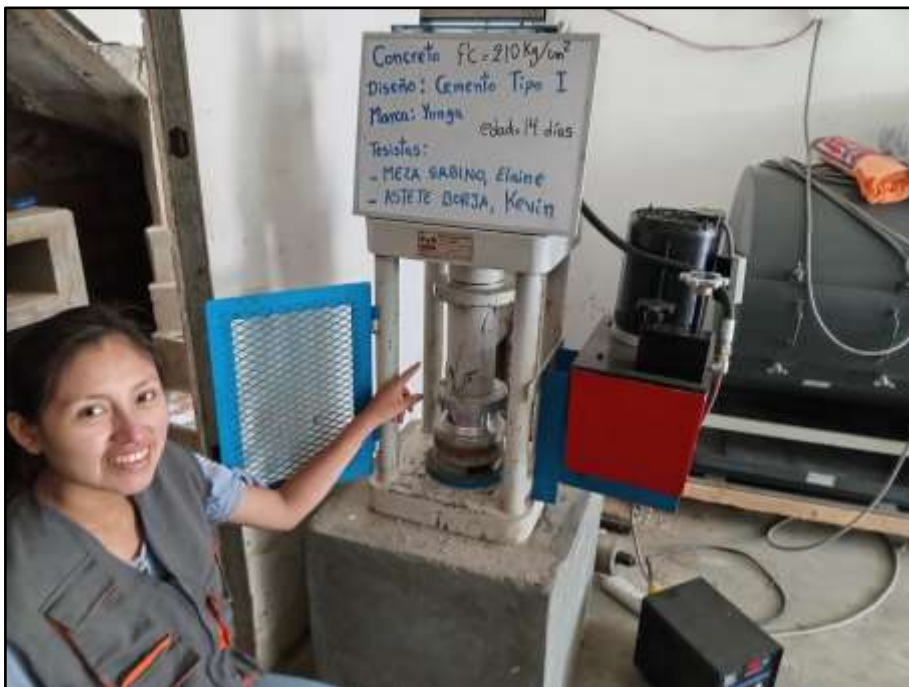
Figura 32 Resistencia a compresión. Yunga tipo I. Edad=14d. a/c=0.57
