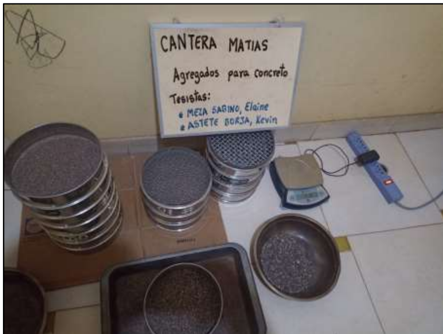
Figura 7 Agregado fino. Ensayo de granulometría.
