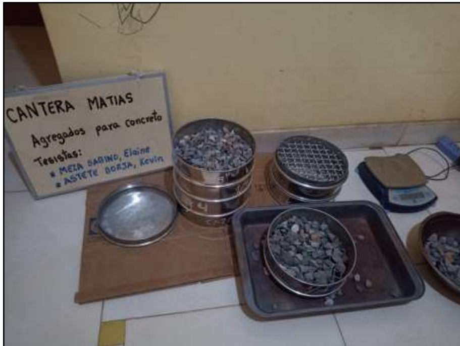
Figura 7 Agregado fino. Ensayo de granulometría.
