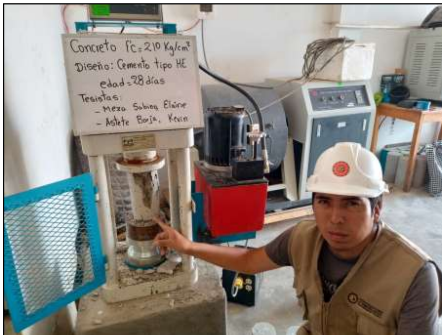
Figura 44 Resistencia a compresión. Cemex tipo HE. Edad=28d. a/c=0.57
