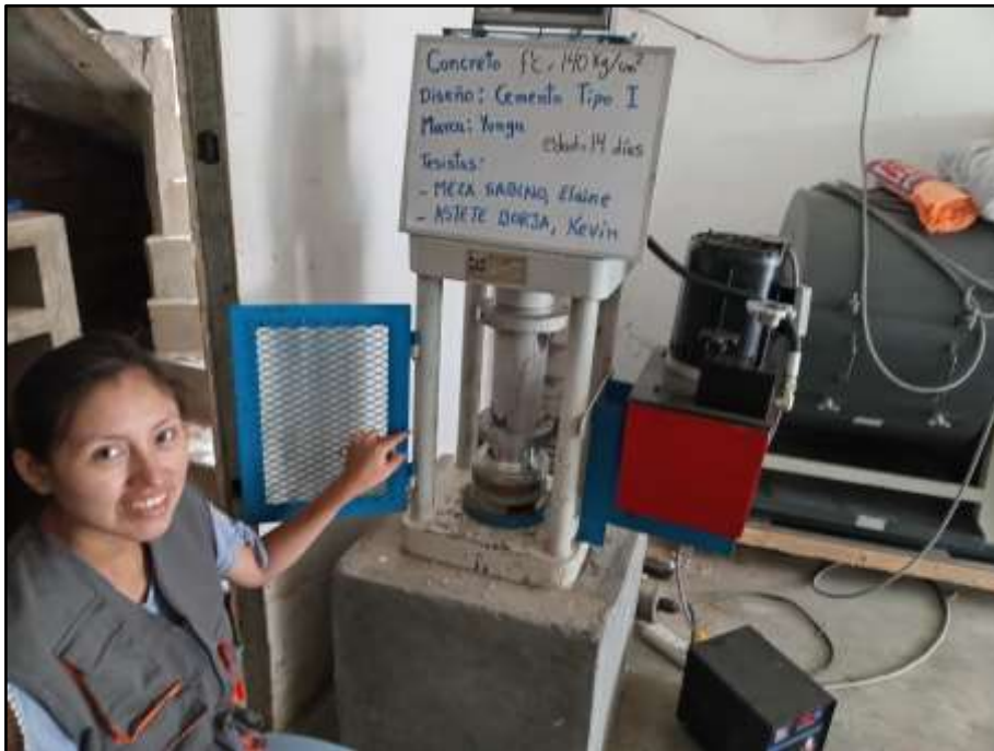
Figura 32 Resistencia a compresión. Yunga tipo I. Edad=14d. a/c=0.57
