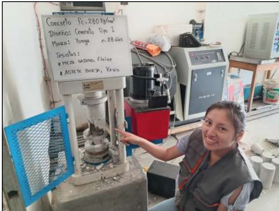
Figura 42 Resistencia a compresión. Yunga tipo I. Edad=28d. a/c=0.40
