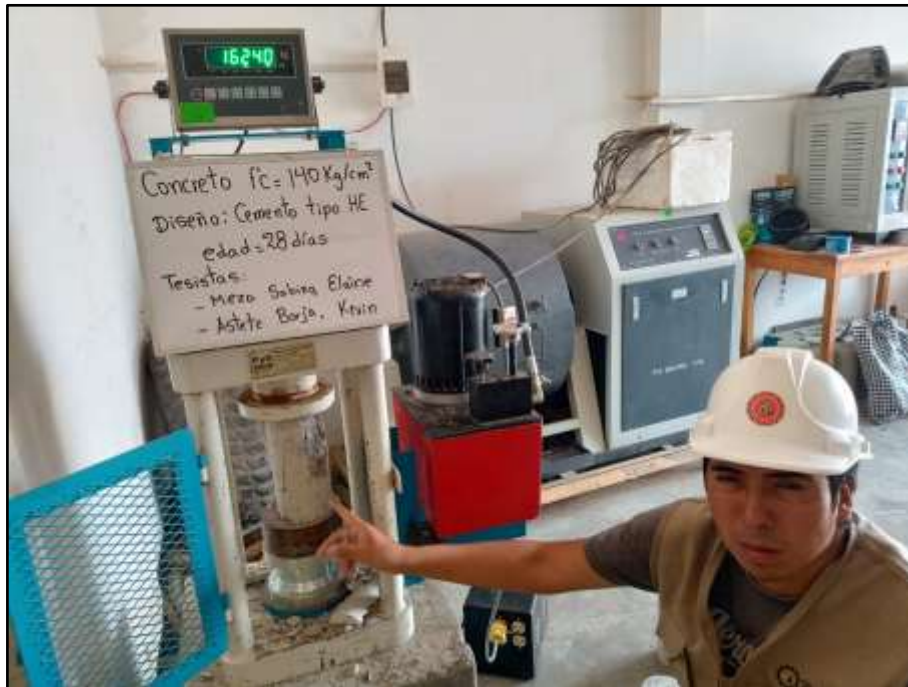
Figura 44 Resistencia a compresión. Cemex tipo HE. Edad=28d. a/c=0.57
