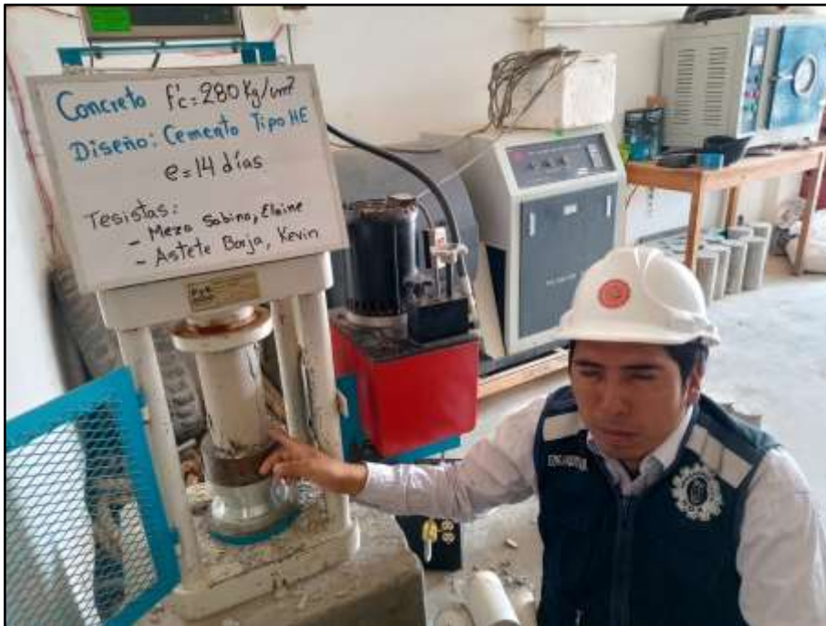
Figura 38 Resistencia a compresión. Cemex tipo HE. Edad=14d. a/c=0.40
