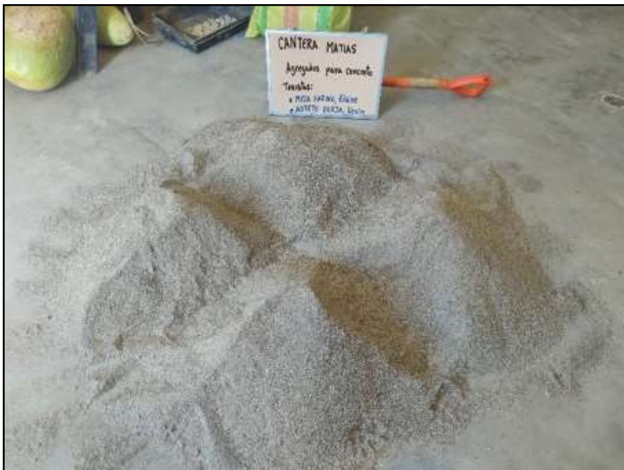
Figura 5 Cuarteo del agregado fino.
