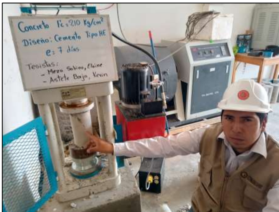
Figura 28 Resistencia a compresión. Cemex tipo HE. Edad=7d. a/c=0.57
