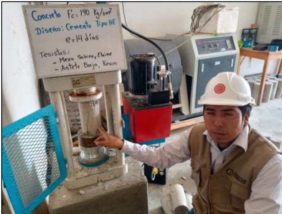
Figura 36 Resistencia a compresión. Cemex tipo HE. Edad=14d. a/c=0.57
