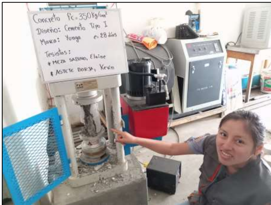
Figura 42 Resistencia a compresión. Yunga tipo I. Edad=28d. a/c=0.40
