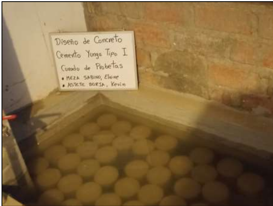
Figura 22 Curación de probetas hechas con cemento Cemex tipo HE.
