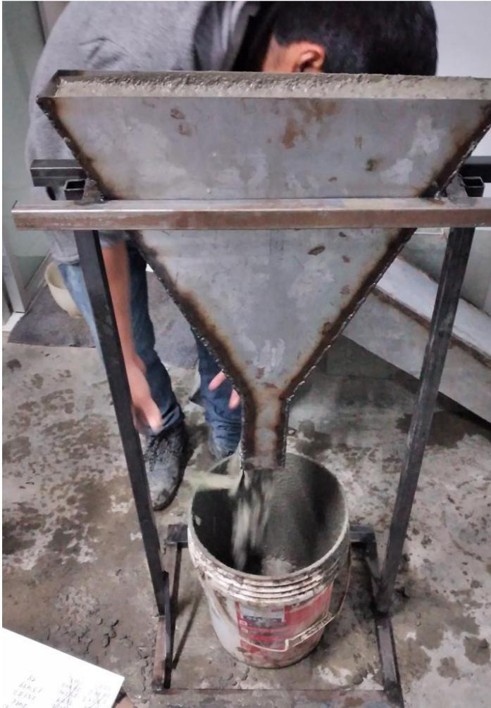
\*\*\* Embudo en V a T5 min, es la diferencia del tiempo de descarga del embudo V luego de haber recientemente y el embudo en V llenado y dejado reposar por 5 minutos.
