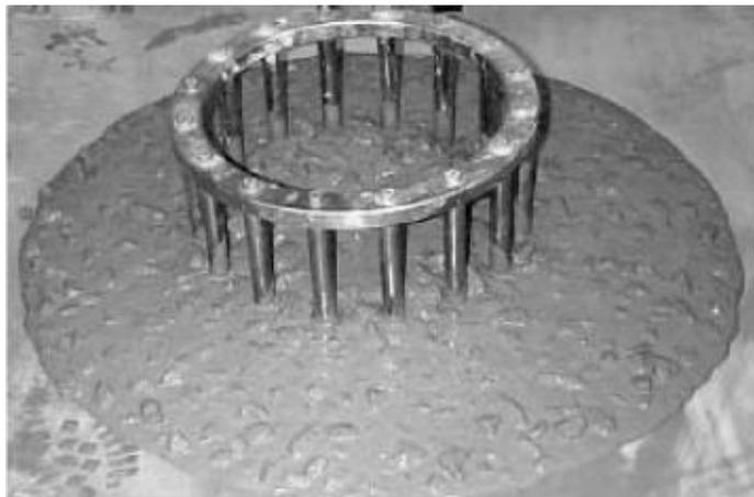
\*\* Es la diferencia del diámetro promedio medido en el flujo de asentamiento y el flujo de asentamiento utilizando el anillo J.
