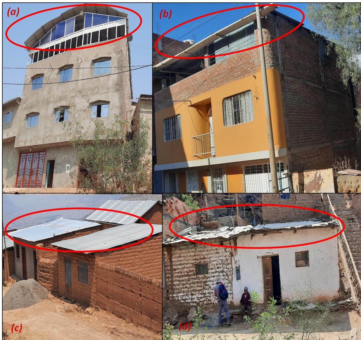
*Nota.* (a) Cubierta curvo de Aluzinc en viviendas de concreto armado. (b) cubierta plana de material liviano en viviendas de albañilería. (c, d) Cubierta plana de calamina en viviendas de adobe.
