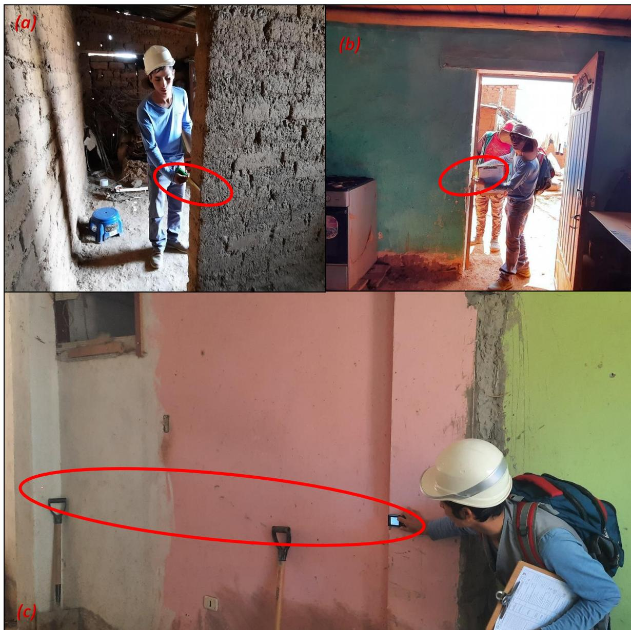
*Nota.* (a, b) Espesores de 20 y 40 cm en muros de adobe. (c) Distancia de 4.00 m entre columnas de concreto armado
