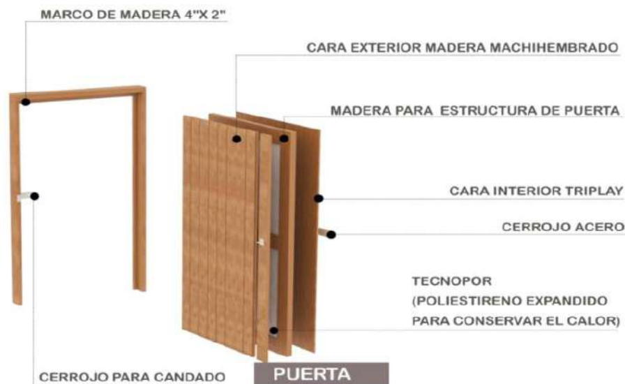
Figura 82. Diseño de la puerta de la Sumaq Wasi región Sierra
