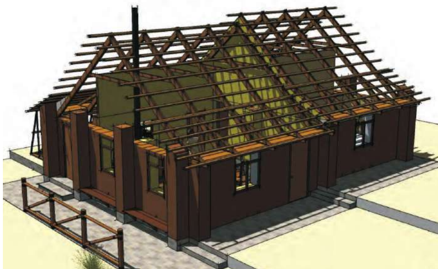
Figura 75. Estructura de la cubierta de la Casa Ecológica Andina
