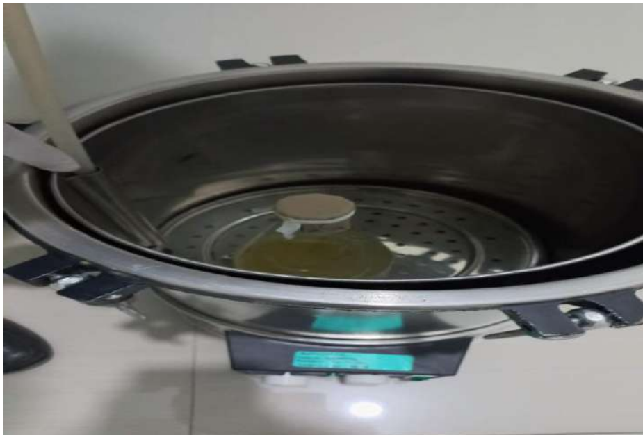
Fotografía 16 Llevamos a la autoclave el medio de cultivo agar base por 30 minutos a 15 libras de presión y a 121 °C para la esterilización húmeda.
