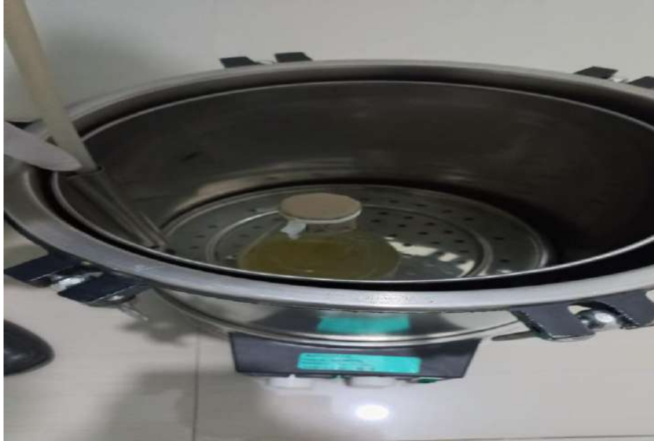
Fotografía 42 Llevamos a la autoclave el medio de cultivo agar base por 30 minutos a 15 libras de presión y a 121 °C para la esterilización húmeda.
