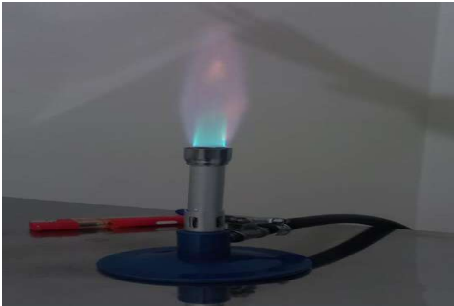
Fotografía 38 Prendemos el mechero de Bunsen para crear una barrera, evitando contaminar el medio de cultivo y el técnico.
