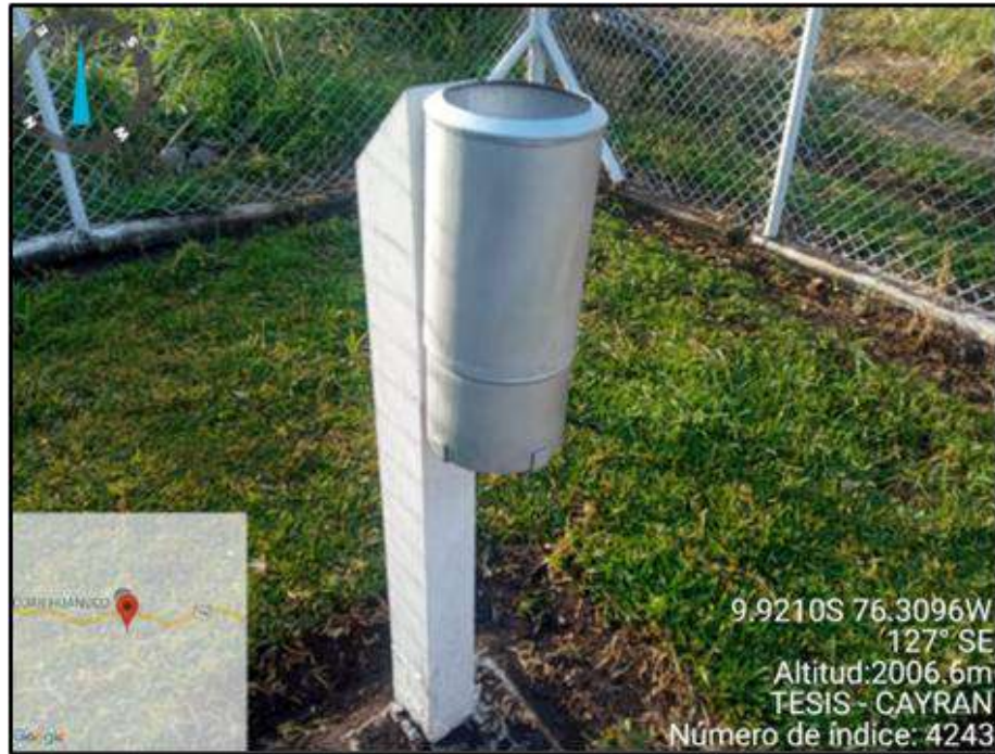
Ilustración 102: La estación de Canchan cuenta con un PLUVIÓMETRO, el cual mide la Cantidad de lluvia en mm.
