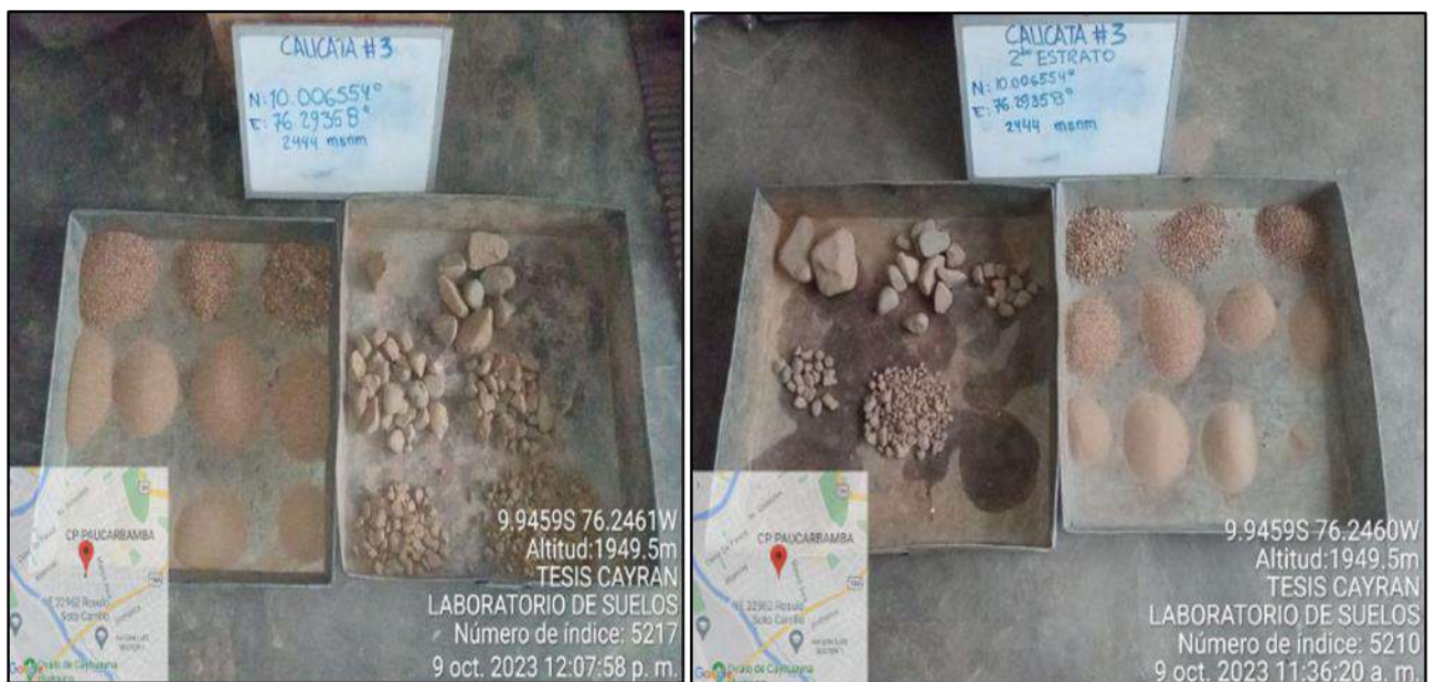
Ilustración 142: MUESTRAS CALICATA 03: En el Laboratorio de Suelos "LA PIRAMIDE" ensayo de Granulometría (Tamiz) siendo Supervisado por el Ing. Paul Shader Abal Haro.
