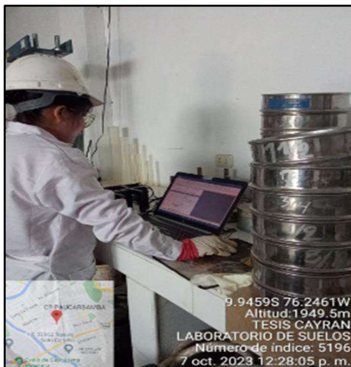
Ilustración 138: En el Laboratorio de Suelos “LA PIRAMIDE” ensayo de Granulometría (Tamiz) siendo Supervisado por el Ing. Paul Shader Abal Haro. Procesamiento de los valores obtenidos durante el ensayo.
