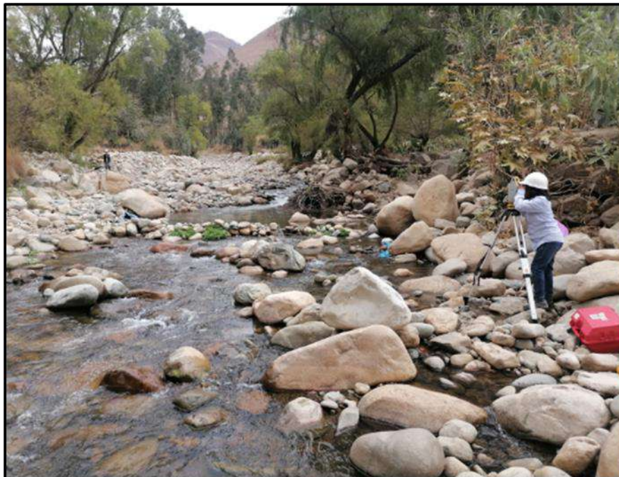
Ilustración 45: Levantamiento topográfico del río con estación total
