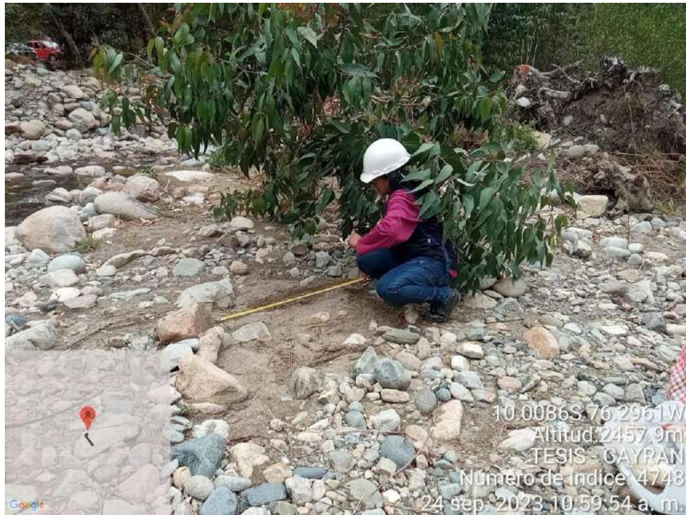
Ilustración 35: Medición de 80cm * 80cm de las calicatas.
