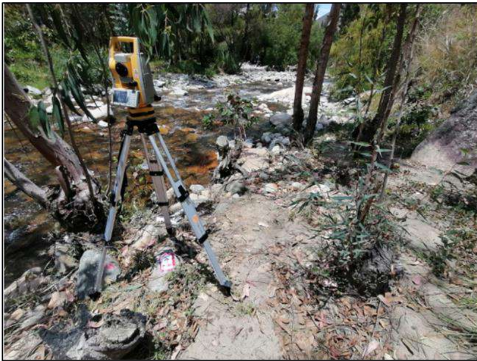
Ilustración 18: Trazo de la Poligonal con los puntos de Control
