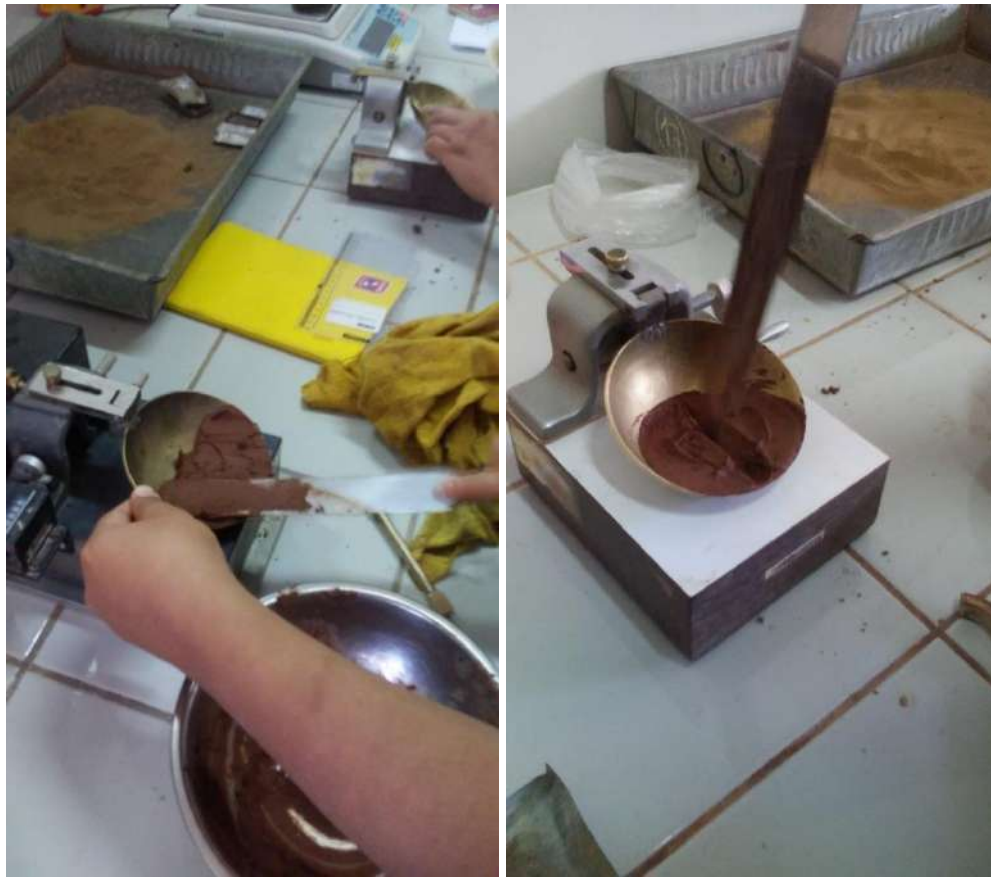
Ilustración 42: En la foto se muestra parte del proceso de Límite Líquido con la copa de Casagrande.
