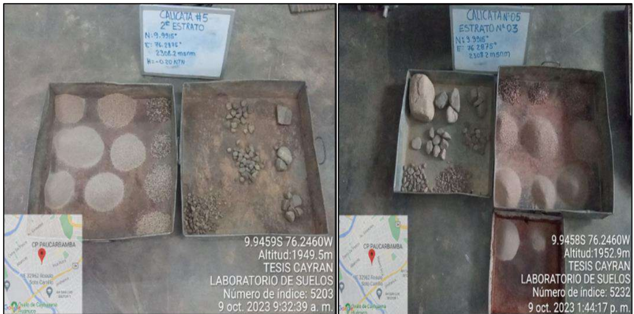
Ilustración 144: MUESTRAS CALICATA 05: En el Laboratorio de Suelos “LA PIRAMIDE” ensayo de Granulometría (Tamiz) siendo Supervisado por el Ing. Paul Shader Abal Haro.
