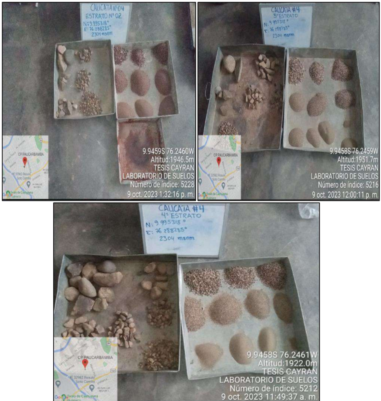
Ilustración 143: MUESTRAS CALICATA 04: En el Laboratorio de Suelos "LA PIRAMIDE" ensayo de Granulometría (Tamiz) siendo Supervisado por el Ing. Paul Shader Abal Haro.
