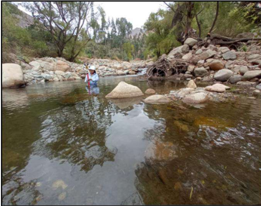
Ilustración 123: Batimetría en el fondo del río, medimos el fondo de río para el modelado.
