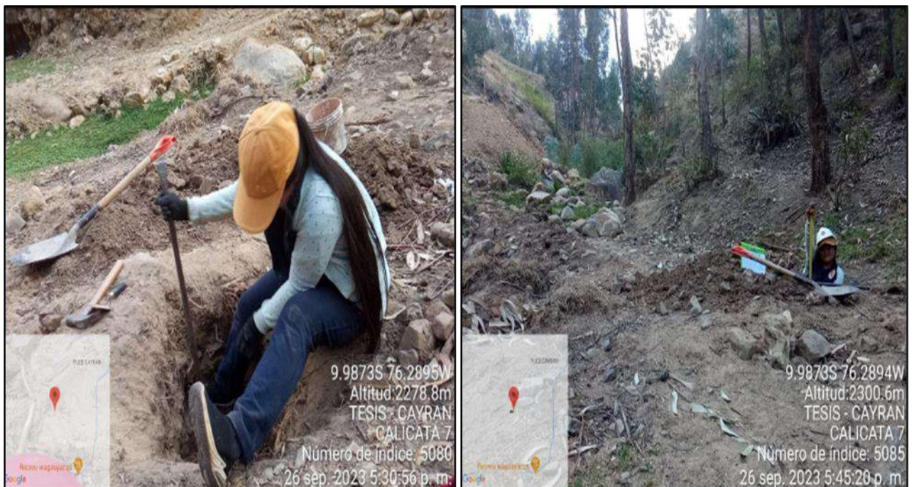
Ilustración 132: Calicata N° 7 LA QUEBRADA – Profundidad: 1.40mts. – No Se encontró Nivel Freático – Nos permitirá ver los diferentes estratos para nuestro estudio Granulométrico y poder determinar nuestro Nivel de Riesgo por Detritos.
