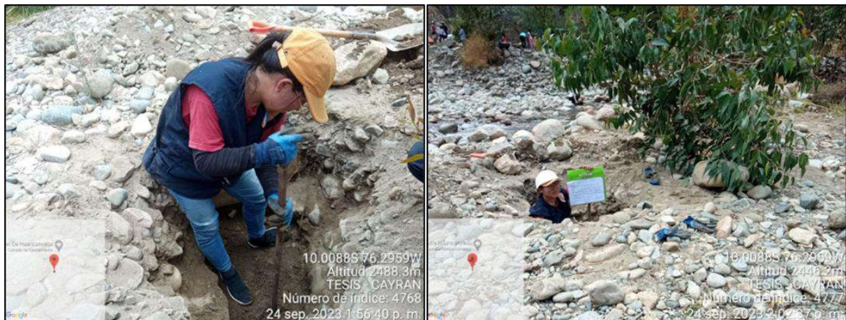
Ilustración 126: Calicata N°1 FAJA MARGINAL DEL RÍO DEL C.P. HUANCANYACU– Profundidad: 1.10mts. – Se encontró Nivel Fredático – Nos permitirá ver los diferentes estratos para nuestro estudio Granulométrico y poder determinar nuestro Nivel de Riesgo por Detritos.
