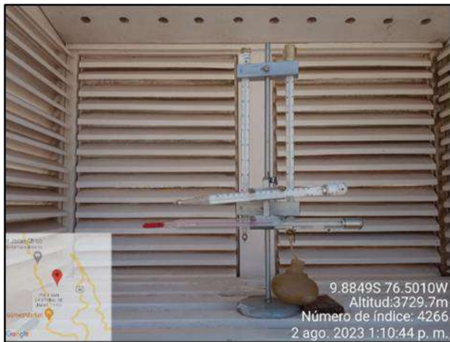
Ilustración 95: En la imagen se muestra la CASETA METEOROLÓGICO, el cual protege de la Luz Solar y viento a los termómetros que miden T° Max. y Min.
