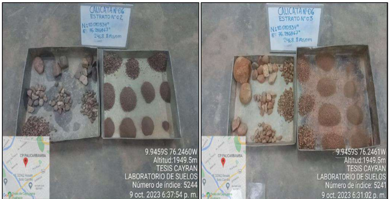
Ilustración 145: MUESTRAS CALICATA 06: En el Laboratorio de Suelos “LA PIRAMIDE” ensayo de Granulometría (Tamiz) siendo Supervisado por el Ing. Paul Shader Abal Haro.
