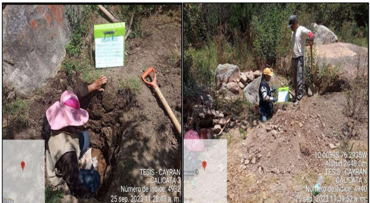
Ilustración 128: Calicata N° 3 QUEBRADA HUANCAN– Profundidad: 0.94mts. – No Se encontró Nivel Freático – Nos permitirá ver los diferentes estratos para nuestro estudio Granulométrico y poder determinar nuestro Nivel de Riesgo por Detritos.
