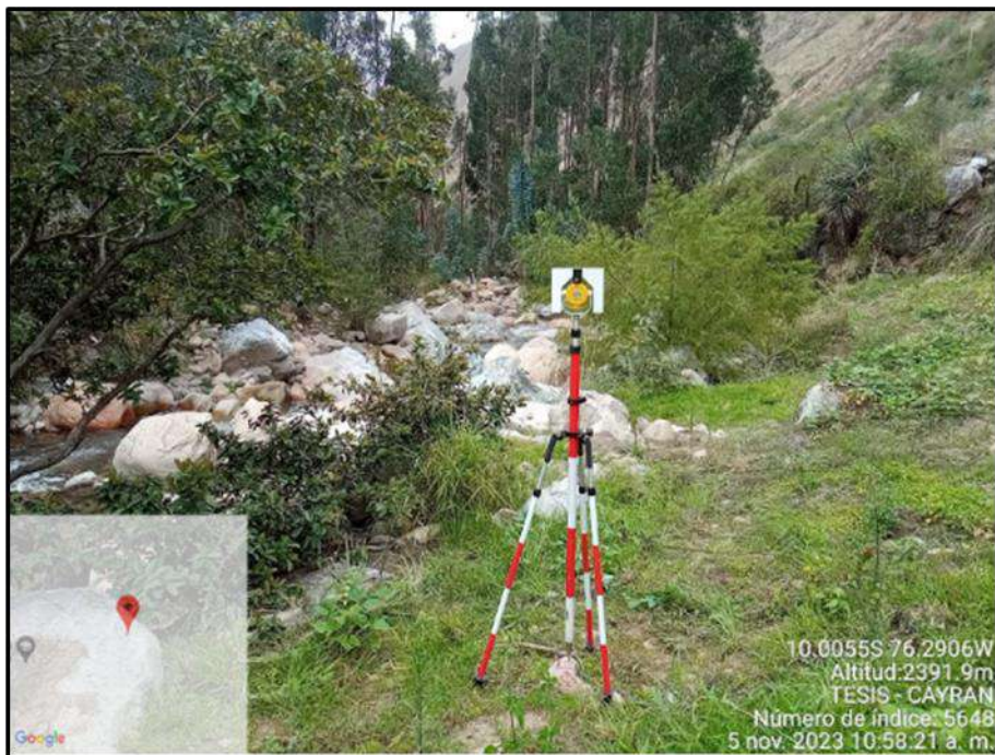
Ilustración 112: El Prisma estacionado con el tri pie, en un Punto de Control – el Tri pie nos facilita para poder tomar los puntos más rápidos y precisos.
