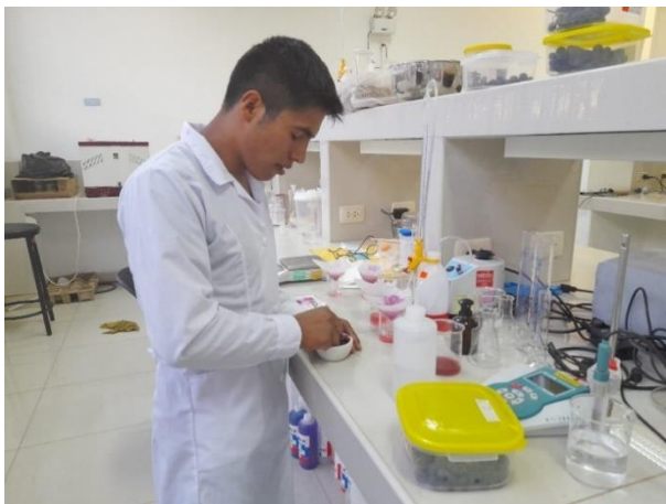
Anexo 41. Aplicación de fenolftaleína en 50 ml de muestra para la titulación.
