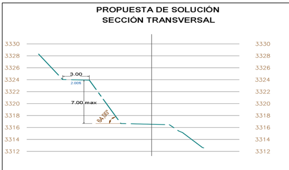
Figura 277 Sección transversal más representativa del tramo (2+865 – 3+45 km)
