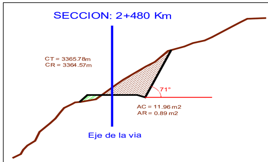
Figura 19 Secciones transversal más representativa del tramo (2+020 – 2+800 Km))
