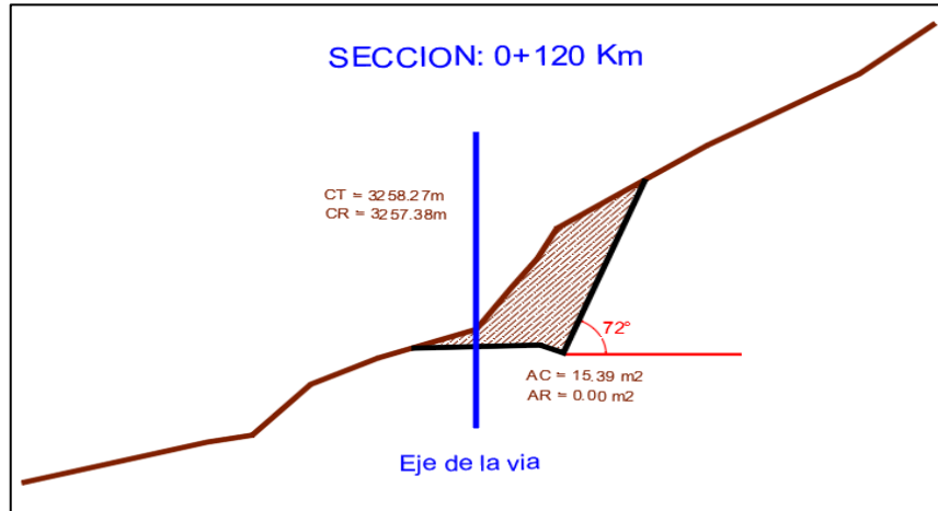
Figura 17 Secciones transversal más representativa del tramo (0+100 – 0+380 Km)
